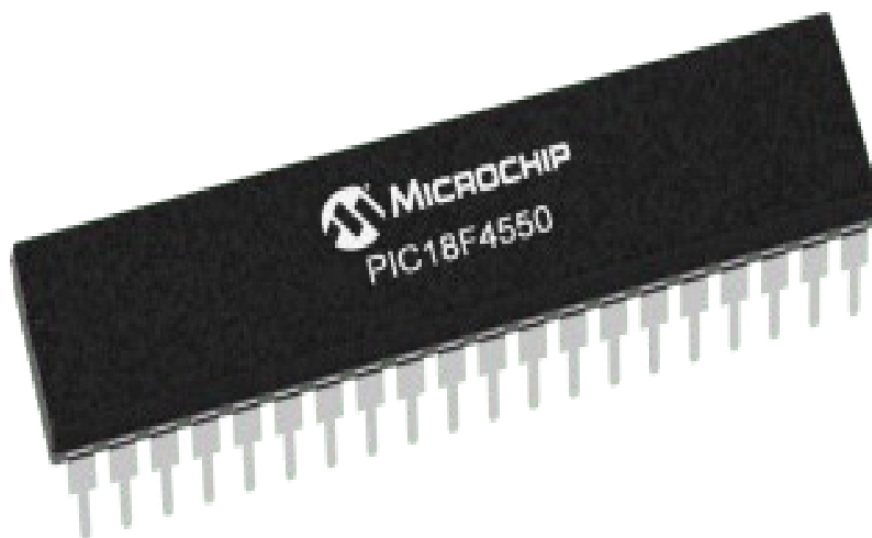
Εικόνα 8: Μικροελεγκτής PIC 18F44550 της Microchip[5]
