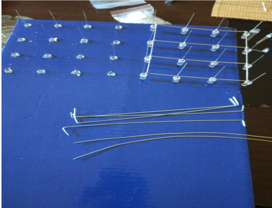
Εικόνα 23: Κατασκευή τεσσάρων επιπέδων κύβου
