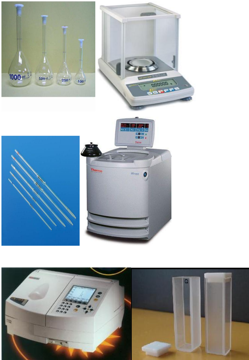
Σχήμα 4. Σχηματική απεικόνιση ογκομετρικών φιαλών, ζυγαριάς, σιφωνίων πλήρωσης, φυγοκέντρου, φασματοφωτομέτρου και κυψελίδων χαλαζία.
