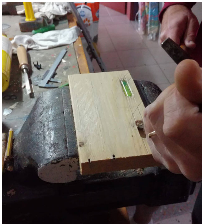
Σχήμα 3.4: Κατασκευή θέσης και τοποθέτηση αλφαδιών
