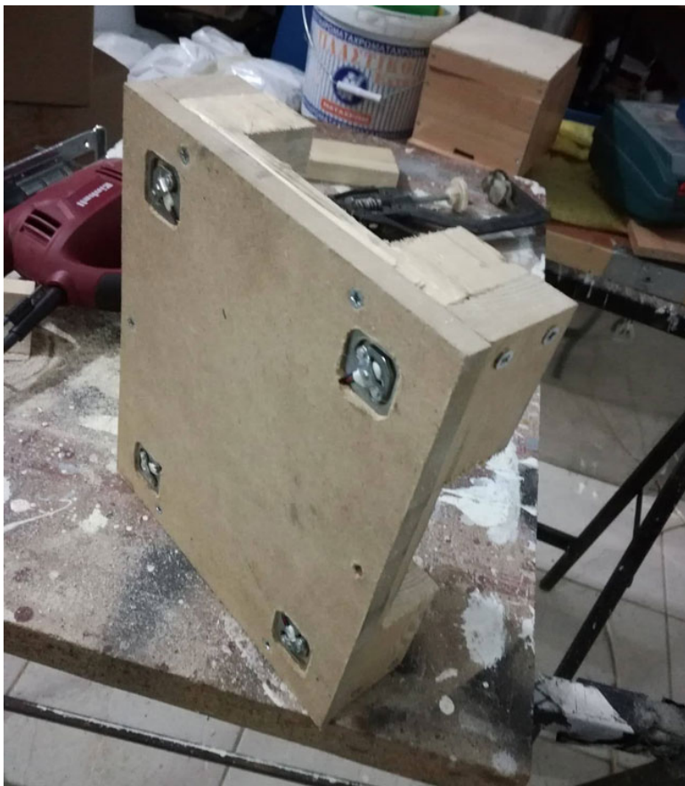
Σχήμα 3.6: Τροποποιημένη βάση για υποδοχή των αλφαδιών 1
