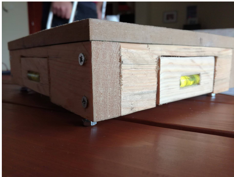
Σχήμα 3.9: Η βάση τροποποιημένη με αλφάδια και ρυθμιζόμενα πόδια 2
