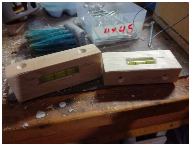
Σχήμα 3.5: Τα αλφάδια ολοκληρωμένα, πριν ενσωματωθούν στη βάση
