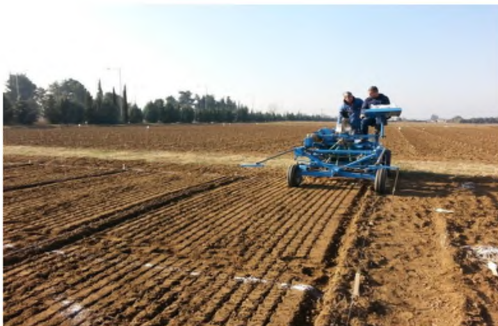
Εικόνα 2.2 Σπορά με αυτόματη σπαρτική μηχανή σιτηρών
