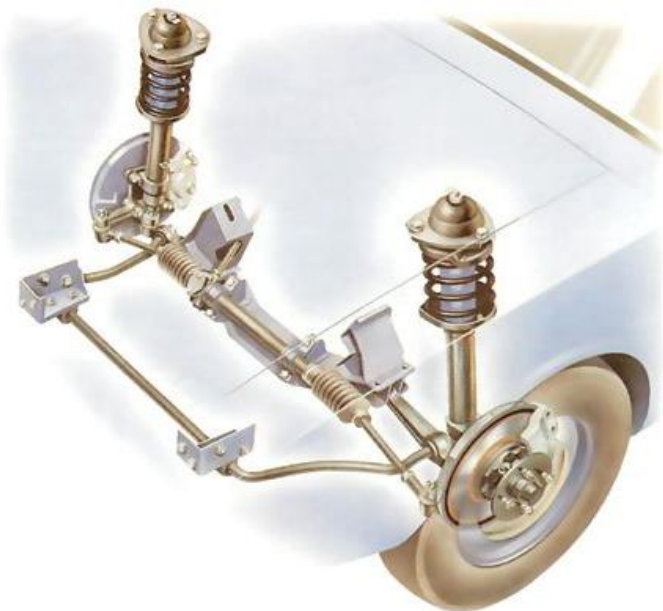
Εικόνα 3.5: Στρεπτική ράβδος τοποθετημένη στο σύστημα αναρτησης
