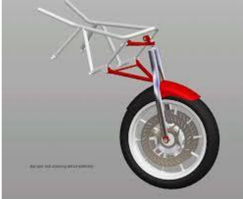
Εικόνα 4.6: Ανάρτηση Hossack για μοτοσυκλέτες
