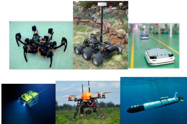
Εικόνα 14: βαδίζοντα ρομπότ, αυτόνομα έντροχα ρομπότ, AGVs, ROVs, εναέρια ρομπότ, AUVs
