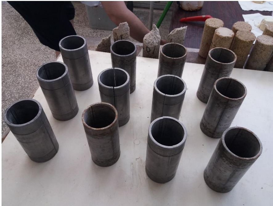
Σχήμα 5.1.1 Μεταλλικές ανοξείδωτες φόρμες. (Φωτογραφία απο το εργαστήριο Σκυροδέματος του τμήματος Π-Μ του Α.Τ.Ε.Ι.-Θ)
