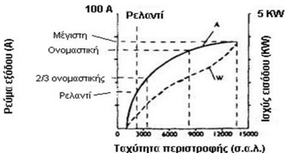
Διάγραμμα 4 - Χαρακτηριστικές καμπύλες εναλλακτήρα ρεύματος και ισχύος εξόδου [19]
