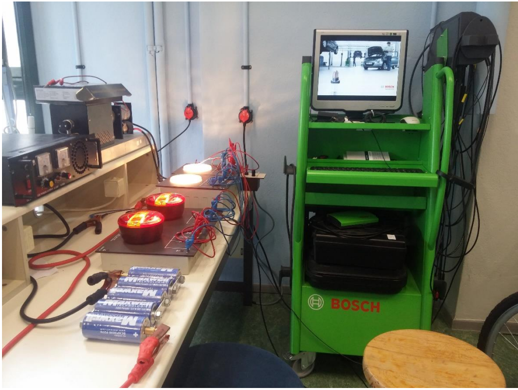
Εικόνα 57- Σύνδεση συστοιχίας υπερπυκνωτών με λαμπήρες
