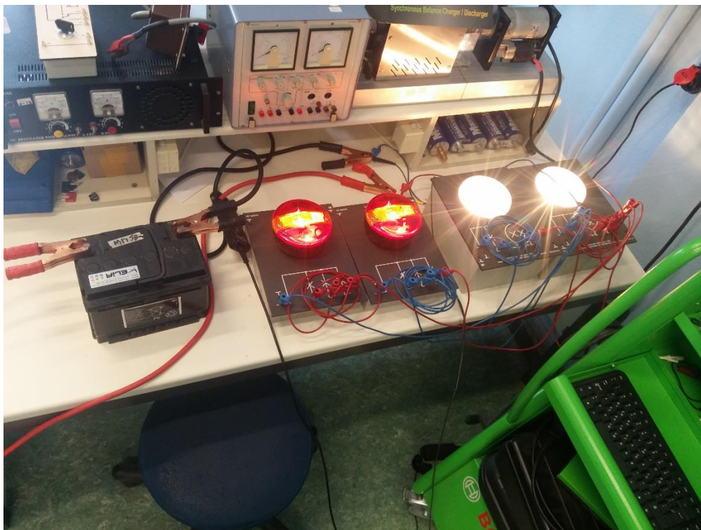
Εικόνα 58 - Σύνδεση συσσωρευτή με λαμπτήρες
