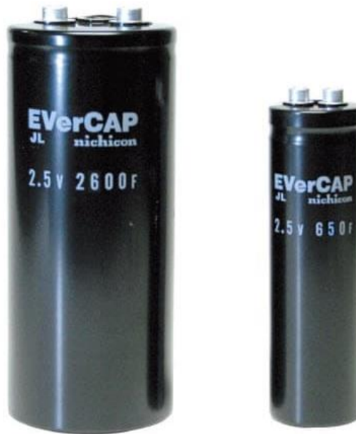
Εικόνα 34 – Υπερπυκνωτές κελιών αποθήκευσης ενέργειας κυλινδρικής γεωμετρίας [51]
