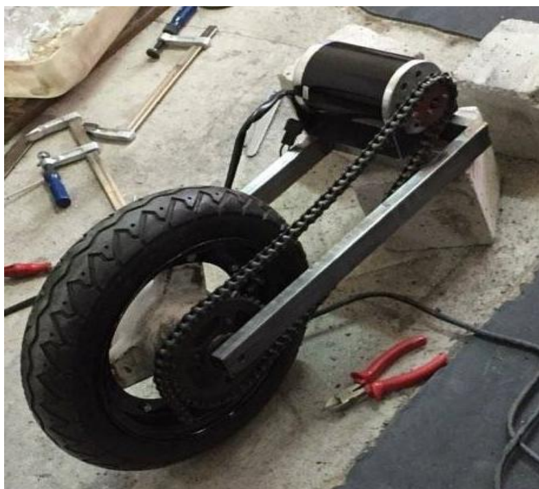
Εικόνα 66: Πρόωρη τοποθέτηση τροχού, κινητήρα και αλυσίδα πάνω στο ψαλίδι
