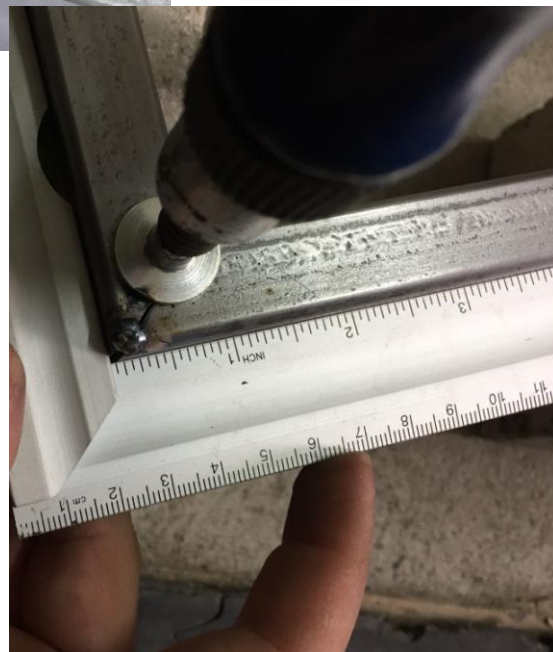
Εικόνα 64: Δημιουργία μικρών κολλήσεων για ευθυγράμμιση των μετάλλων
