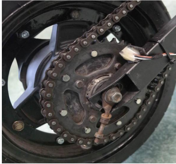
Εικόνα 85: Ο αισθητήρας hall και οι μόνιμοι μαγνήτες νεοδυμίου
