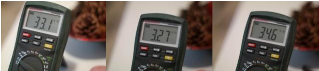
Εικόνα 78: α) μέτρηση αντίστασης R1 , β) μέτρηση αντίστασης R2 και γ) μέτρηση αντίστασης συνόλου R1 και R3 .
