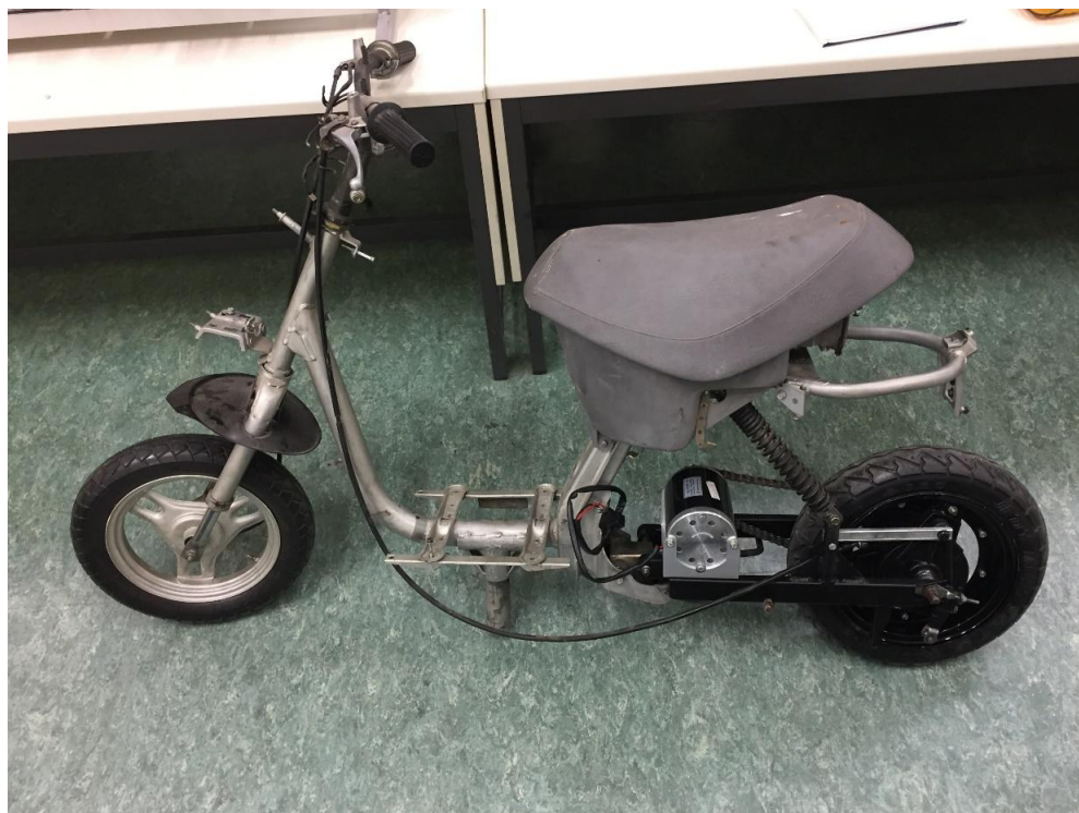
Εικόνα 74: Τοποθέτηση τροχού, ψαλιδιού και κινητήρα στο σκούτερ
