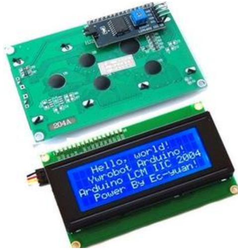
Εικόνα 87: Οθόνη 2004 20X4 με σειριακό διάλογο επικοινωνίας I2C.
