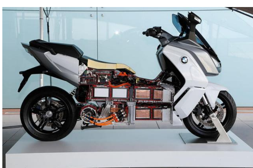
Εικόνα 22: BMW C evolution σε τομή δείχνοντας τα ηλεκτρικά του στοιχεία
