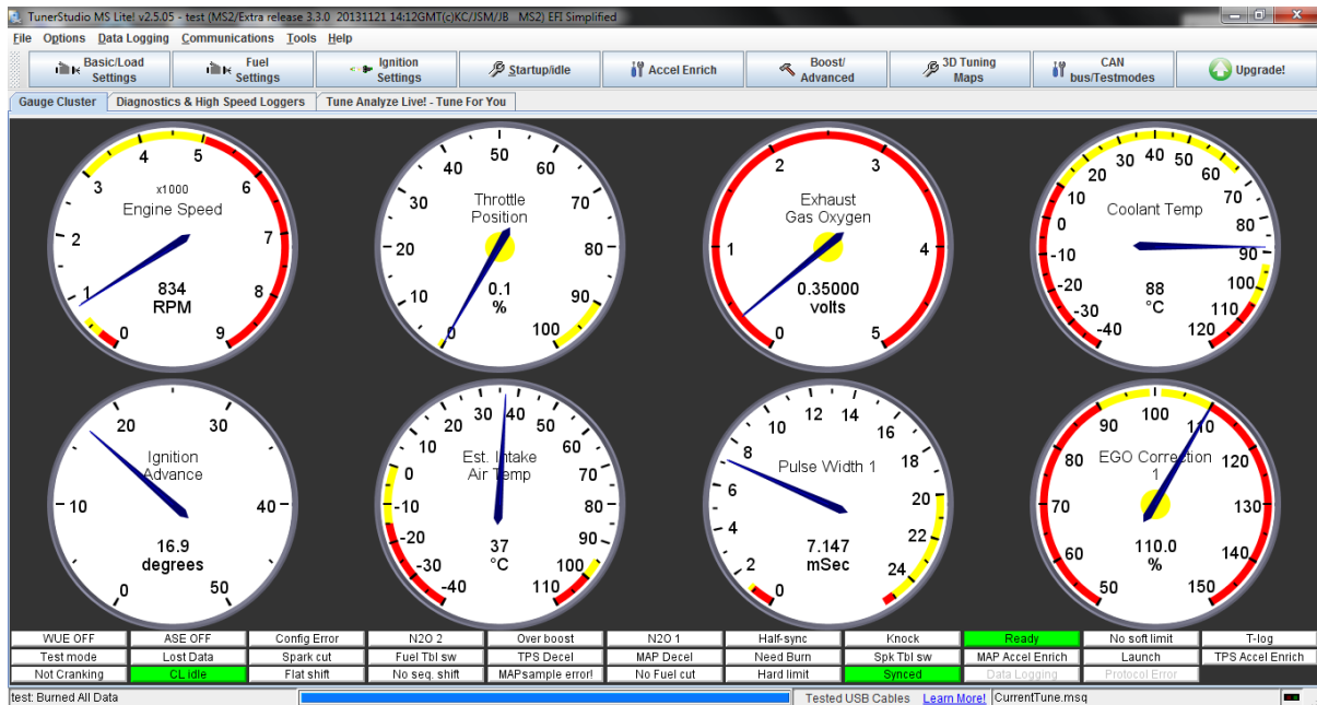
Εικόνα 4.19 Λειτουργία κλειστού βρόχου όταν το μίγμα είναι φτωχό.
