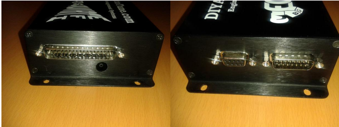
Εικόνα 2.1 Η θύρα DB37 (αριστερά) και οι θύρες DB9 (2η εικόνα αριστερά) και DB15 (2η εικόνα δεξιά).
