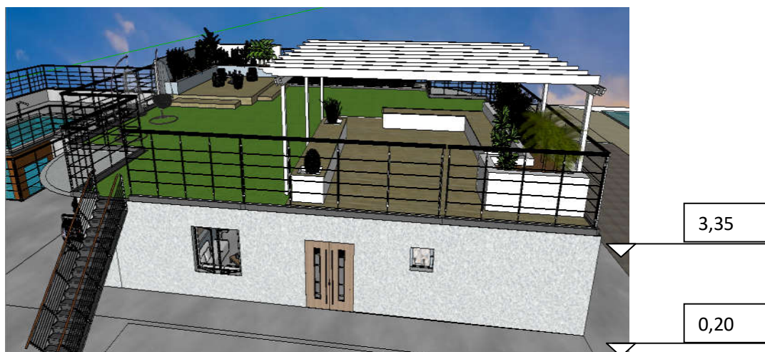
Εικόνα 2/ Στάθμες επιπέδων κτιρίου
