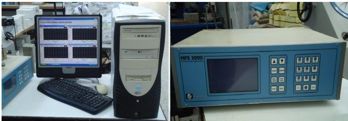
Εικ. 2.8. Ηλεκτρονικό καταγραφικό συνδεδεμένο με Η/Υ.
