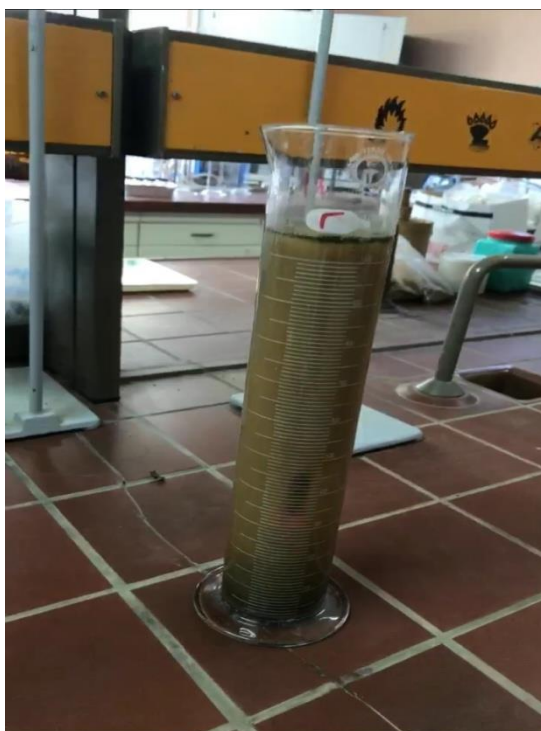
Εικόνα 8. Ογκομετρικός κύλινδρος μηχανικής ανάλυσης.
