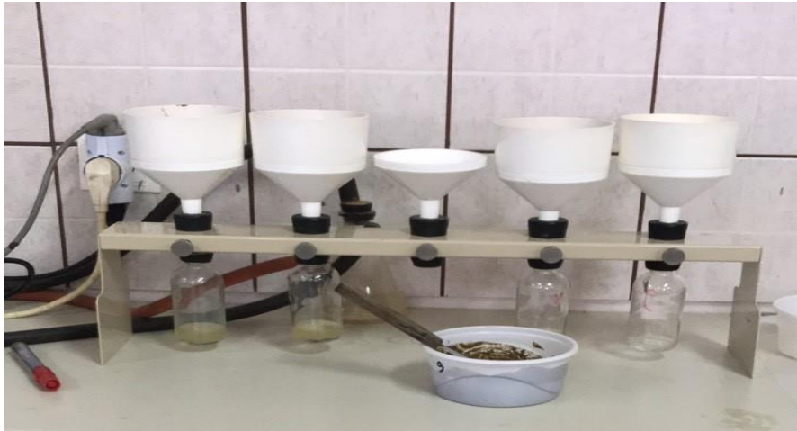
Εικόνα 10. Συσκευή εκχύλισης πάστας κορεσμού .
