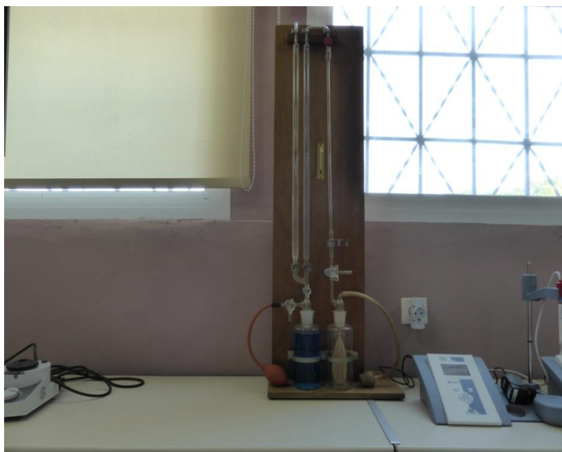
Εικόνα 9. Συσκευή μέτρησης ανθρακικού ασβεστίου.
