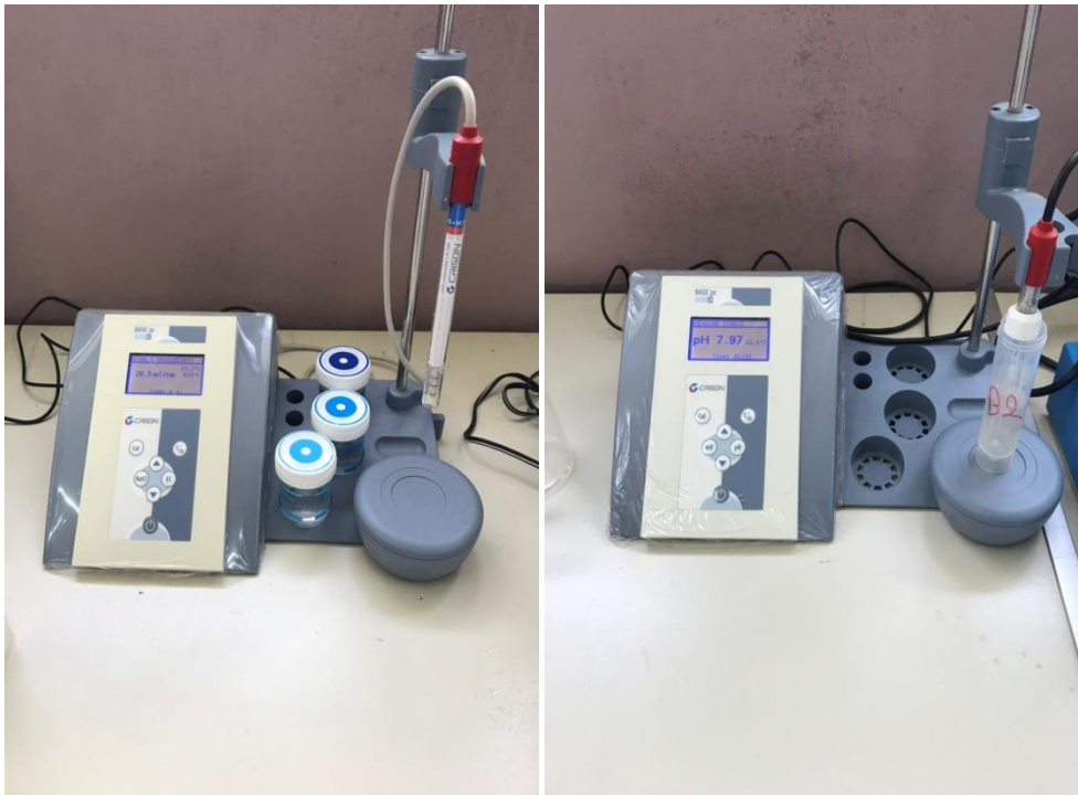
Εικόνα 11. Όργανο μέτρησης ηλεκτρικής αγωγιμότητας (αριστερά), και μέτρησης pH (δεξιά).
