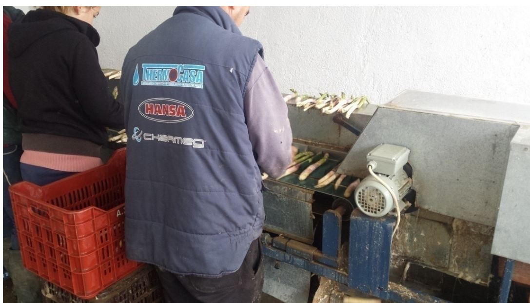
Εικόνα 28. Τοποθέτηση σπαραγγιού πριν την κοπή κατάλληλου μεγέθους (Πηγή Μ.Β.)
