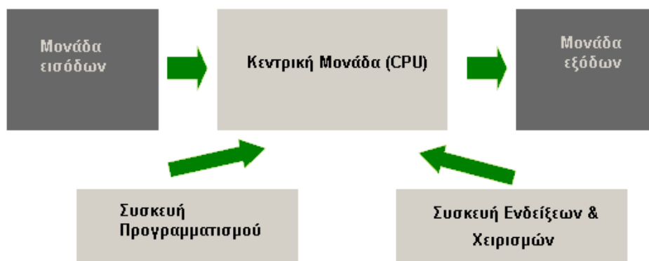
Εικόνα 1. Ροή πληροφορίας στην κεντρική μονάδα (CPU)
