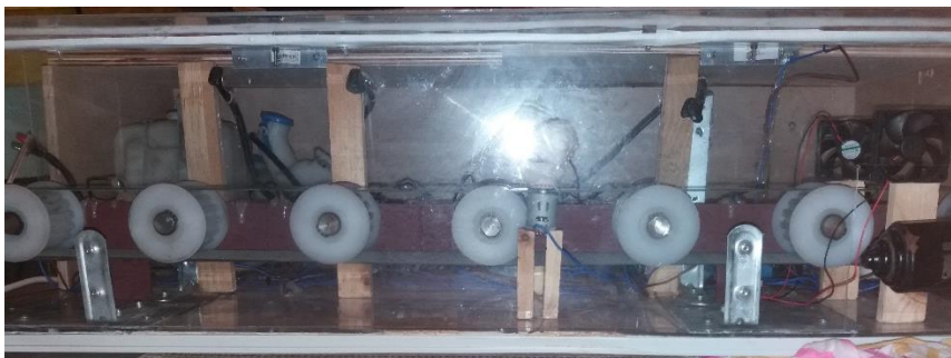
Εικόνα 45: Τοποθέτηση πλεξιγκλάς για το μπροστινό μέρος του τούνελ του πλυντηρίου
