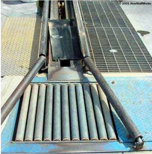
Εικόνα 2: Ο συσχετιστής και η αρχή του μάντα μεταφοράς [18]
