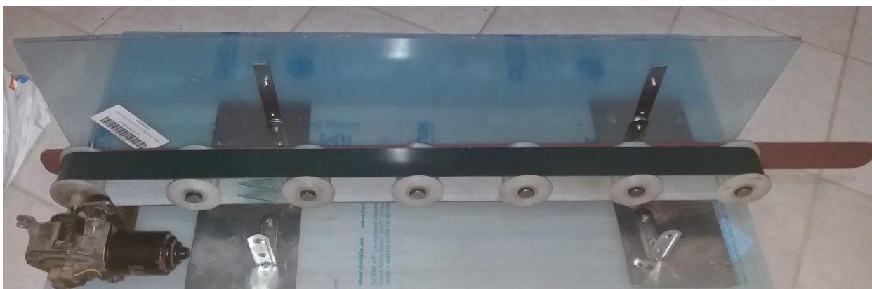
Εικόνα 25: Τοποθέτηση πλαστικών ράουλων, ιμάντα μεταφοράς, κινητήρα ιμάντα μεταφοράς, πλεξιγκλάς για τη βάση και το πίσω μέρος του τούνελ του πλυντηρίου και του ξύλο για τη βάση
