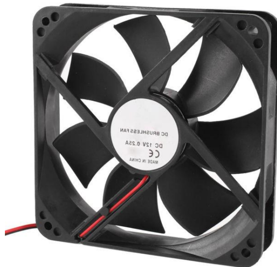
Εικόνα 24: Ανεμιστηράκι ηλεκτρονικού υπολογιστή [8]
