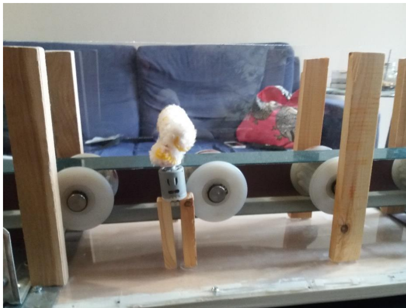
Εικόνα 27: Ξύλα στήριξης βουρτσών και πιτσιλιθρας νερού 2 και τοποθέτηση βουρτσών
