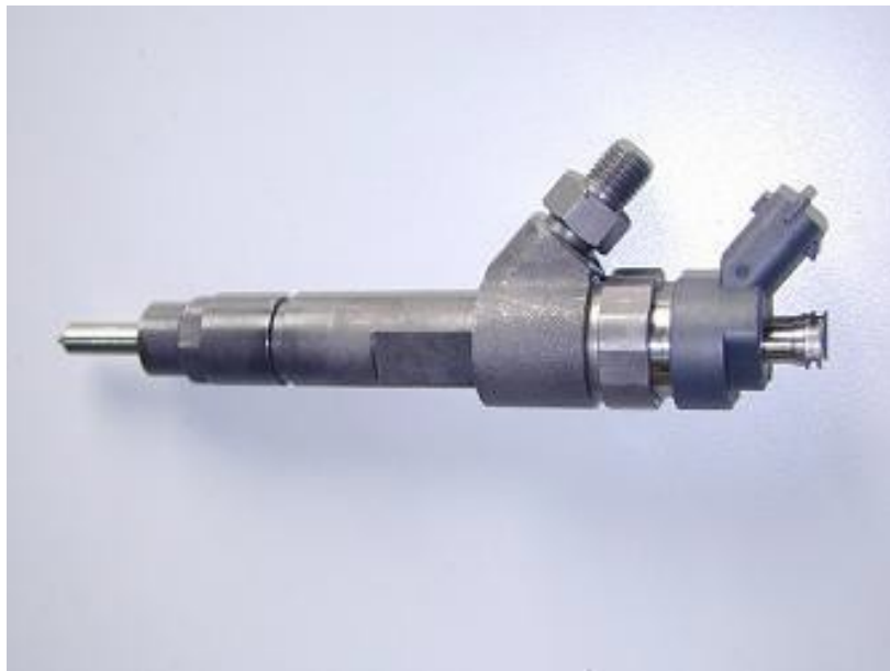
Εικόνα Ηλεκτρομαγνητικός εγχυτήρας κατάλληλος για εφαρμογές συστημάτων common rail CP1.
