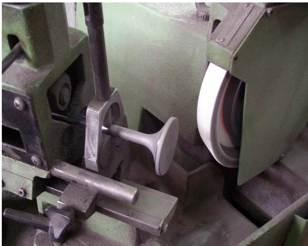
Εικ2.9.1.5: Παράδειγμα λείανσης βαλβίδων μιας μηχανής εσωτερικής καύσης [1].
