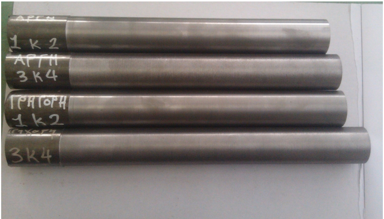
Εικ5.5: Αρχική μορφή δοκιμίων πριν την επεξεργασία της λείανσης.
