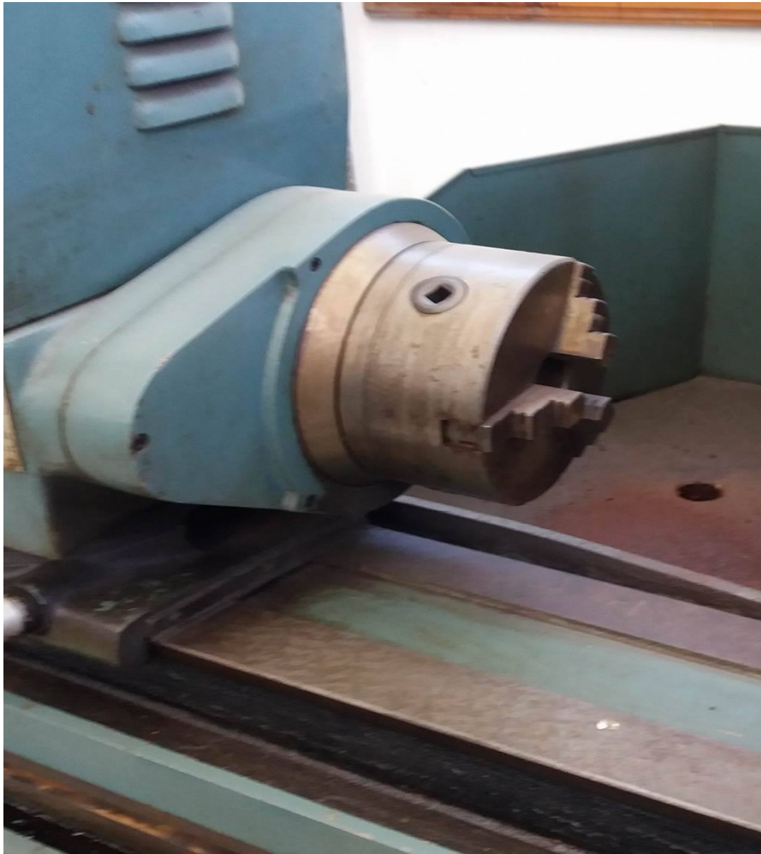
Εικ4.3.5: Απεικόνιση του τσόκ της λειαντικής μηχανής.
