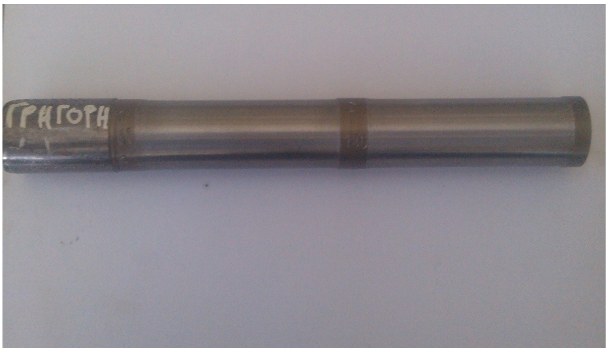
Εικ5.5.2: Τελική ποιότητα δοκιμίων πριν την διαδικασία της τραχυμέτρησης.
