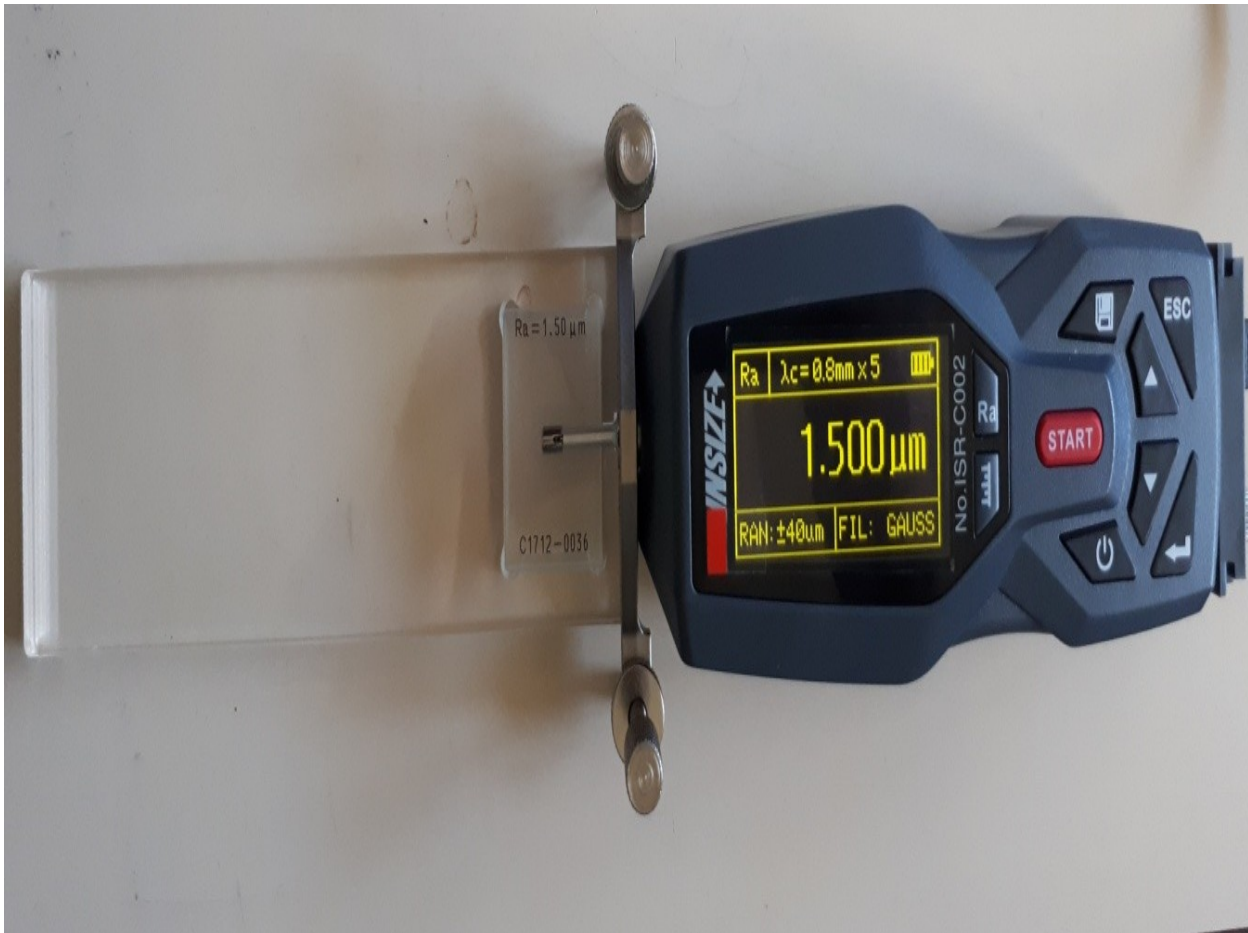
Εικ5.4.2: Η βαθμονόμηση του τραχυμέτρου πριν από τις μετρήσεις του πειράματος.
