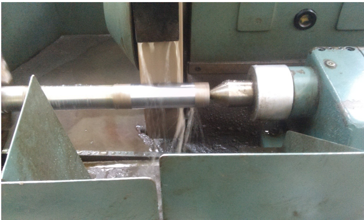
Εικ5.5.1: Απεικόνιση των δοκιμίων κατά την επεξεργασία στην εργαλειομηχανή λείανσης.
