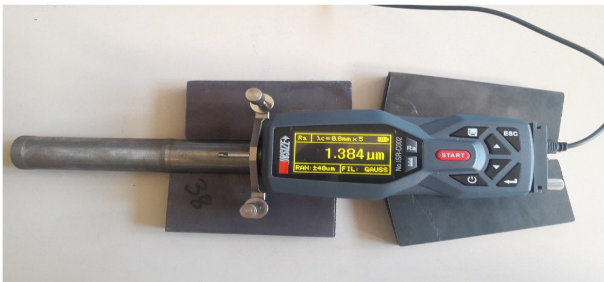
Εικ5.5.3: Ακριβής προσδιορισμός ποιότητας επιφάνειας μέσω του ταχύμετρου αργής ταχύτητας.
