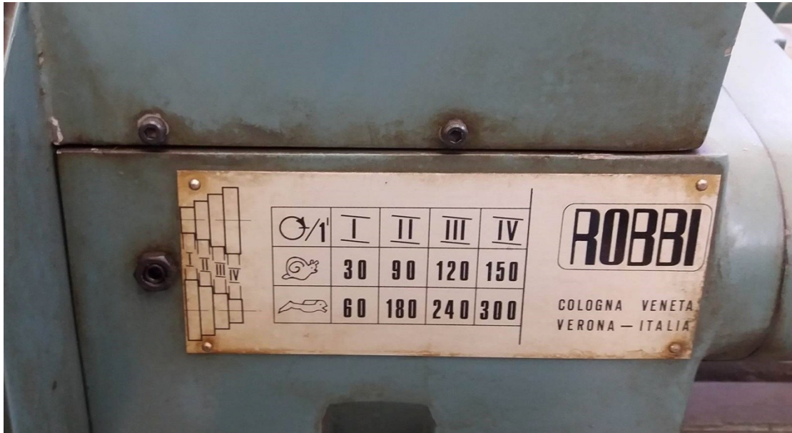
Εικ4.3.1: Απεικόνιση των τεσσάρων ταχυτήτων προς τις παραγόμενες στροφές την λειαντικής μηχανής.
