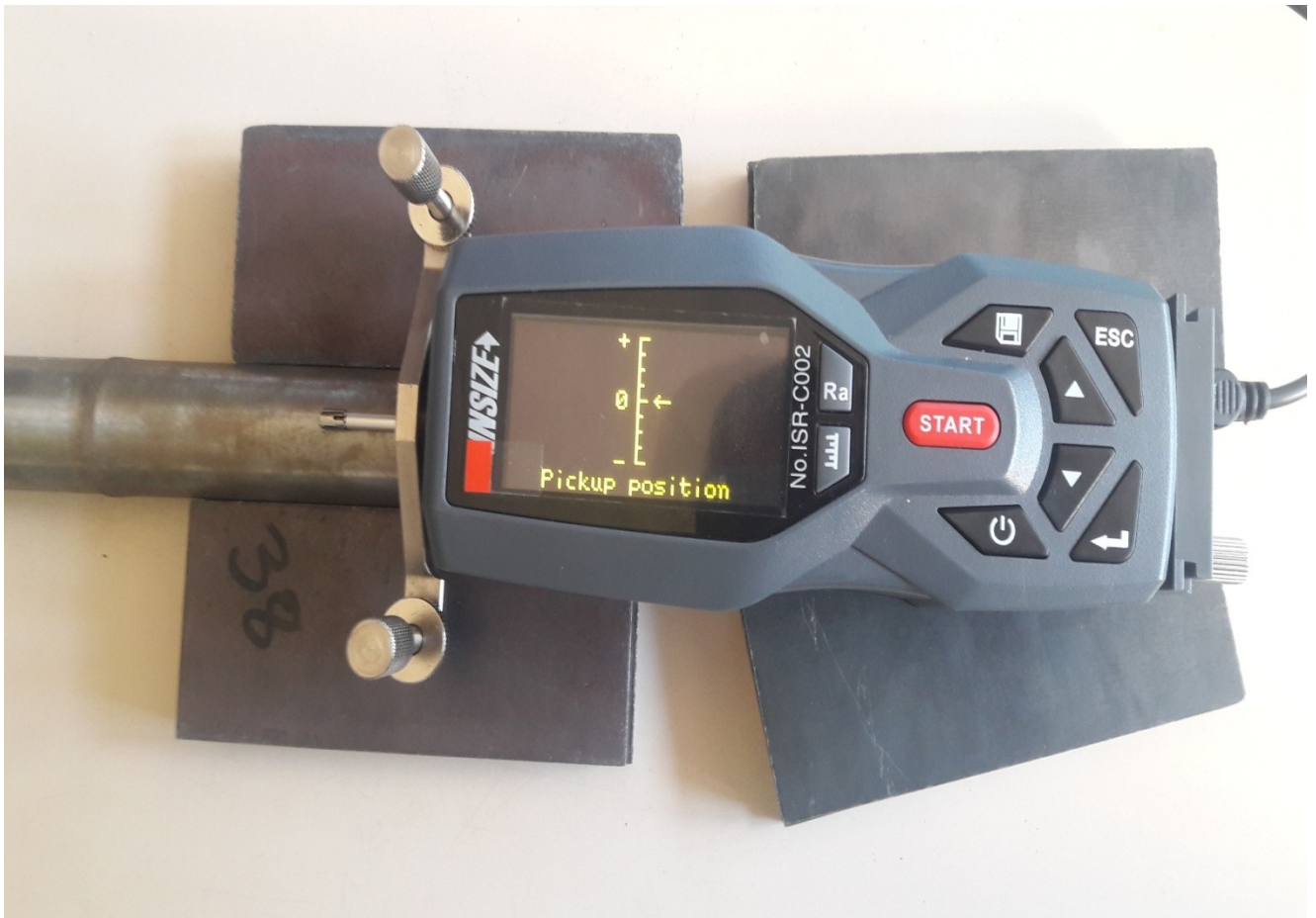
Εικ5.4.3: Απεικόνιση μηδενισμού της συσκευής του τραχυμέτρου πριν από τις μετρήσεις του πειράματος.
