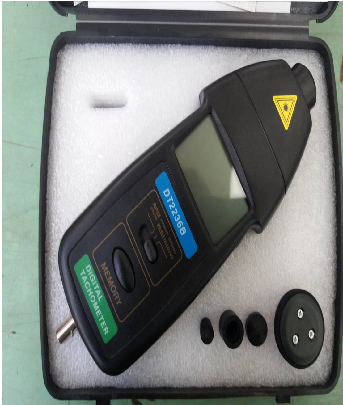
Εικ 4.3.2: Παρουσίαση του στροφόμετρου που χρησιμοποιήθηκε για την ακρίβεια των μετρήσεων.
