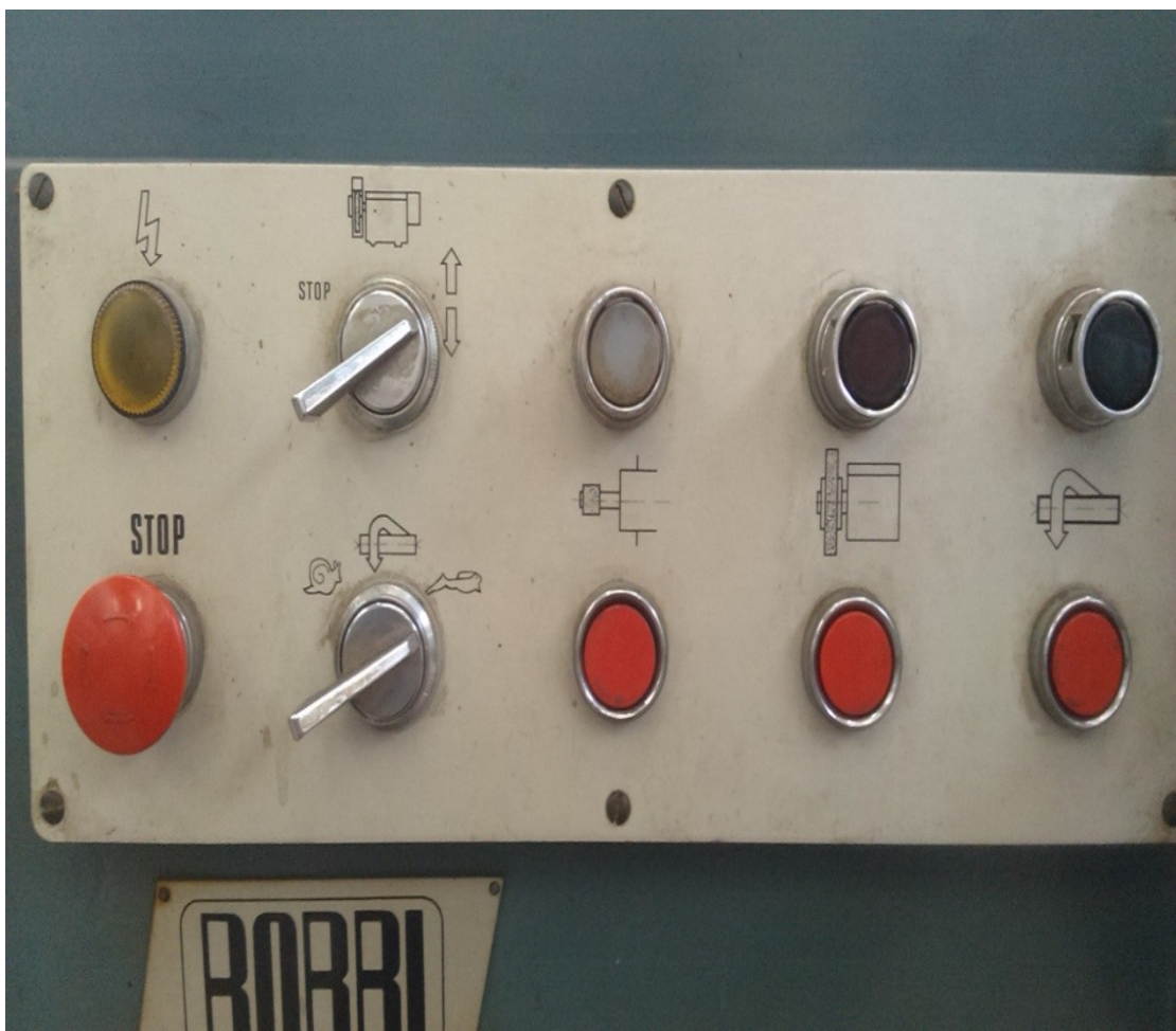
Εικ4.3.12: Πίνακας έλεγχου της λειαντικής μηχανής.
