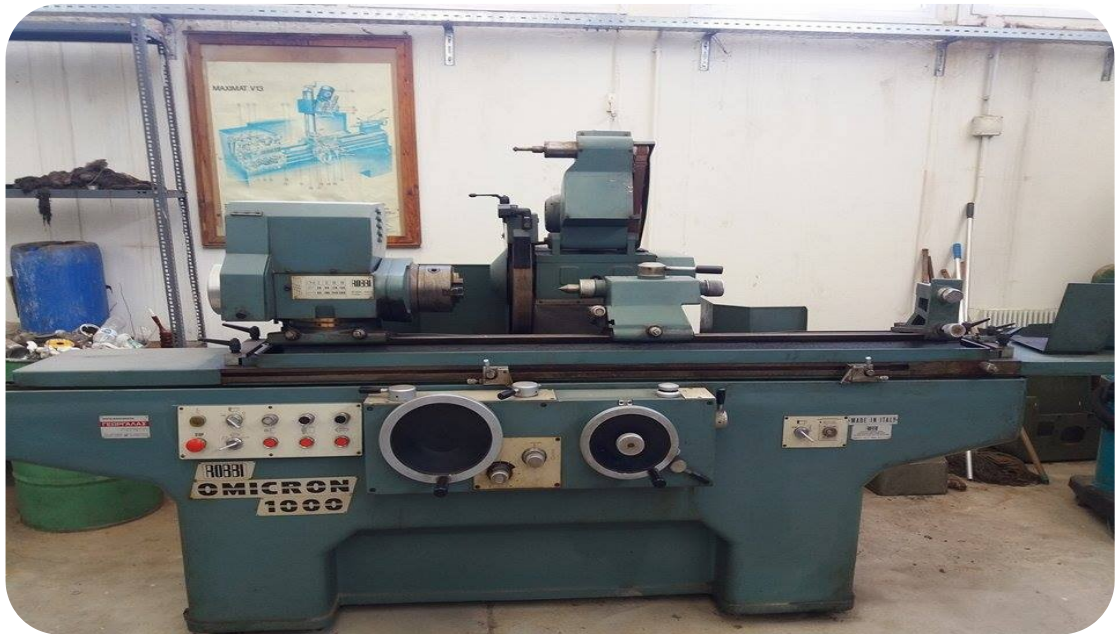
Εικ4.1: Απεικόνιση εργαλειομηχανής λείανσης
