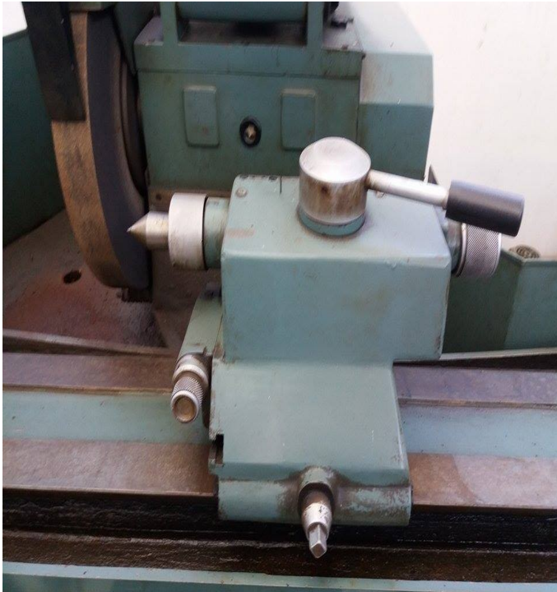
Εικ4.3.6: Κεντροφορέας λειαντικής μηχανής.
