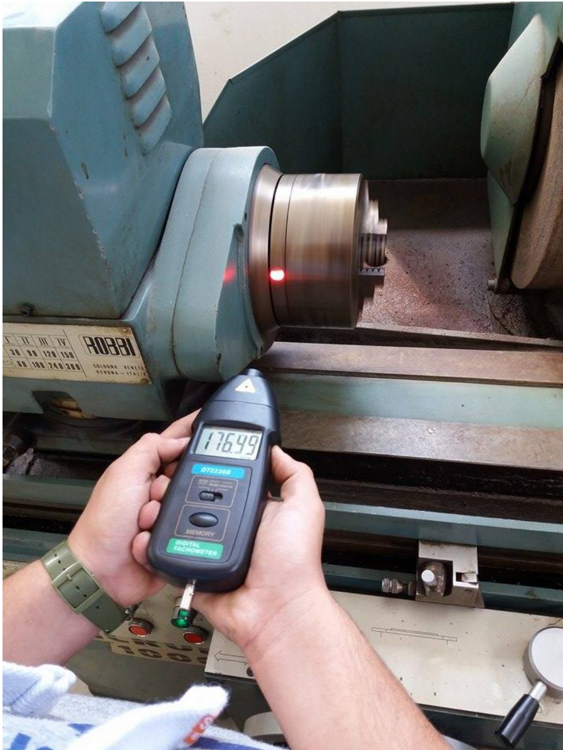
Εικ 4.3.3: Απεικόνιση πραγματικών μετρήσεων με την βοήθεια του στροφόμετρου.
