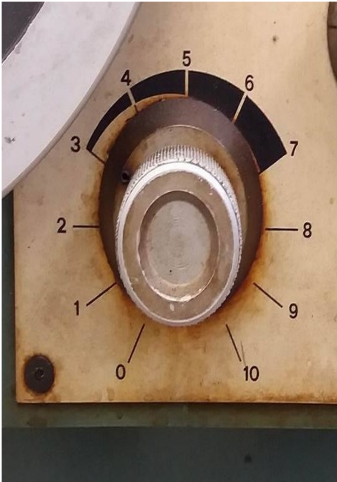
Εικ 4.3.9: Μοχλός πρόωσης της λειαντικής μηχανής σε mm/rev.
