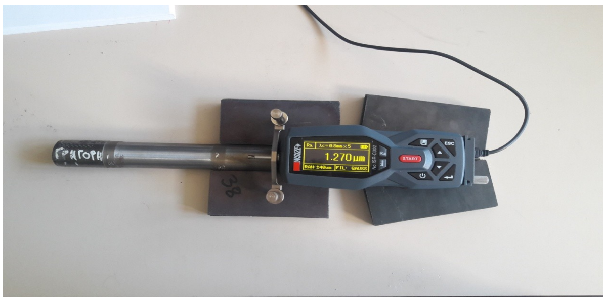
Εικ 5.5.4: : Ακριβής προσδιορισμός ποιότητας επιφάνειας μέσω του ταχύμετρου γρήγορης ταχύτητας.
