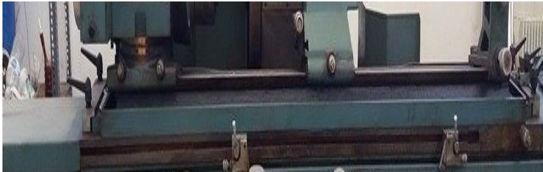
Εικ4.3.11: Η τράπεζα της λειαντικής μηχανής που εδράζονται όλα τα εξαρτήματα
