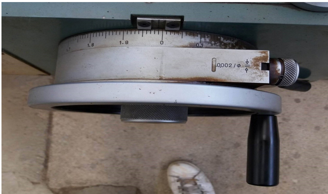
Εικ4.3.8: Ρολόι κίνησης λειαντικού τροχού με απεικόνιση το μεγαλύτερο βάθος λείανσης σε μια κατεργασία.
