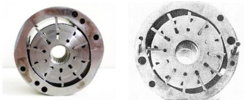
Σχ.5.1 Σχηματική παράσταση αντλίας με πτερύγια σταθερής παροχής.
