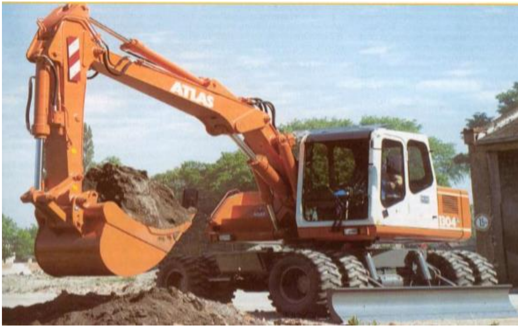
Σχ.1.15 Τροχοφόρος εκσκαφέας, ο στρεφόμενος φορέας στηρίζεται σε ειδικό πλαίσιο με ελαστικούς τροχούς.
