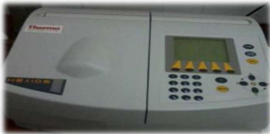
Εικόνα 9: Φασματοφωτόμετρο υπεριώδους- ορατού (UV-Vis) της εταιρείας Thermo, μοντέλο Helios
