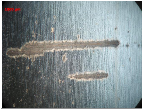
Σχήμα 47. Διάβρωση στην περιοχή πλάγιου τοιχώματος λόγω προηγούμενης ατέλειας στην επιφάνεια
