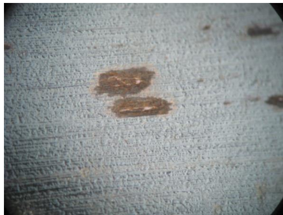
Σχήμα 46. Διάβρωση στην περιοχή πλάγιου τοιχώματος
