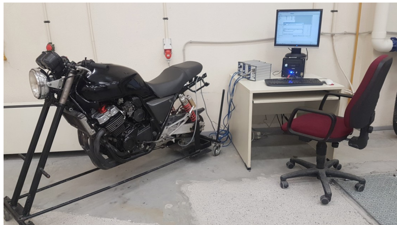
Σχήμα 5.1: Πειραματική διάταξη μέτρησης ροπής
