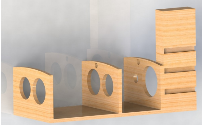
Σχ.5.10.1 Κατεργασία του κελύφους του κιβωτίου για τη δημιουργία των αυλάκων.
