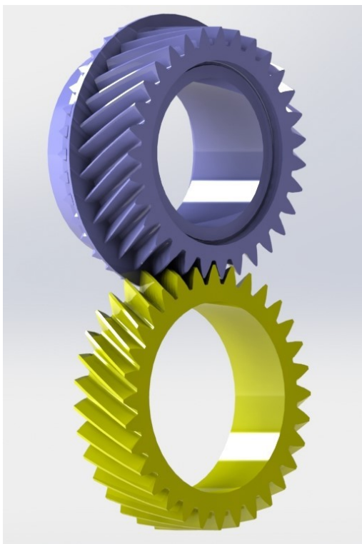
Σχ.5.7.4 Παράσταση του τρίτου ζεύγους σύμπλεξης του κιβωτίου μετάδοσης κίνησης.
