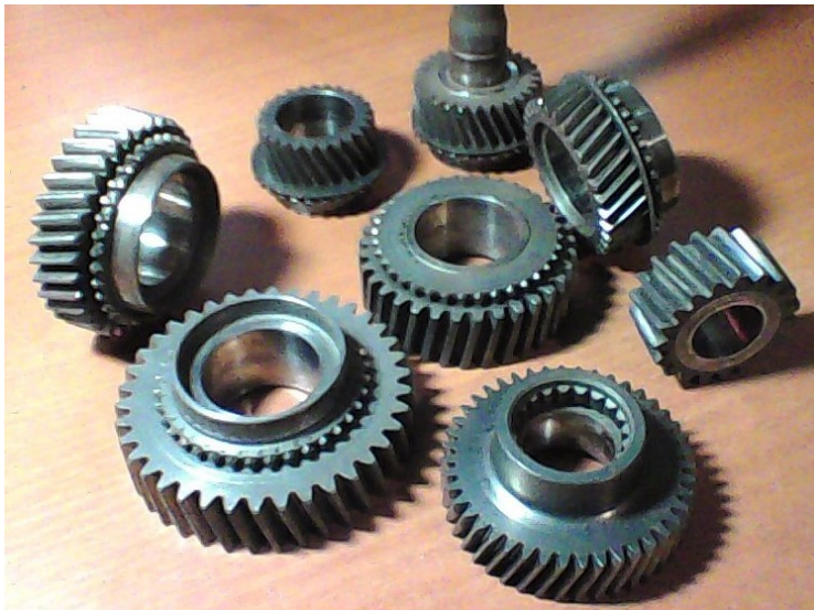
Σχ.4.4.1 Απεικόνιση των οδοντωτών τροχών του κιβωτίου μετάδοσης κίνησης.
