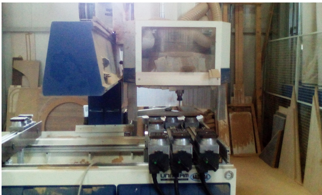
Σχ.5.8.2 Το αυτόματο μηχάνημα κοπής ξύλου (CNC) που χρησιμοποιήθηκε για την διαμόρφωση των τεμαχίων του κελύφους.
