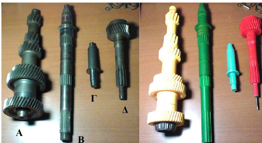
Σχ.4.3.1 Άξονες και άτρακτοι του κιβωτίου μετάδοσης κίνησης αριστερά και οι αντίστοιχοι εκτυπωμένοι δεξιά. Α) ενδιάμεση άτρακτος. Β) άτρακτος εξόδου. Γ) άξονας έδρασης οδοντωτού τροχού. Δ) άτρακτος εισόδου.
