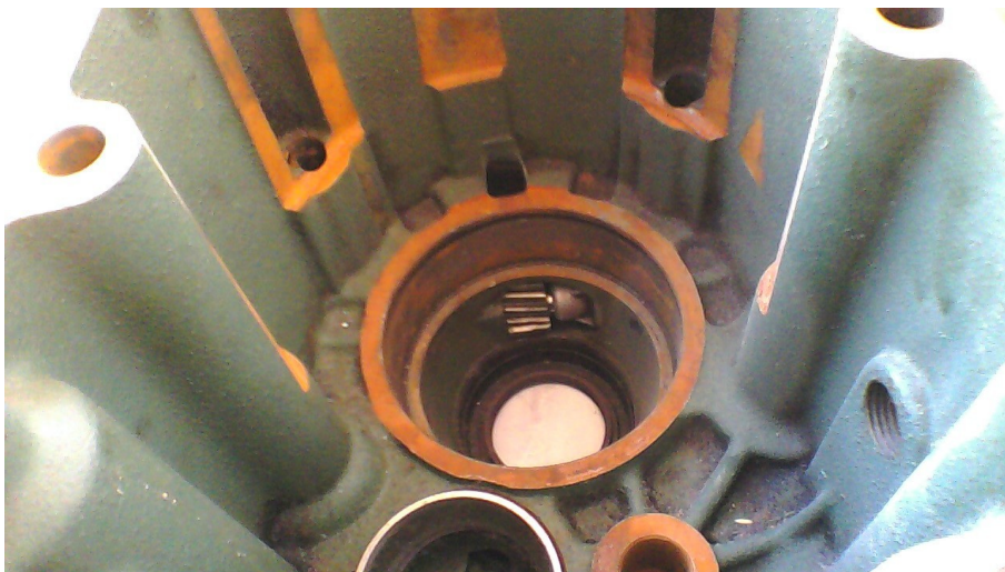
Σχ.4.2.2 Απεικόνιση της θέσης έδρασης του οδοντωτού τροχού μέτρησης στροφών.
