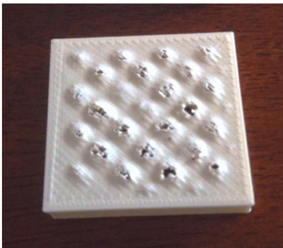
Σχ.3.9.1 Επιφανειακές ασυνέχειες στο επάνω μέρος του αντικειμένου (Pillowing).
