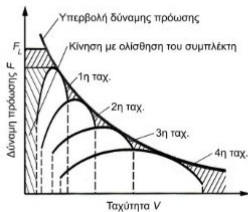
Σχ.2.3.1 Διάγραμμα κλιμάκωσης σχέσεων μετάδοσης συγκριτικά με την υπερβολή της δύναμης πρόωσης.
