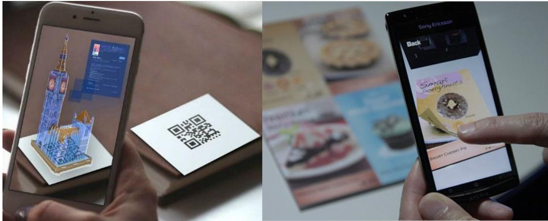
Εικόνα 3.4. Εφαρμογές επαυξημένης πραγματικότητας βάσει αναγνώρισης προτύπου. Με χρήση δείκτη (αριστερά) και εικόνας (δεξιά).
