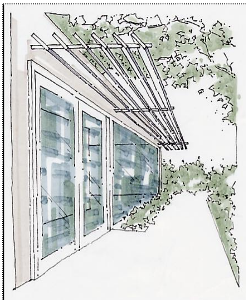
Εικόνα 12: Οριζόντιο Προστέγασμα με ανοίγματα που μπλοκάρει το άμεσο φως, αλλά επιτρέπει σε αυτό να εισέρχεται στο χώρο διάχυτο.
