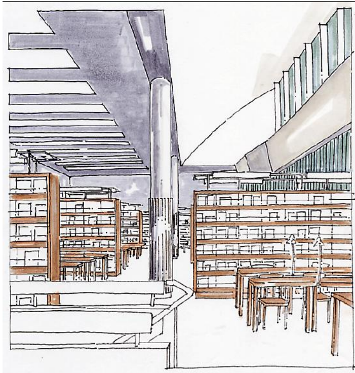
Εικόνα 10: Συνδυασμός φεγγίτη και monitor οροφής, όπου το επιβλητικό μέγεθος του monitor οροφής δημιουργεί ένα εξαιρετική αίσθηση ύψους στο χώρο. (Δωμάτιο περιοδικών, Library of the Institute of Technology, Otaniemi, Finland )
