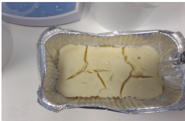
Σχήμα 15: Φοινικοστεαρίνη & έλαιο καρύδας (80/20 w/w) με προσθήκη λιπάσης μετά από 12 ώρες ανάδευσης με σκοπό την δι εστεροποίηση.
