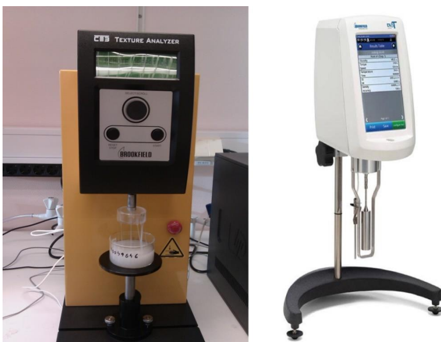
Εικόνα 17. Αριστερά: Αναλυτής υφής Brookfield CT3. Δεξιά: Ροόμετρο Brookfield Rheometer DV-III-T.
