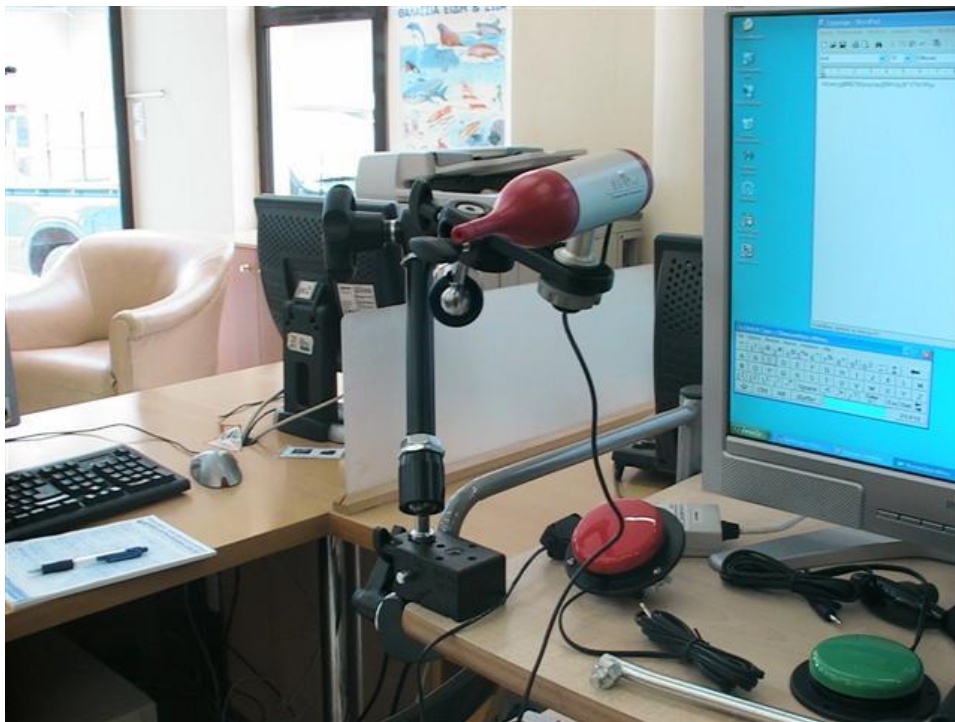
Εικόνα 6: Συσκευή αναγνώρισης κίνησης με εισπνοή και εκπνοή υπολογιστή απλά
