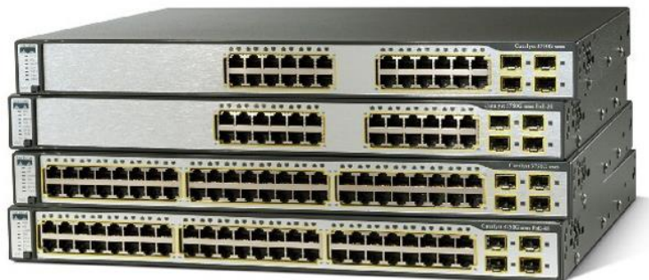
Εικόνα 3.6 Layer 3 Ethernet Switches
