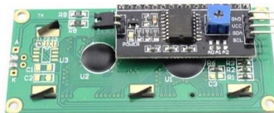
Εικόνα 10.1 Πίσω μέρος 16x2 LCD module με ενσωματωμένο I 2 C expander
