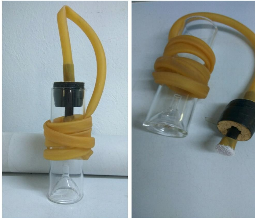
Εικόνα 13 Συσκευή σύλληψης ακμαίων κουνουπιών Human Bait
