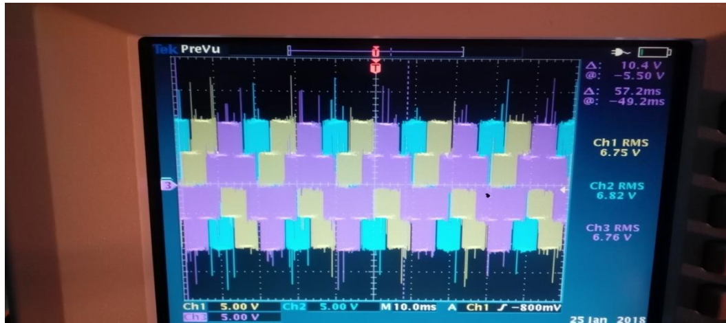
Εικόνα 6-25: Τρεις φασικές τάσεις χωρίς πυκνωτή στο DC Bus
