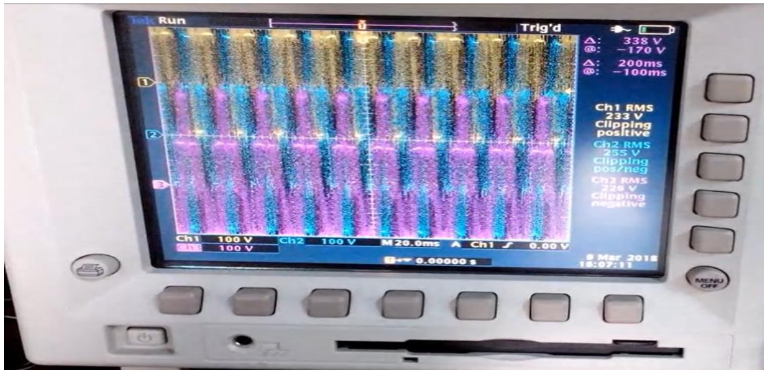
Εικόνα 6-107: Τρεις φασικές τάσεις εξόδου με DC Bus 552V
