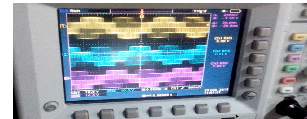
Εικόνα 6-59: Τρεις φασικές τάσεις εξόδου με DC Bus 15V
