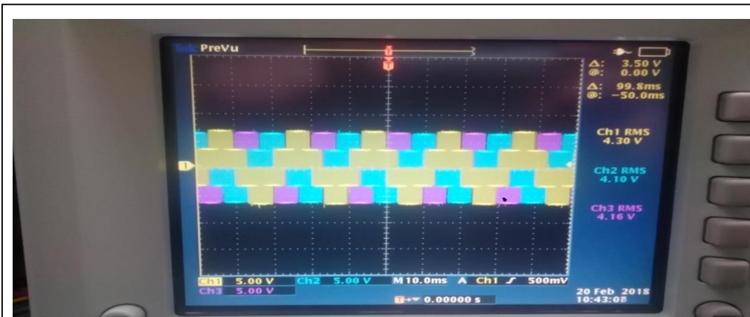
Εικόνα 6-53: Τρεις φασικές τάσεις με DC Bus 12V
