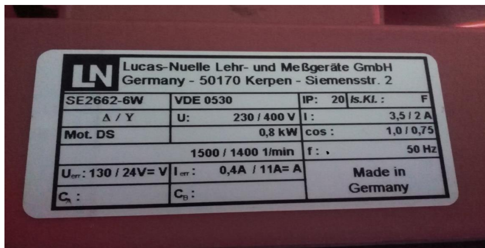
Εικόνα 6-70: Χαρακτηριστικά του τριφασικού κινητήρα
