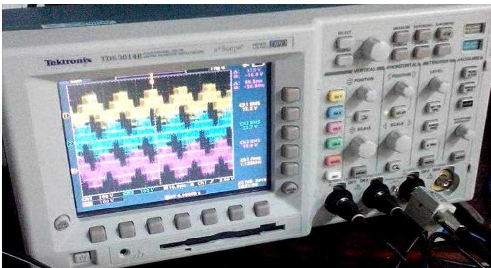
Εικόνα 6-81: Τρεις φασικές τάσεις εξόδου με DC Bus 180V
