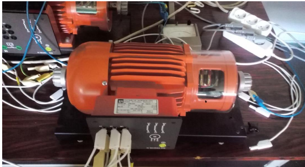
Εικόνα 6-69: Τριφασικός ασύγχρονος κινητήρας δακτυλιοφόρου δρομέα
