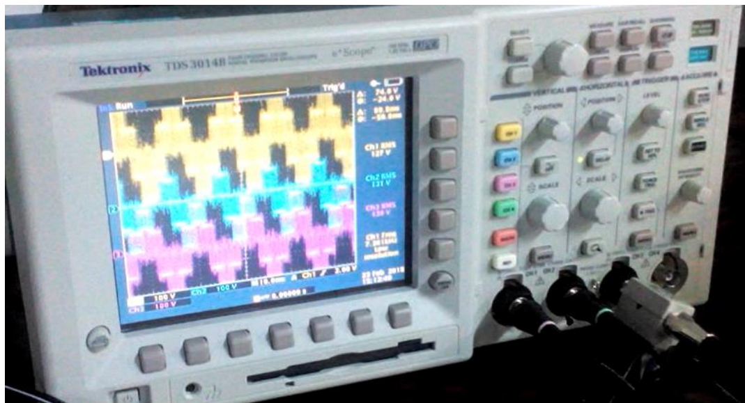
Εικόνα 6-85: Τρεις φασικές τάσεις εξόδου με DC Bus 320V
