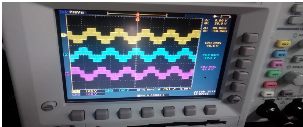
Εικόνα 6-79: Τρεις φασικές τάσεις εξόδου με DC Bus 115,8V
