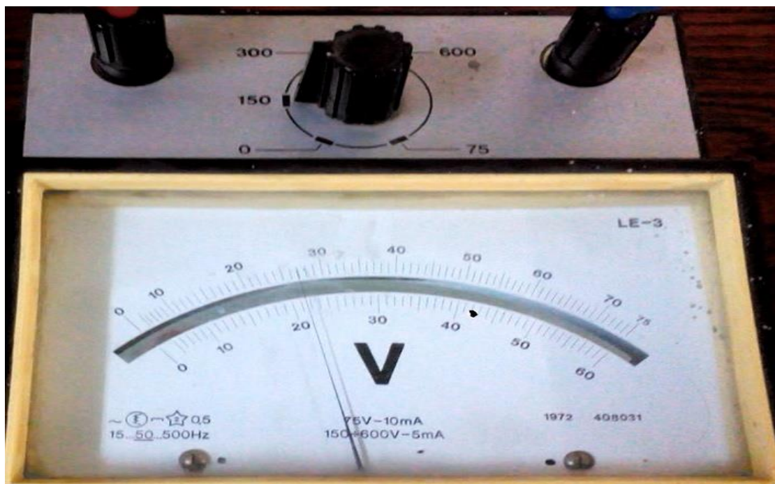
Εικόνα 6-116: Πολική τάση 50V
