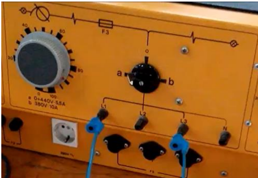
Εικόνα 6-100: Εναλλασσόμενη πηγή ρυθμιζόμενης τάσης συχνότητας 50Hz του εργαστηρίου ηλεκτρικών μηχανών
