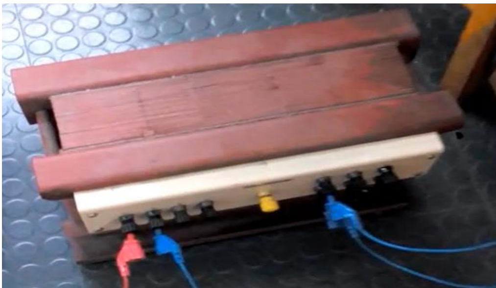
Εικόνα 6-104: Μετασχηματιστής απομόνωσης με λόγο 1:1
