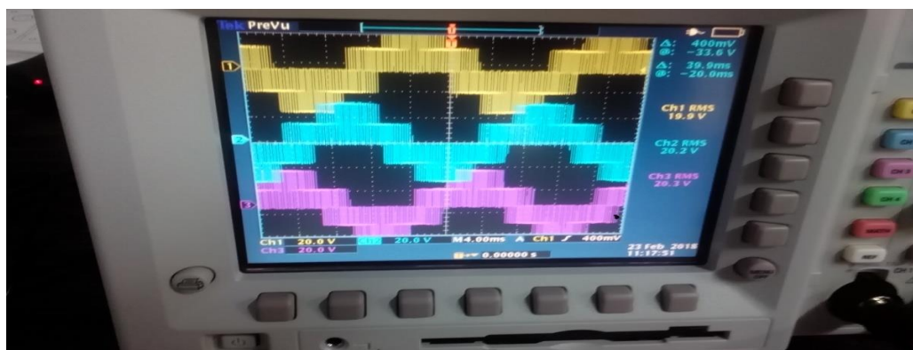
Εικόνα 6-68: Τρεις φασικές τάσεις εξόδου με DC Bus 50V
