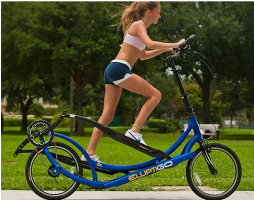
Εικόνα 151. Ποδήλατο της εταιρίας ElliptiGO, που αντλεί κίνηση από την ελλειπτική κίνηση των ποδιών.
