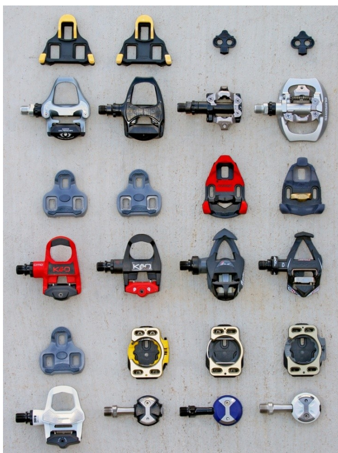
Εικόνα 173. Διαφορετικών ειδών κουμπωτά πετάλια με τα ανάλογα σχαράκια τους.
