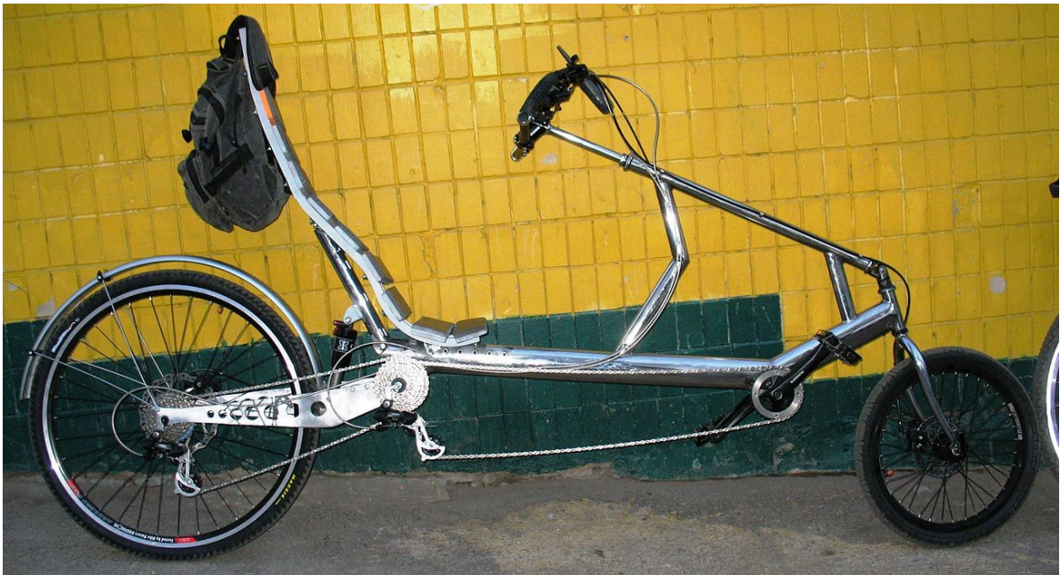
Εικόνα 61. Ποδήλατο με σκελετό recumbent , μακριού μεταξονίου, διεύθυνσης άνω του καθίσματος.
