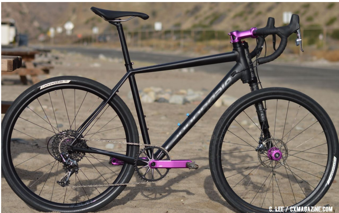
Εικόνα 113. Ποδήλατο cyclocross Cannondale Slate, με εμπρόσθιο σύστημα ανάρτησης LEFTY, της ίδιας εταιρίας.
