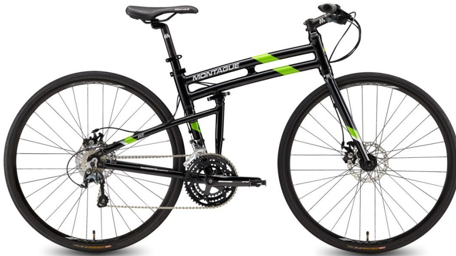
Εικόνα 42. Διαιρούμενο ποδήλατο της Montague που διπλώνει στο πλάι.
