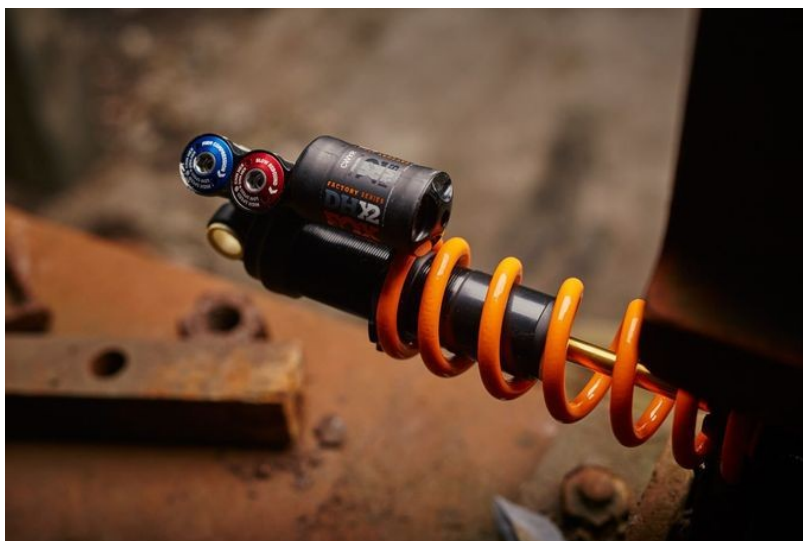
Εικόνα 133. Οπίσθια ανάρτηση με εξωτερικό μεταλλικό ελατήριο και υδραυλικό αποσβεστήρα.
