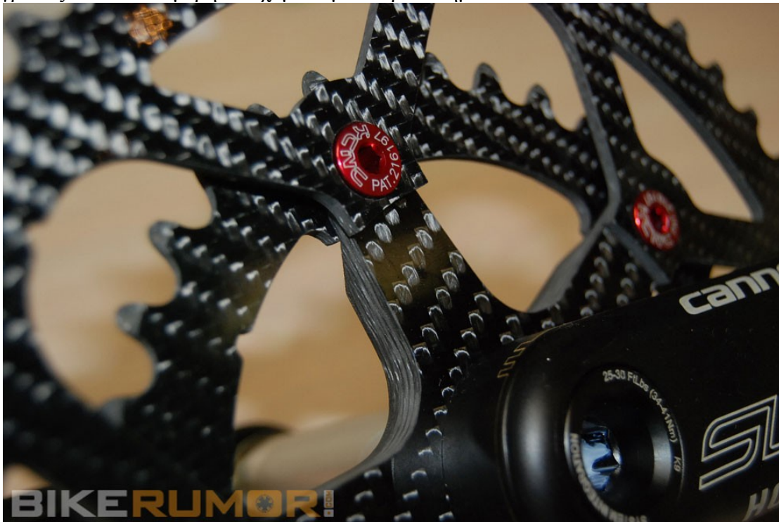
Εικόνα 11. Δισκοβραχίονας με τα γρανάζια του κατασκευασμένα κατά παραγγελία, από πολυμερή ενισχυμένα με ανθρακονήματα.
