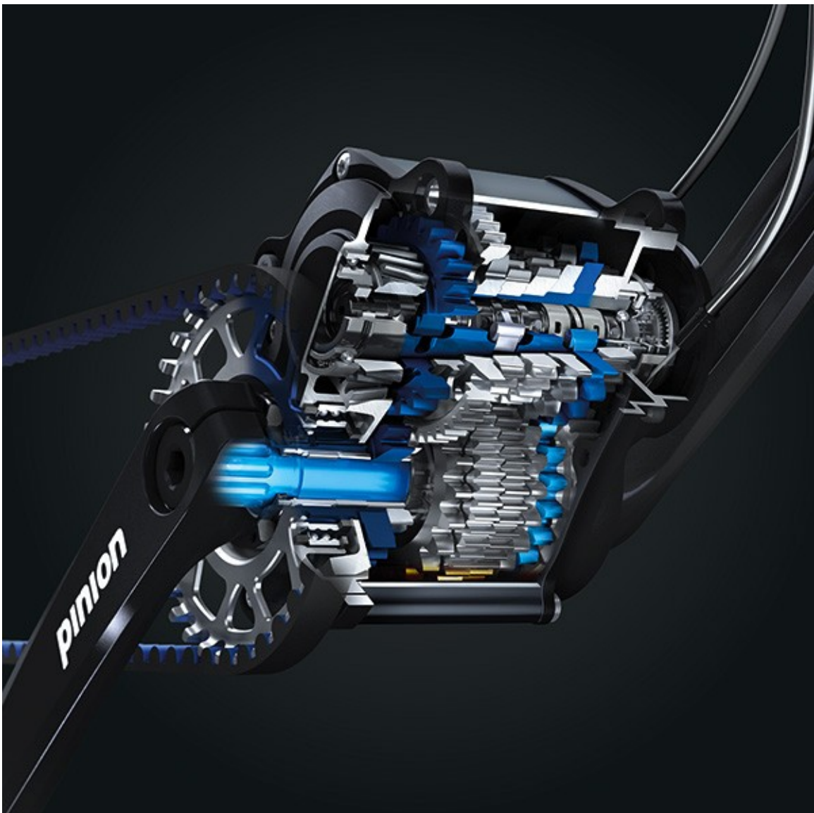
Εικόνα 189. Σύστημα εναλλαγής σχέσεων μετάδοσης μέσω κιβωτίου ταχυτήτων, της εταιρίας Pinion.
