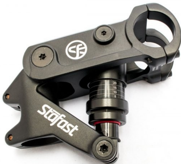
Εικόνα 120. Ο λαιμός με ενσωματωμένη ρυθμιζόμενη ανάρτηση αέρος, της Starfast.
