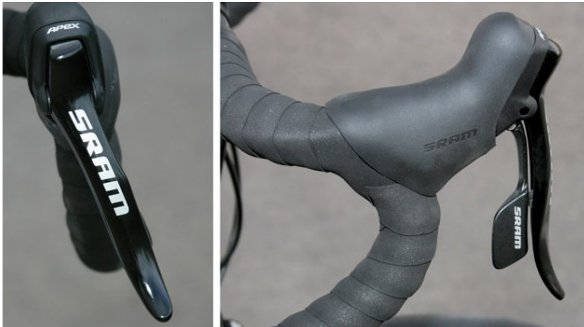
Εικόνα 179. Χειριστήριο εκτροχιαστή ποδηλάτου αγώνων δρόμου, με ενσωματωμένο χειριστήριο πέδησης, της εταιρίας SRAM.
