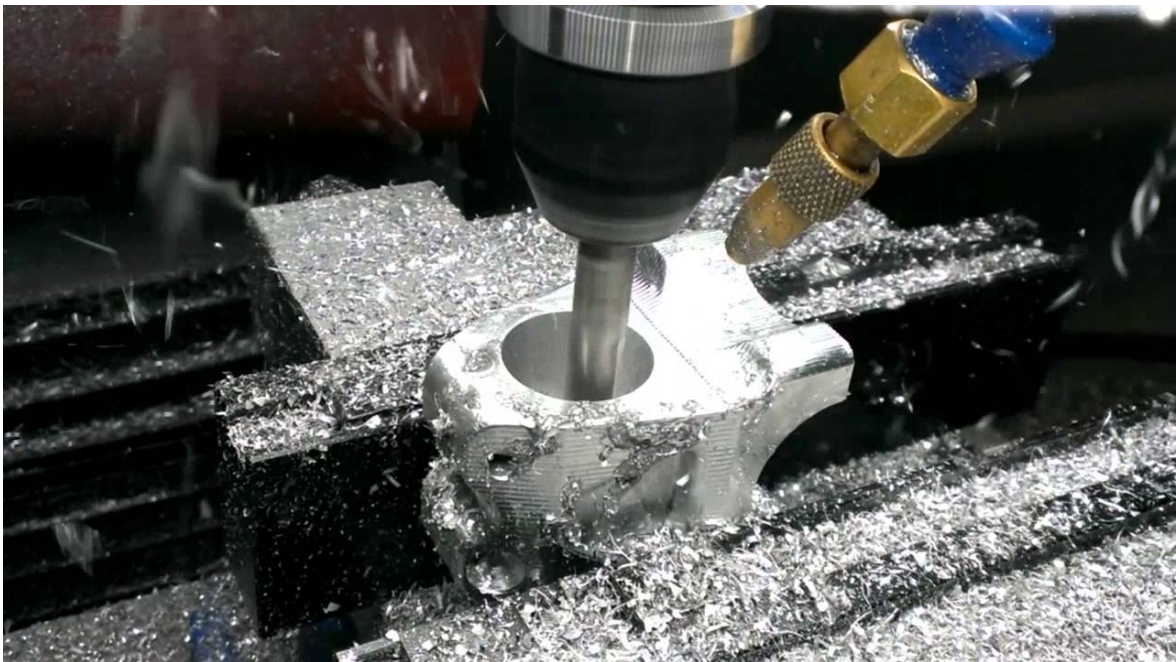
Εικόνα 29. Λαιμός τιμονιού επεξεργάζεται σε φρέζα με την μέθοδο C.N.C..
