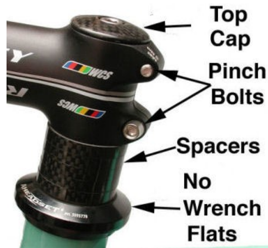
Εικόνα 88. Λαιμός πιρουνιού χωρίς βιδωτό headset.
