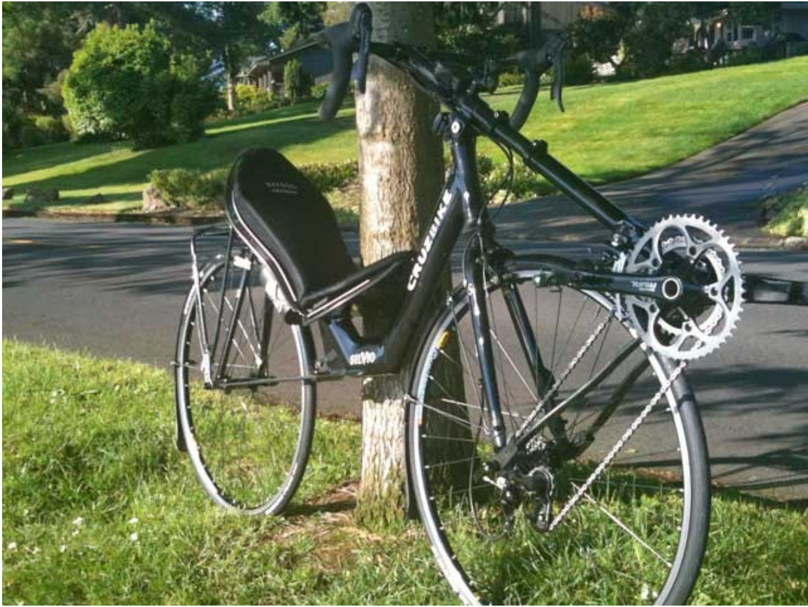
Εικόνα 65. Ποδήλατο Cruzbike Silvio με σκελετό recumbent, διεύθυνσης άνω του καθίσματος, εμπρόσθιας κίνησης.
