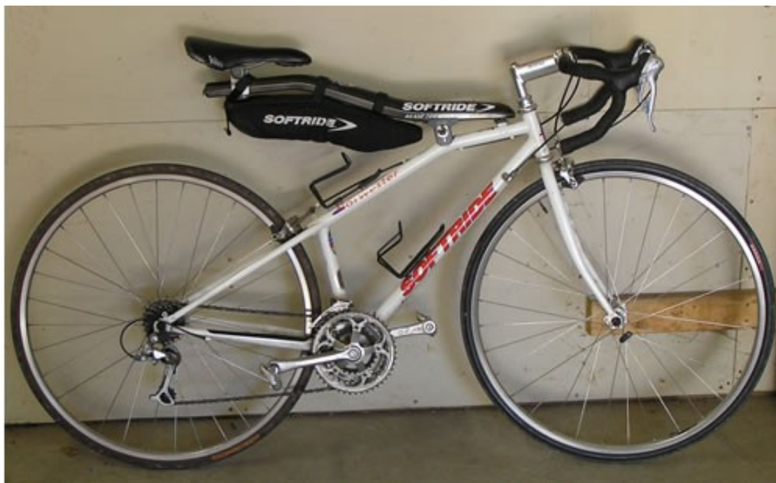
Εικόνα 47. Ποδήλατο δρόμου της εταιρίας Softride, που ενσωματώνει στοιχεία από τους σκελετούς τύπου διαμάντι και τύπου beam.
