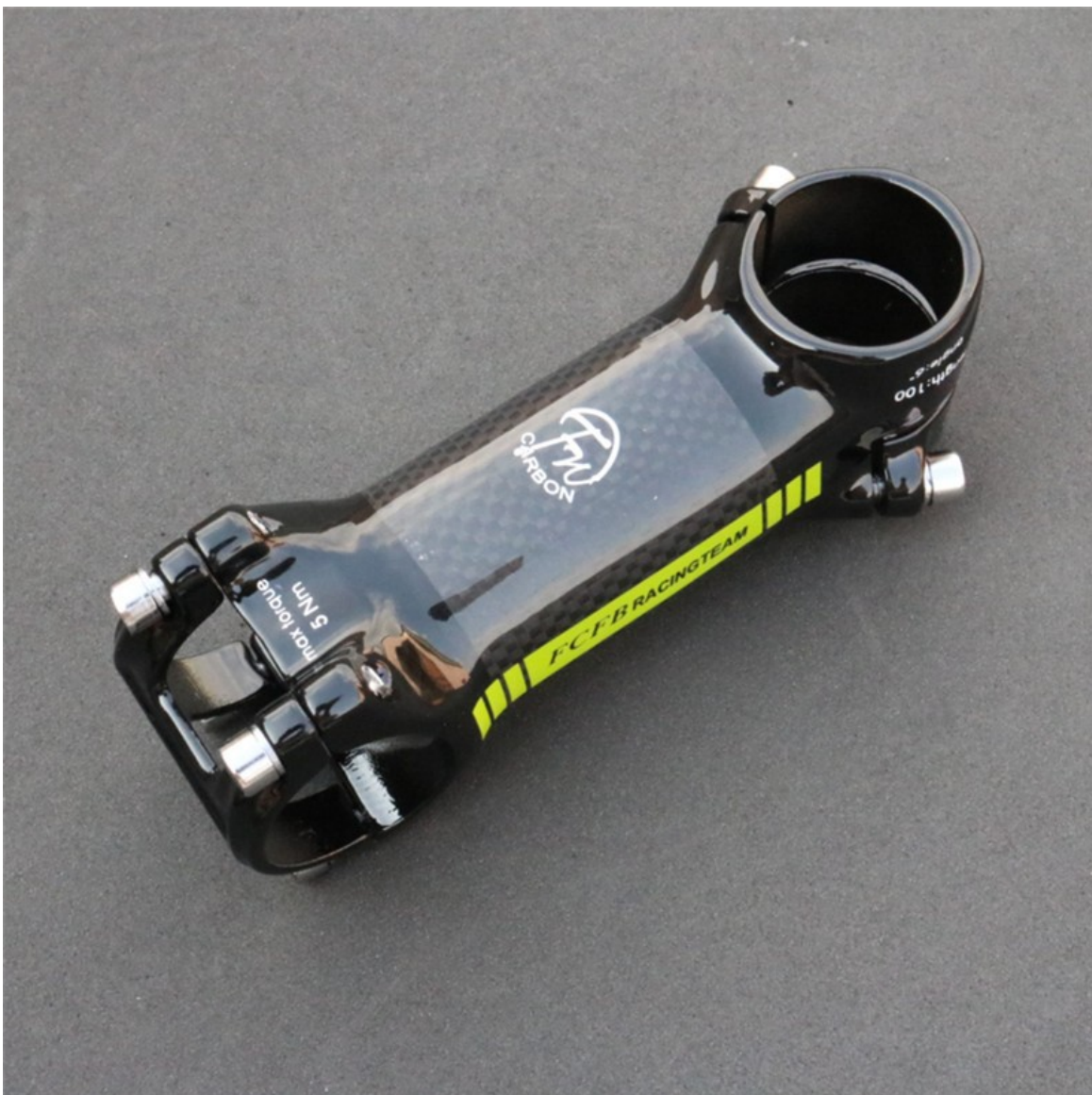
Εικόνα 96. Λαιμός τιμονιού κατασκευασμένος από πολυμερή ενισχυμένα με ανθρακονήματα.
