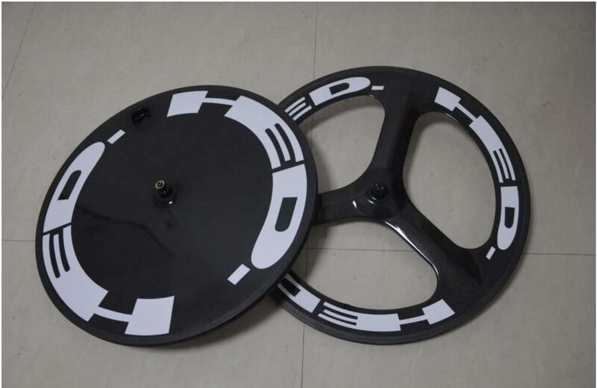
Εικόνα 199. Αριστερά ένας πλήρως κλειστός τροχός και δεξιά ένα τροχός τριών βραχιόνων, κατασκευασμένοι από πολυμερή ενισχυμένα με ανθρακονήματα, αεροδυναμικής σχεδίασης, της εταιρίας HED.
