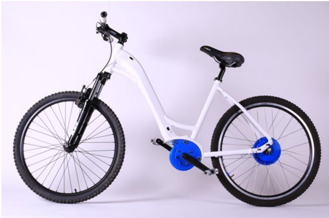
Εικόνα 169. Ποδήλατο CHAINFREE με κλειστό κύκλωμα υδραυλικής αντλίας και υδραυλικού κινητήρα.
