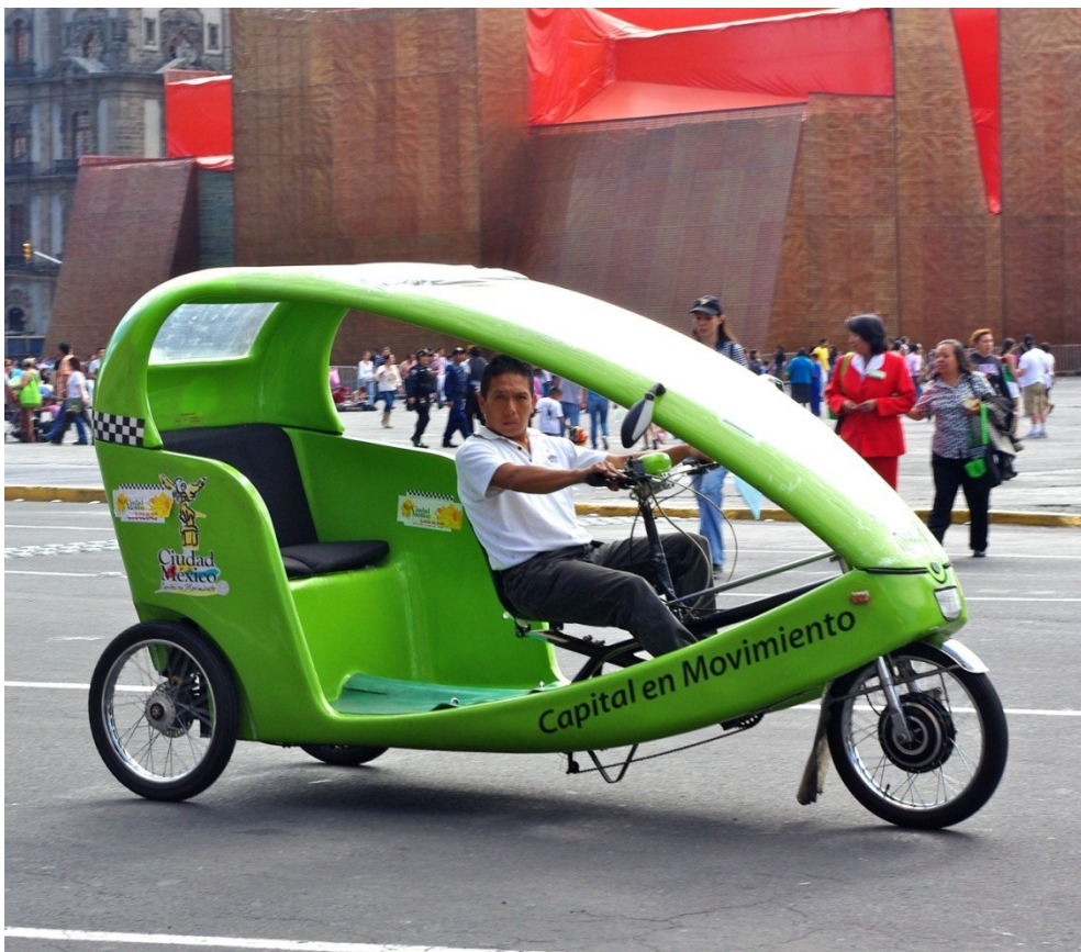
Εικόνα 74. Τρίτροχο ποδήλατο ταξί, με σκελετό τύπου recumbent .
