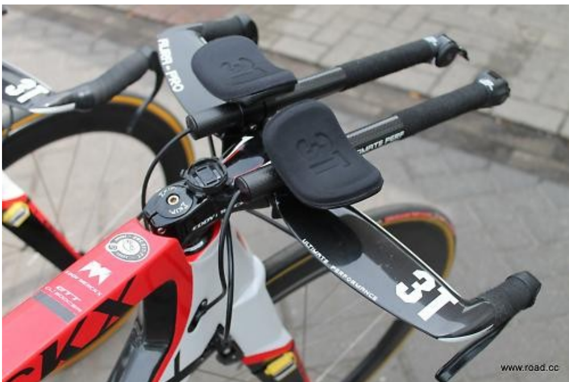
Εικόνα 105. Τιμόνι bullhorn αεροδυναμικής σχεδίασης, εξοπλισμένο με aero bars, της 3T.
