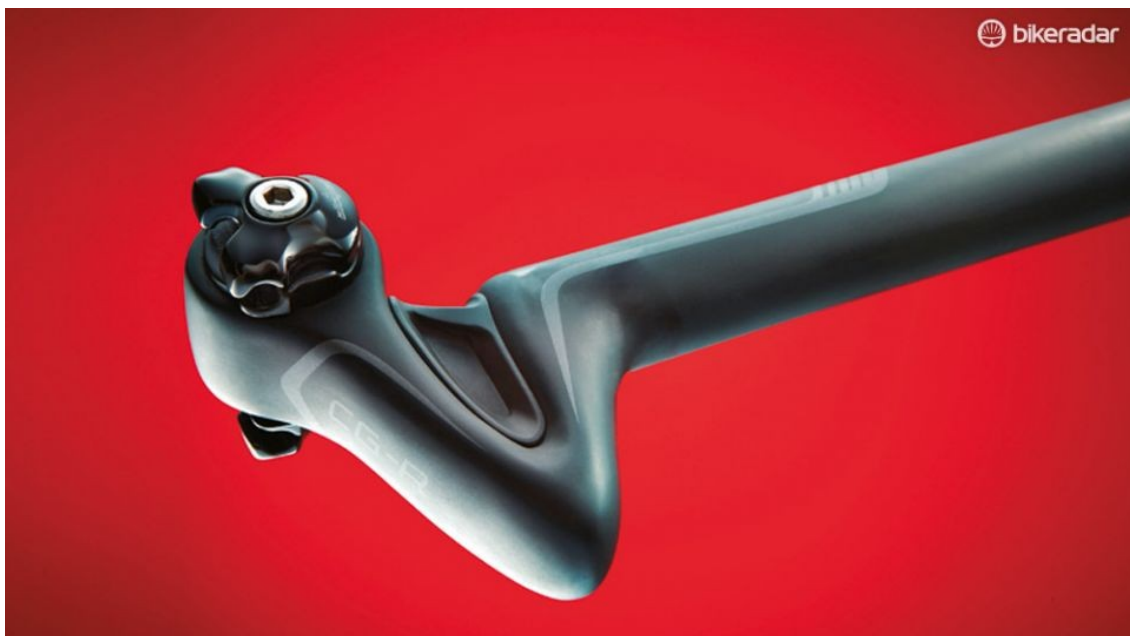
Εικόνα 125. Ντίζα σέλας CG-R της Specialised κατασκευασμένη από πολυμερή ενισχυμένα με ανθρακονήματα, με ελαστομερή παρέμβυσμα Zert για την απόσβεση κραδασμών.
