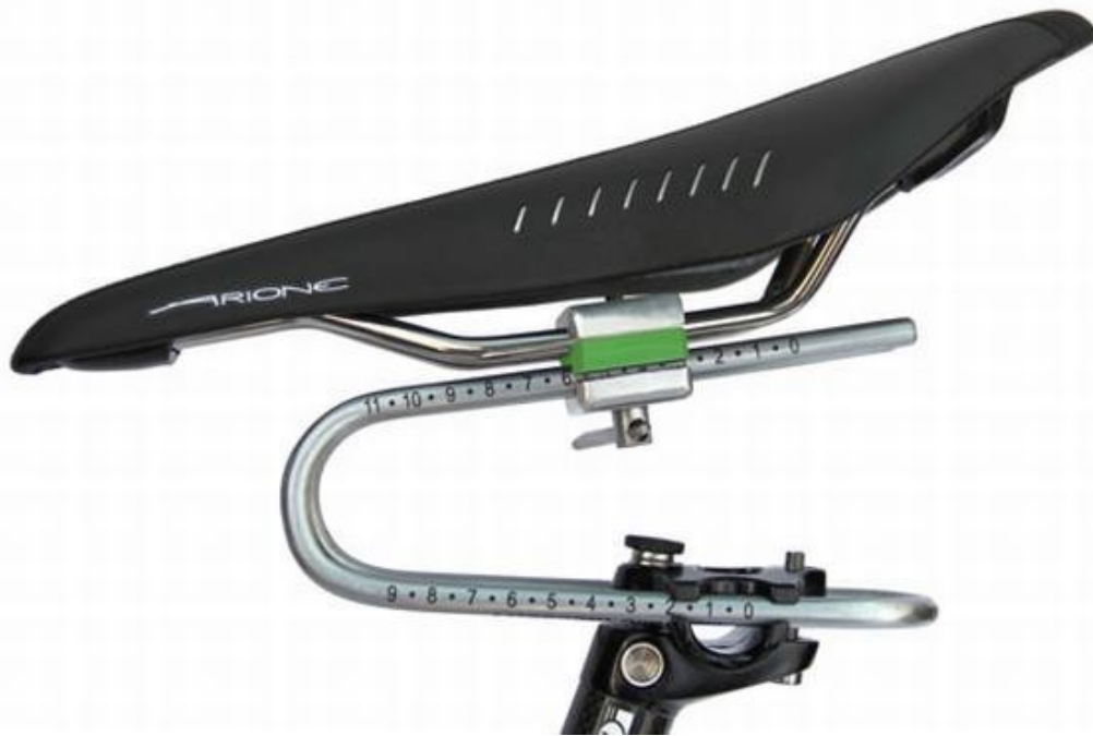
Εικόνα 124. Ο μηχανισμός απόσβεσης κραδασμών Spring, της εταιρίας Risten.
