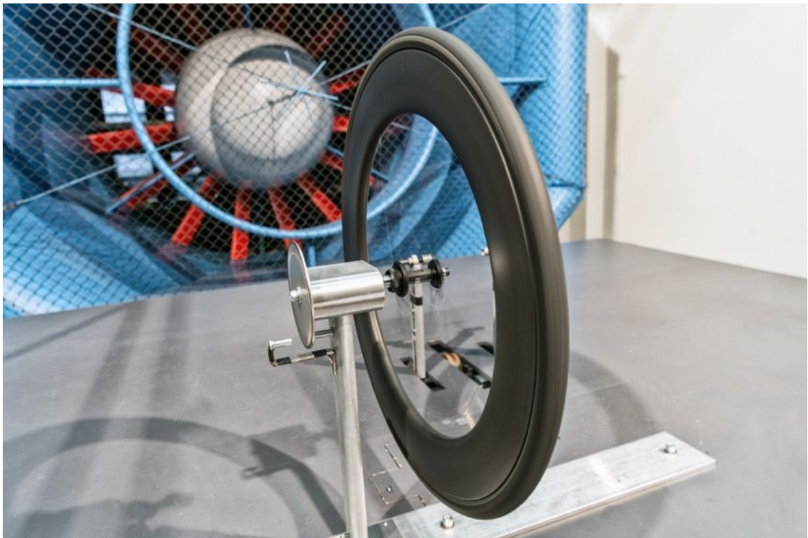
Εικόνα 197. Αεροδυναμικός τροχός με στεφάνη υψηλού προφίλ, για ποδήλατο αγώνων ταχύτητας, υποβάλλεται σε δοκιμές σε αεροσήραγγα.
