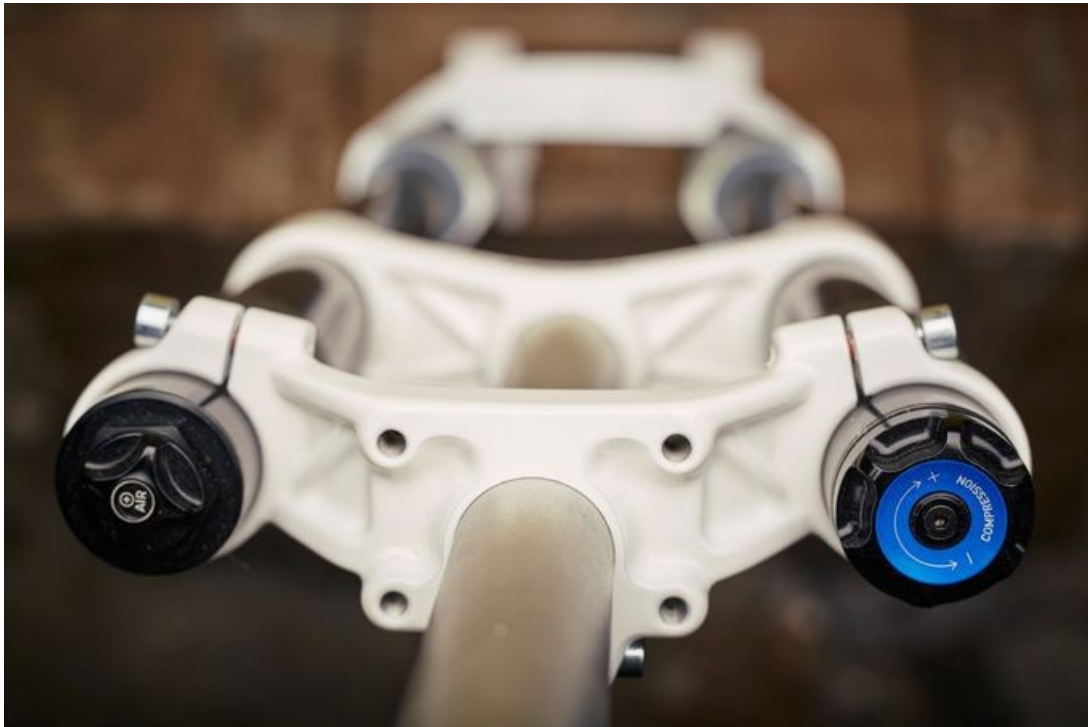
Εικόνα 111. Εμπρόσθιο σύστημα ανάρτησης RockShox BoXXer που εδράζεται σε δύο στέμματα. Στη εικόνα φαίνονται και οι μηχανισμοί ρύθμισης της ανάρτησης.
