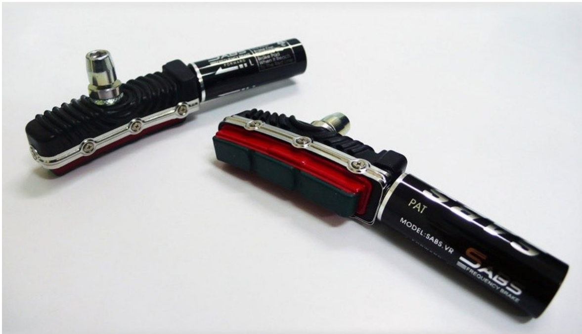
Εικόνα 223. Τα ειδικά τακάκια με το ενσωματωμένο σύστημα αντιμπλοκαρίσματος τροχών SABS.
