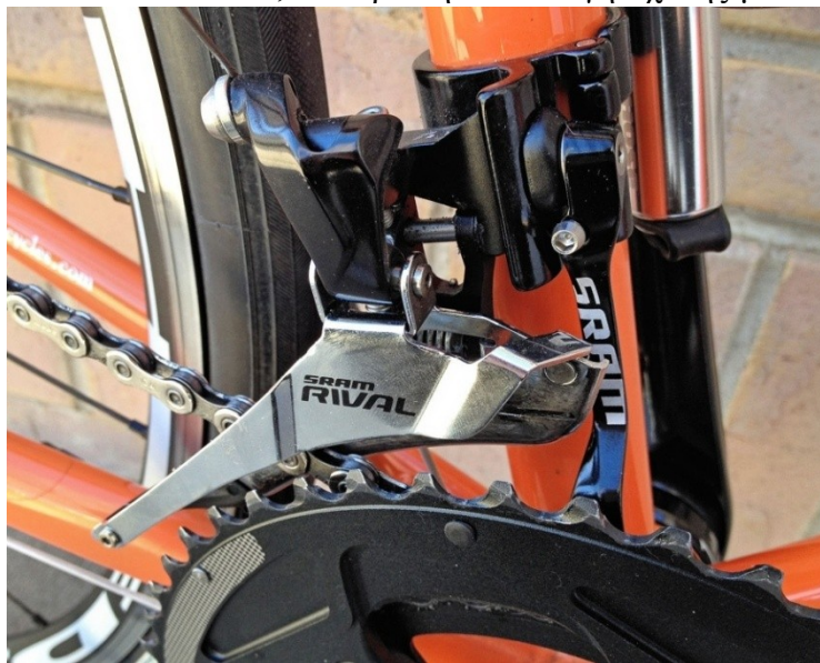
Εικόνα 175. Εμπρόσθιος εκτροχιαστής μάρκας SRAM, σειράς RIVAL.
