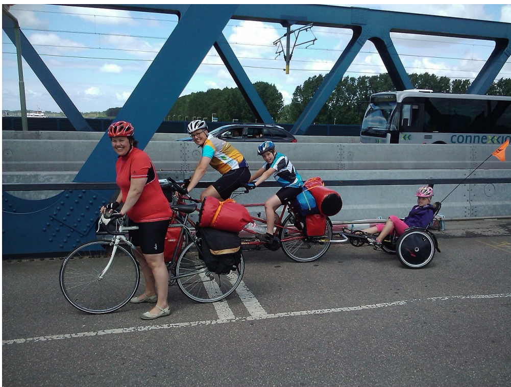
Εικόνα 73. Συζευγμένο συρόμενο ποδήλατο τύπου recumbent με δύο οπίσθιους τροχούς, σε προπορευόμενο ποδήλατο tandem.
