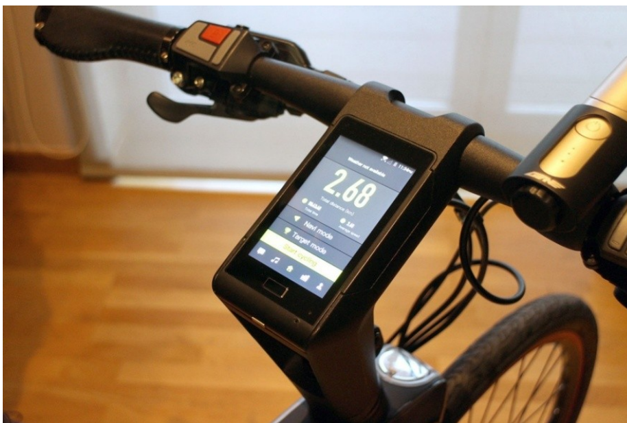
Εικόνα 98. Ο ενσωματωμένος cyclocomputer με οθόνη στο λαιμό του ποδηλάτου "Le Synrac".
