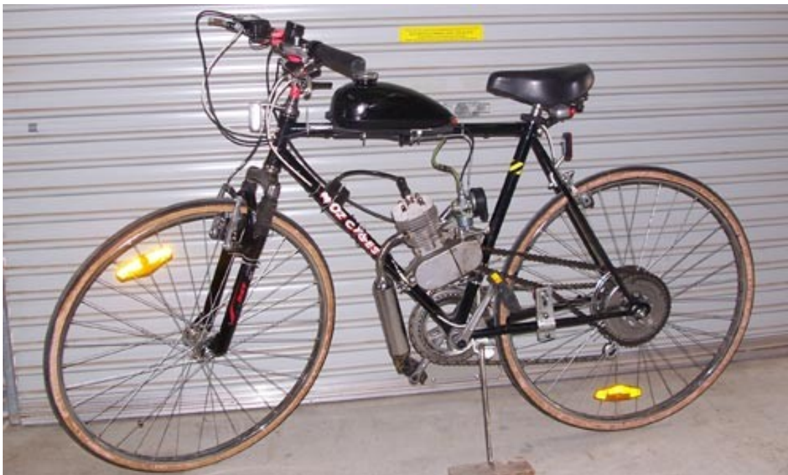
Εικόνα 163. Ποδήλατο με Μ.Ε.Κ. τοποθετημένη στον σκελετό του, που κινεί τον οπίσθιο τροχό μέσω αλυσίδας και γραναζιού.
