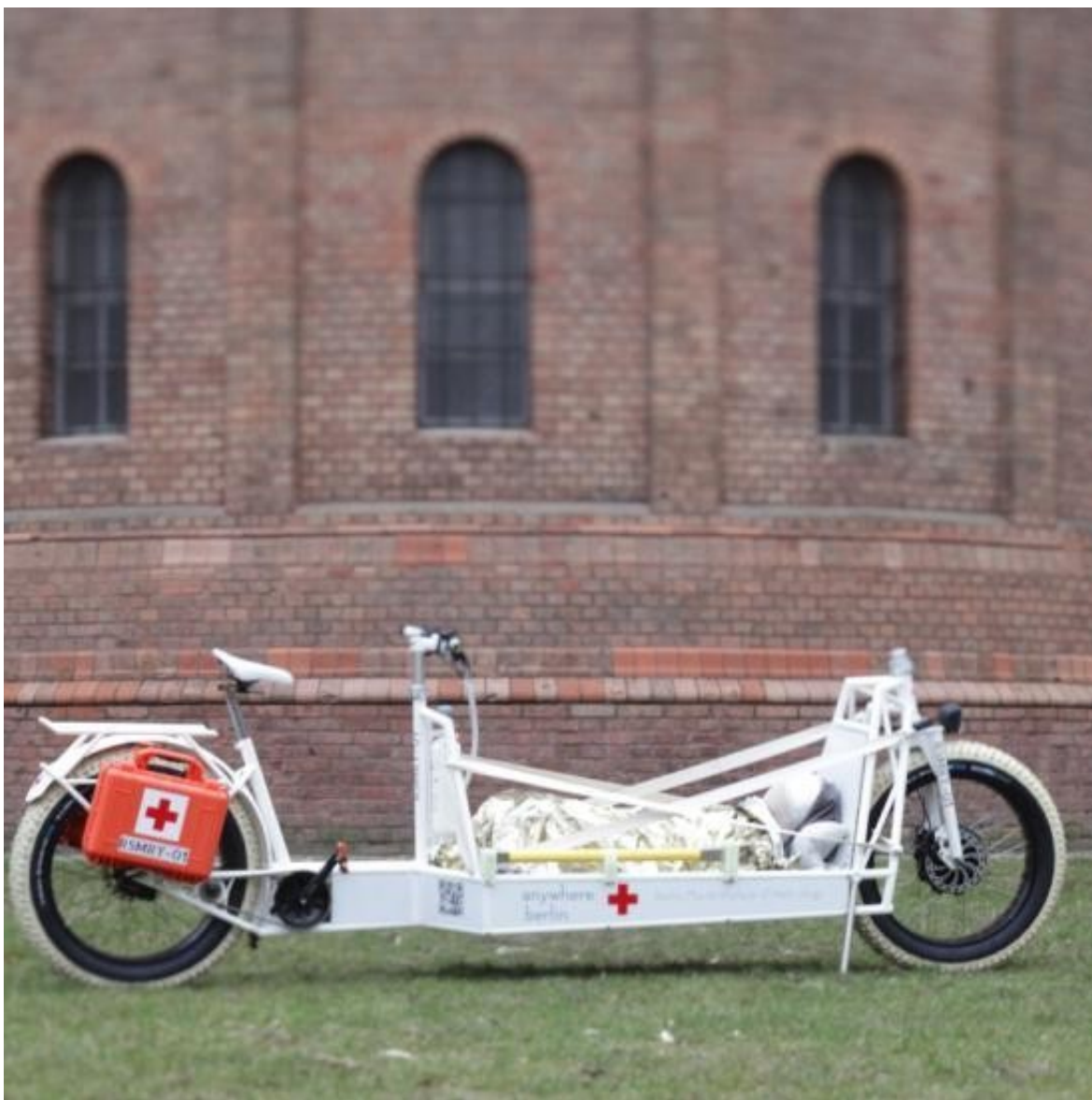
Εικόνα 78. Δίτροχο ποδήλατο με σκελετό μεταφοράς φορτίων εμπρός του αναβάτη, διασκευασμένο σε ασθενοφόρο πρώτων βοηθειών.
