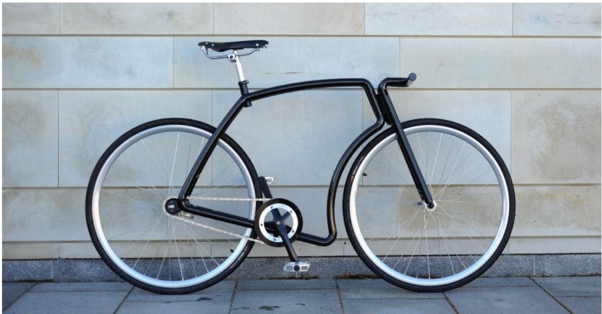
Εικόνα 52. Πρωτότυπο ποδήλατο με ασάλινο σκελετό δίχως κάθετο σωλήνα εν ονόματι Viks, ιδιαίτερου σχεδιασμού, του Indrek Nasuk της Velonia Bicycles.
