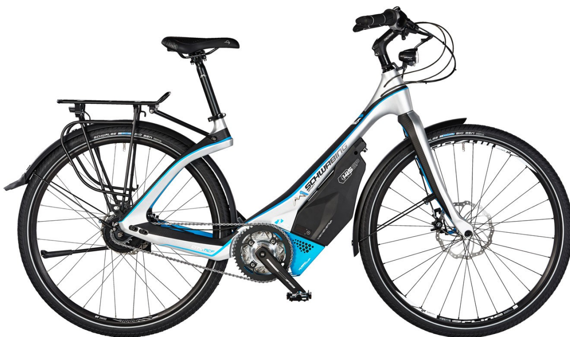
Εικόνα 158. Ποδήλατο με ηλεκτρική υποβοήθηση pedelec, με ηλεκτροκινητήρα τοποθετημένο στο κέλυφος μεσαίας τριβής.
