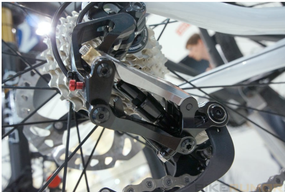
Εικόνα 181. Οπίσθιος υδραυλικός εκτροχιαστής Acros A-GE MT. Διακρίνεται το υδραυλικό έμβολο.
