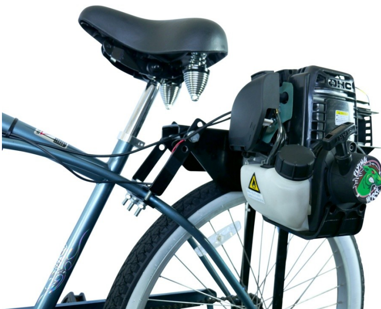
Εικόνα 164. Ποδήλατο με Μ.Ε.Κ. τοποθετημένη άνω του οπίσθιου τροχού του, η οποία κινεί τον τροχό μέσω τριβής του ελαστικού.
