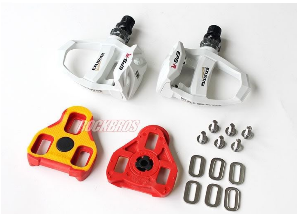
Εικόνα 15. Κομπωτά πετάλια EXUSTAR E-PR200 κατασκευασμένα από θερμοπλαστικά. Διακρίνονται επίσης και τα σαράκια με τα στοιχεία σύνδεσής τους, που βιδώνουν στα παπούτσια του αναβάτη.
