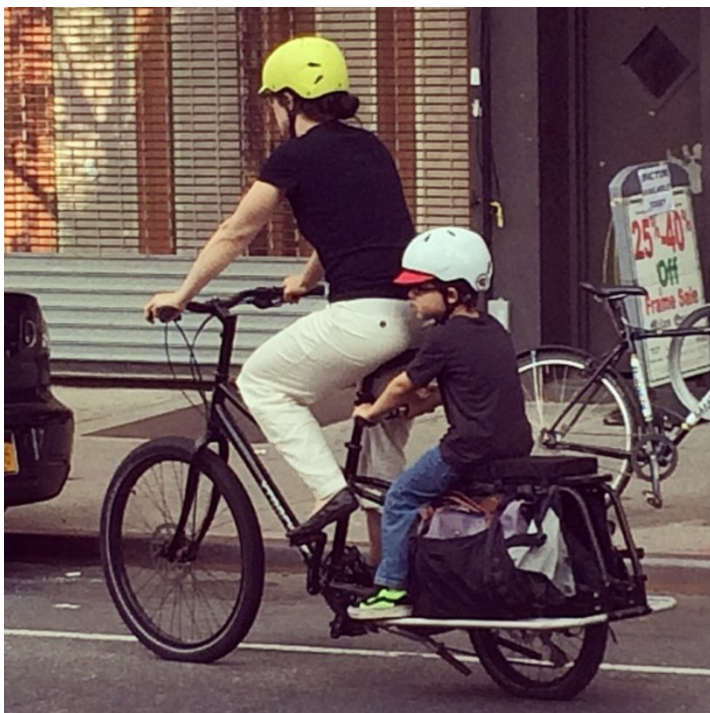
Εικόνα 81. Δίτροχο ποδήλατο με σκελετό μεταφοράς φορτίων πίσω από τον αναβάτη, ο οποίος έχει δεχθεί μετατροπή για μεταφορά παιδιών.
