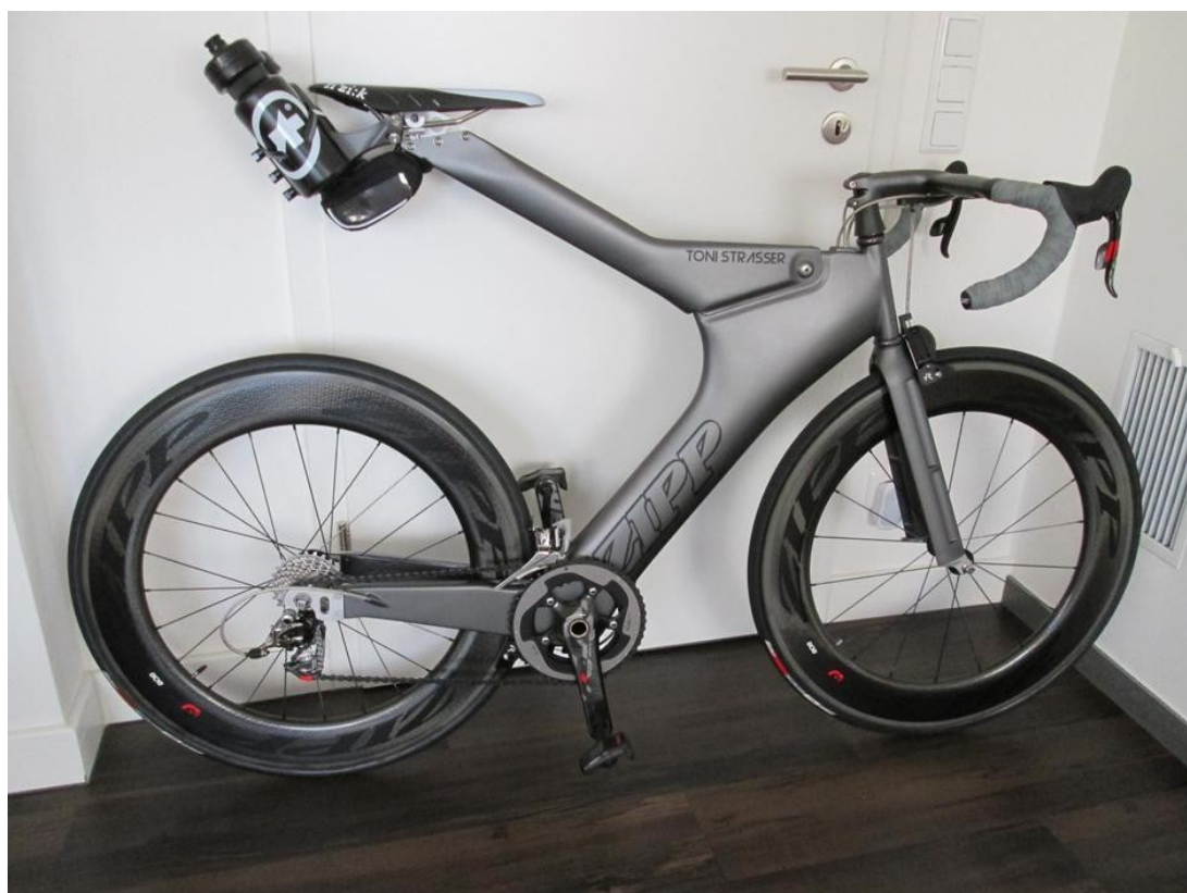
Εικόνα 48. Ποδήλατο αγώνων δρόμου Zipp 2001, με σκελετό τύπου beam. Διακρίνεται το σημείο ένωσης του οριζόντιου σωλήνα με τον κάτω σωλήνα που χρησιμεύει και για την αυξομείωση του ύψους σέλας. Επίσης αυτός ο σκελετός διαθέτει μόνο κάτω ψαλίδια.
