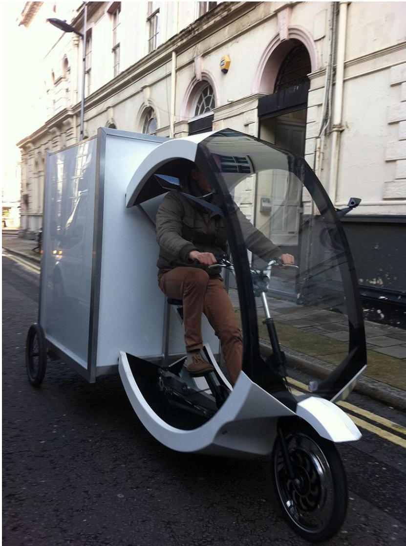
Εικόνα 83. Μοντέρνο τρίκυκλο ποδήλατο, με σκελετό μεταφοράς φορτίων πίσω από τον αναβάτη, με ηλεκτρική υποβοήθηση και προστατευτικό κέλυφος, που χρησιμοποιείται στο Λονδίνο.
