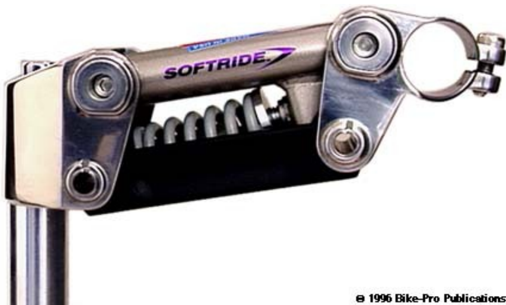
Εικόνα 119. Λαιμός chromoly με ενσωματωμένη ανάρτηση, της SOFTRIDE.
