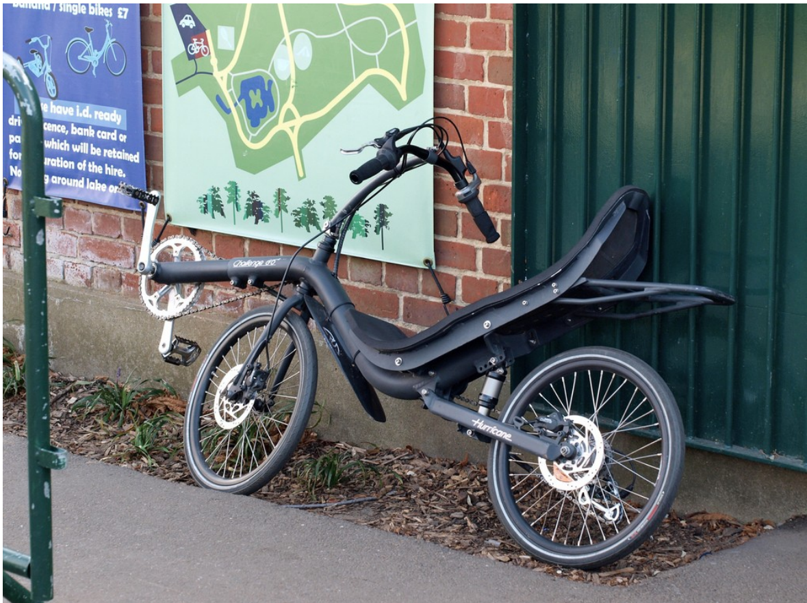
Εικόνα 106. Τιμόνι με αρκετή κλίση προς τα πίσω, σε ποδήλατο recumbent, διεύθυνσης άνω του καθίσματος.
