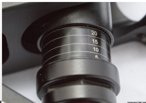
Εικόνα 122. Τα πρόσθετα δαχτυλίδια(spacers), υπεύθυνα για την αυξομείωση της γωνίας κλίσης και άρα του ύψους του λαιμού.
