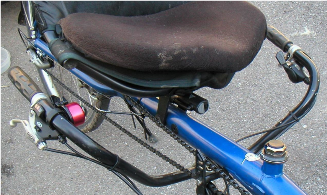
Εικόνα 107. Τιμόνι με κλίση προς τα πίσω σε ποδήλατο recumbent . διεύθυνσης κάτω του καθίσματος.
