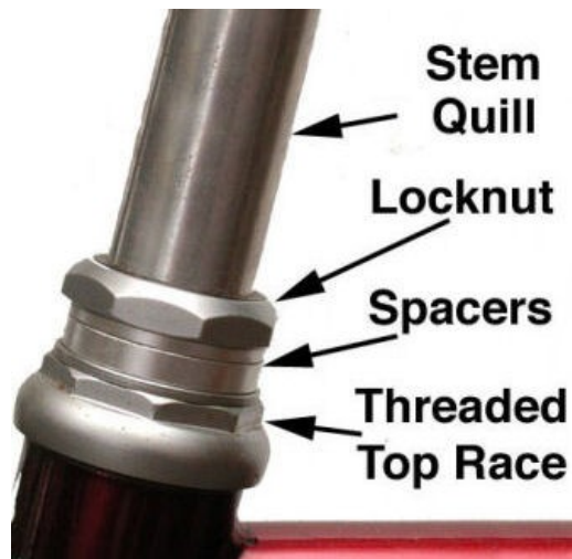
Εικόνα 87. Λαιμός πιρουνιού με βιδωτό headset.
