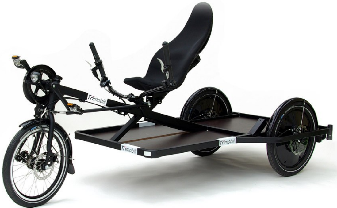
Εικόνα 84. Τρίκυκλο ποδήλατο με σκελετό τύπου recumbent, μεταφοράς φορτίων πίσω από τον αναβάτη, διεύθυνσης κάτω του καθίσματος και κίνησης στον εμπρός τροχό. Στην εικόνα φαίνεται η ράβδος που μεταφέρει την κίνηση από το τιμόνι στο πιρούνι για τον έλεγχο της διεύθυνσης.
