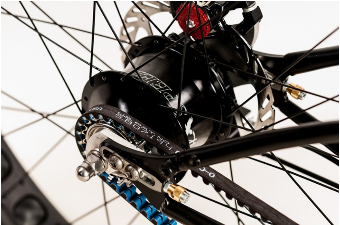
Εικόνα 184. Σύστημα εσωτερικών ταχυτήτων, το οποίο λαμβάνει κίνηση από ιμάντα.
