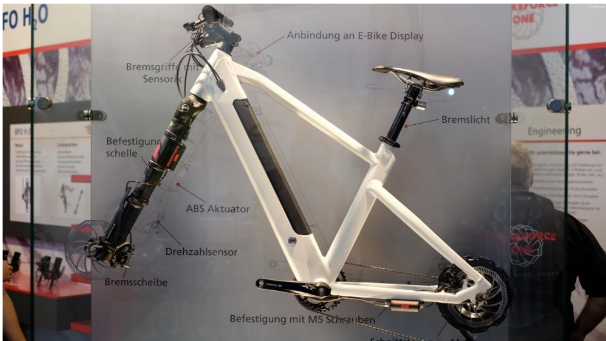
Εικόνα 224. Το ποδήλατο με ηλεκτρική υποβοήθηση στο οποίο η εταιρία Brake Force One ενσωμάτωσε σύστημα A.B.S. στα υδραυλικά δισκόφρενά του.
