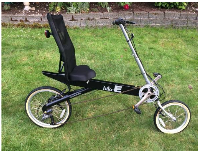
Εικόνα 63. Ποδήλατο bike E με σκελετό recumbent, συμπαγούς μακριού μεταξονίου, διεύθυνσης άνω του καθίσματος.
