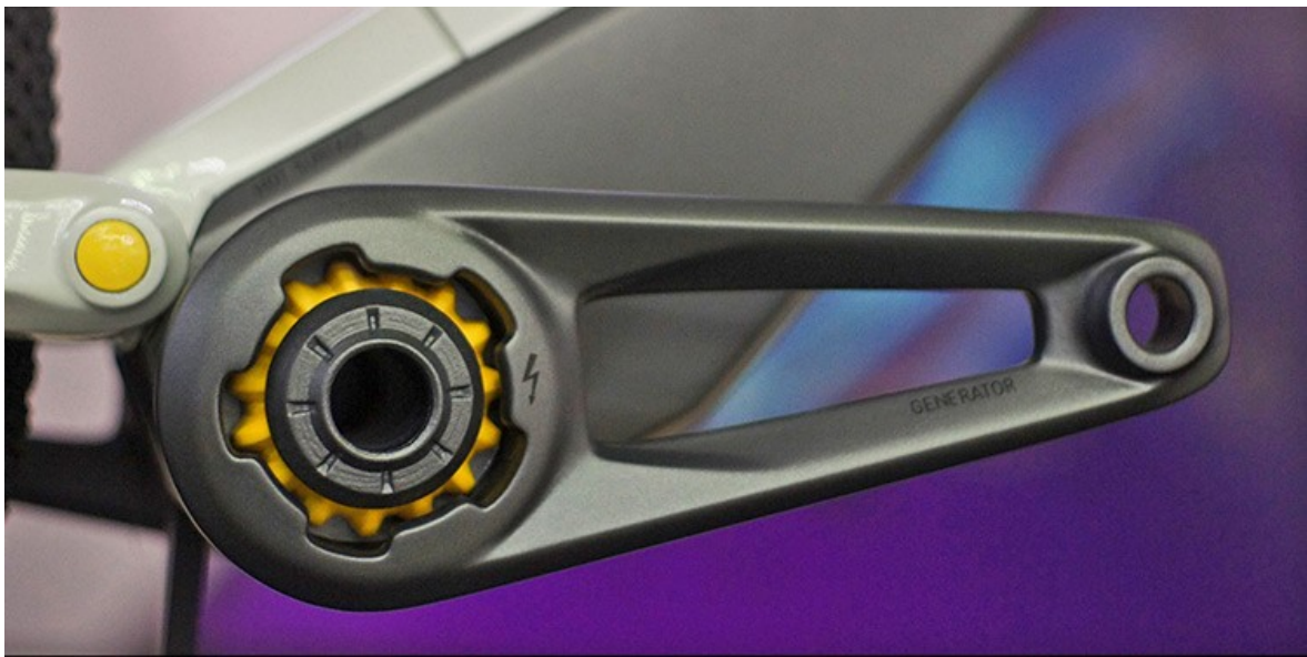
Εικόνα 161. Η ηλεκτρική γεννήτρια που βρίσκεται στο κέλυφος μεσαίας τριβής του ποδηλάτου Orbiter της Canyon και μετατρέπει την μυική ισχύ από τα πετάλια σε ηλεκτρική ενέργεια.
