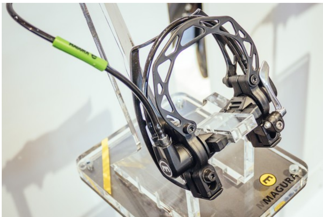
Εικόνα 216. Υδραυλικό σύστημα πέδησης στεφάνης, σύνδεσης δύο σημείων, σειράς HS11 της εταιρίας Magura. Διακρίνονται τα υδραυλικά έμβολα, που επενεργούν στα τακάκια.
