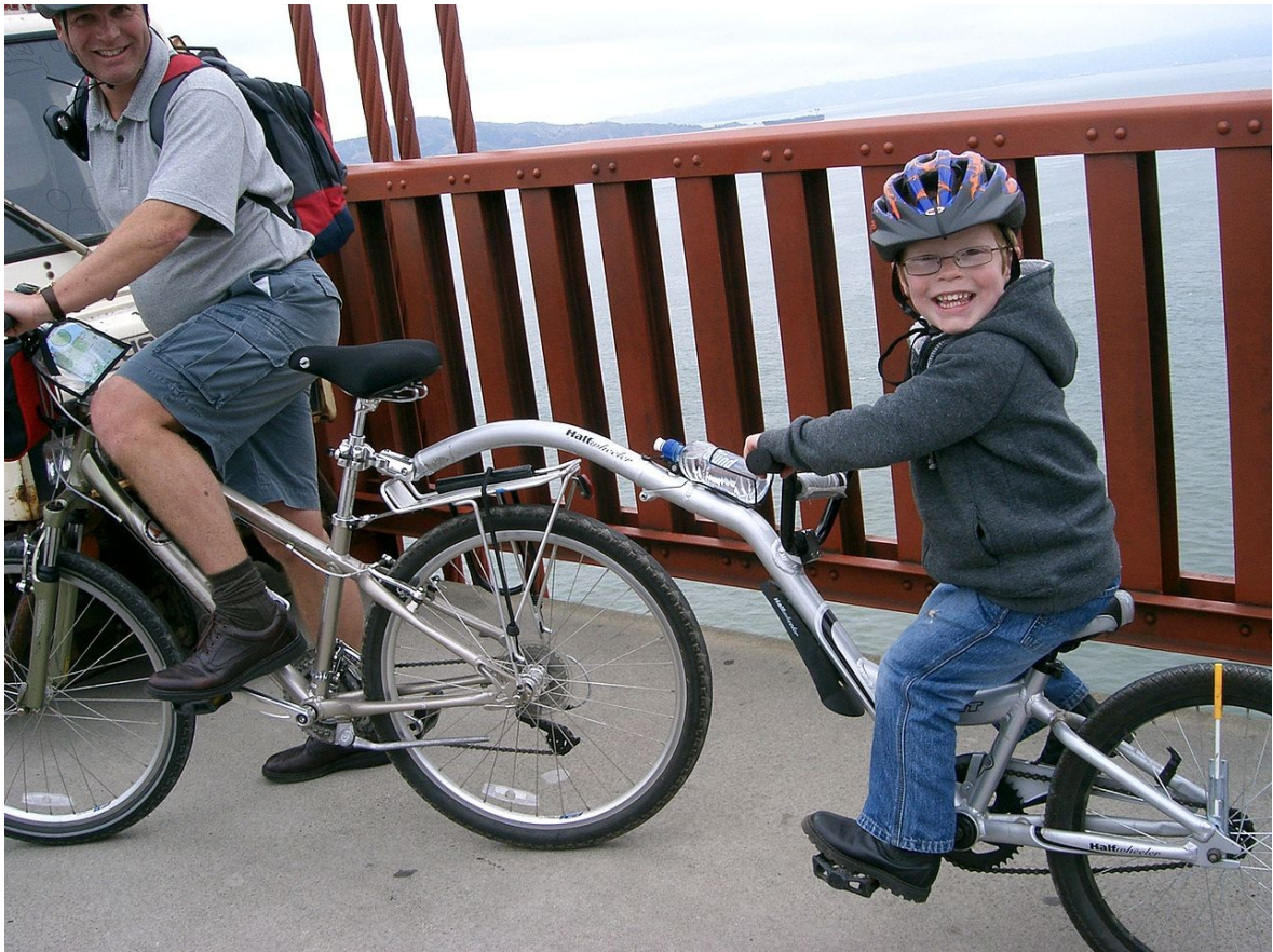
Εικόνα 72. Συζευγμένο συρόμενο ποδήλατο. Στην εικόνα φαίνεται η αρθρωτή σύνδεση με το προπορευόμενο συζευγμένο ποδήλατο.
