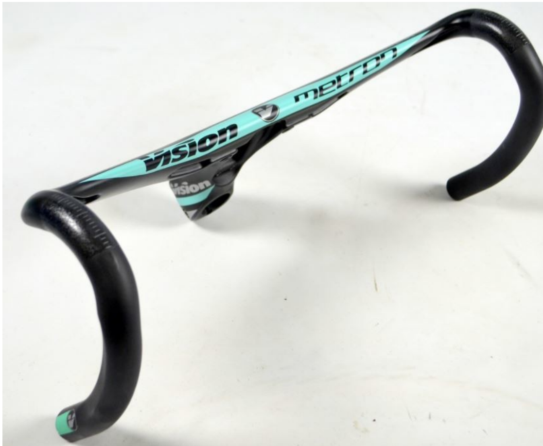
Εικόνα 103. Τιμόνι ποδηλάτου δρόμου - αγώνων ταχύτητας, μάρκας Vision. Είναι κατασκευασμένο από πολυμερή ενισχυμένα με ανθρακονήματα και είναι χαρακτηριστικός ο αεροδυναμικός σχεδιασμός του, σαν πτερύγιο, καθώς και το γεγονός ότι έχει ενσωματωμένο λαιμό.
