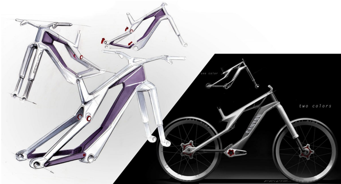
Εικόνα 147. Το πρωτότυπο ποδήλατο Orbiter της εταιρίας Canyon, με ηλεκτρομαγνητικές αναρτήσεις.
