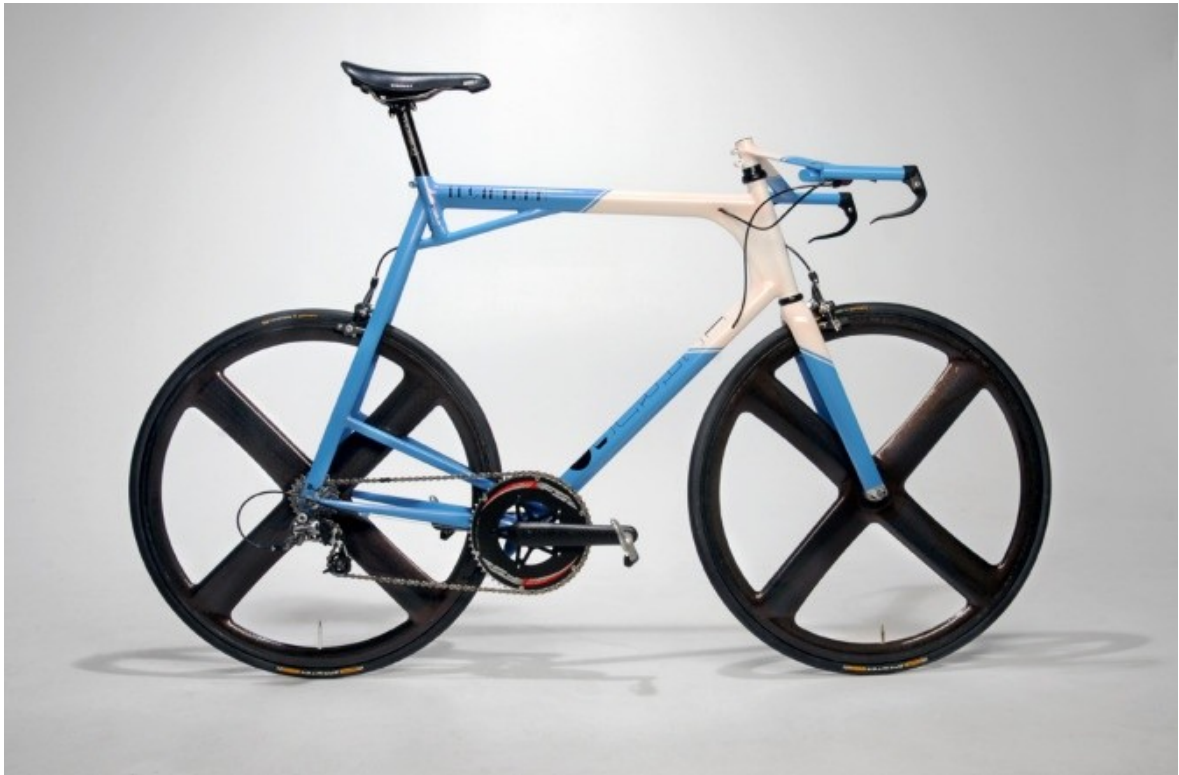
Εικόνα 51. Ποδήλατο δρόμου με ασάλινο σκελετό δίχως κάθετο σωλήνα εν ονόματι Leviathan του σχεδιαστή Ian Sutton, της Icarus.
