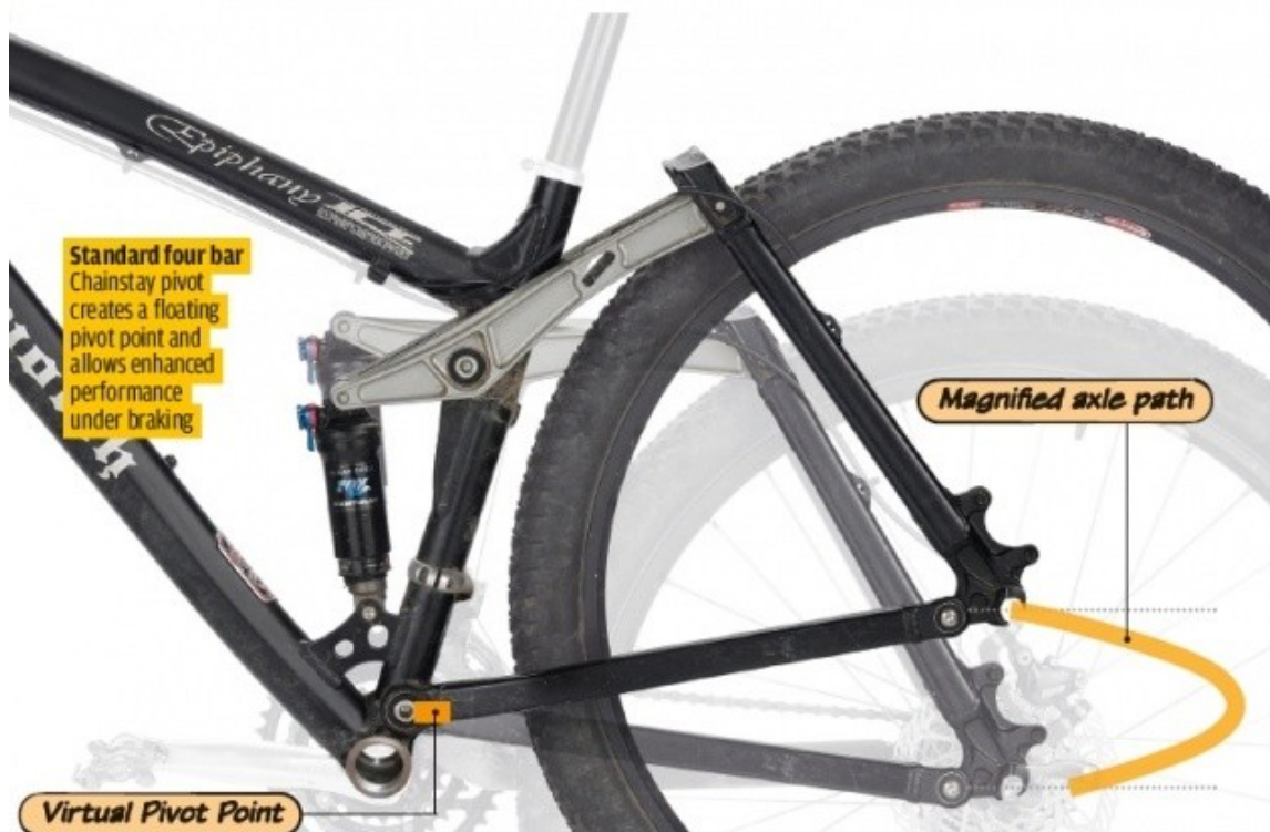
Εικόνα 136. Οπίσθια ανάρτηση συνδέσμου τεσσάρων ράβδων.
