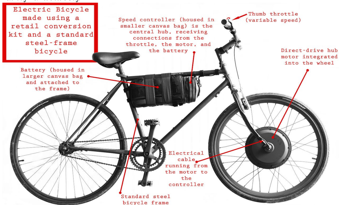
Εικόνα 159. Συμβατικό ποδήλατο που με την προσθήκη ειδικού κιτ, μετατράπηκε σε ποδήλατο με ηλεκτρική υποβοήθηση, τύπου power - on - demand.
