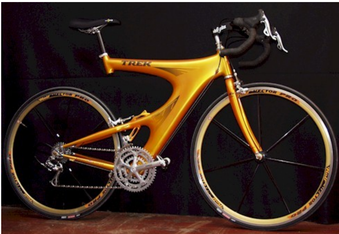
Εικόνα 46. Ποδήλατο αγώνων δρόμου Trek Y Foil, από τα πρώτα ποδήλατα με σκελετό beam. Διακρίνονται τα άνω ψαλιδία και ο σωλήνας για τοποθέτηση ντίζας σέλας.
