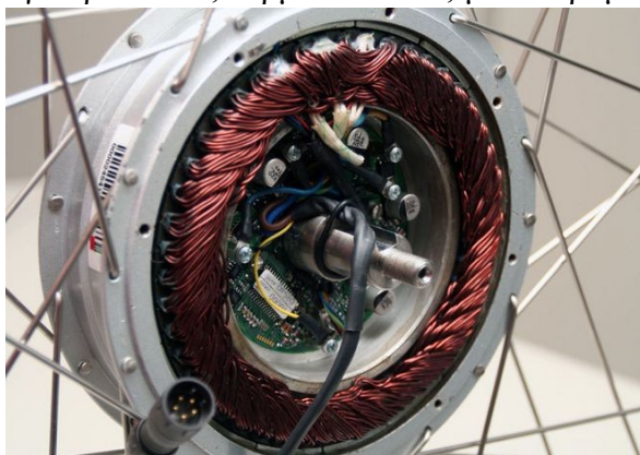
Εικόνα 195. Ηλεκτροκινητήρας ενσωματωμένος στο κέλυφος κινητήριου τροχού.
