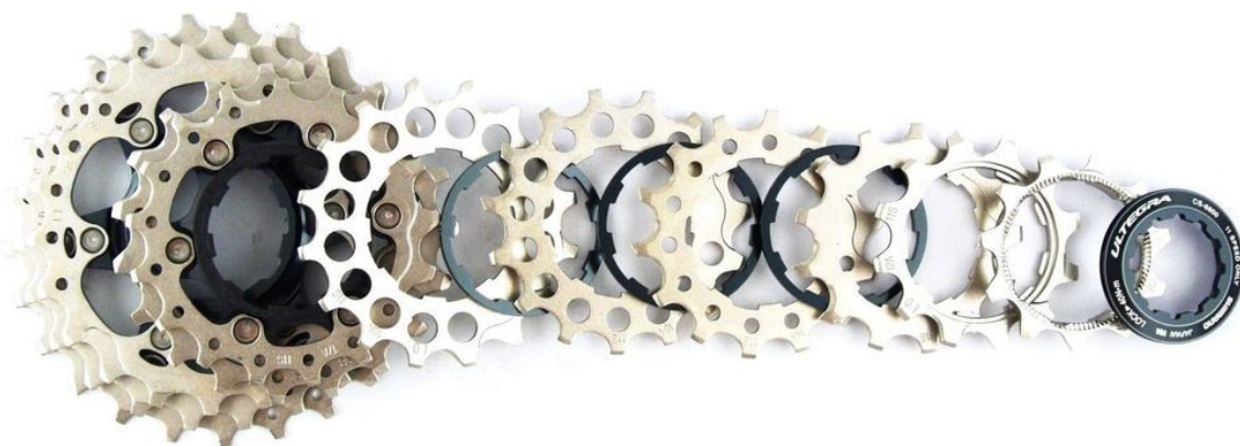
Εικόνα 171. Κασέτα έντεκα οδοντωτών δίσκων σειράς Ultegra, της εταιρίας Shimano.
