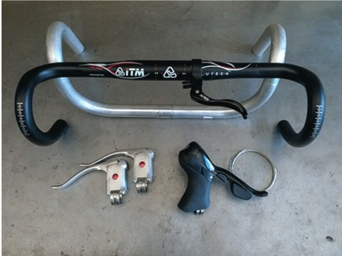
Εικόνα 219. Σε αυτή την εικόνα διακρίνονται τόσο ένα απλό χειριστήριο πέδησης ίσιου τιμονιού, που χρησιμοποιείται στα περισσότερα ποδήλατα, όσο και δύο χειριστήρια ποδηλάτου δρόμου (ανοξείδωτα), τα οποία τοποθετούνται στην καμπυλωτή πλευρά του τιμονιού. Διακρίνεται ωστόσο ακόμα ένα είδος χειριστηρίου πέδησης το οποίο έχει ενσωματωμένο και τον χειρισμό της εναλλαγής σχέσεων μετάδοσης. Στην εικόνα διακρίνεται κάτω δεξιά. Τα εικονιζόμενα χειριστήρια είναι όλα μηχανικά.
