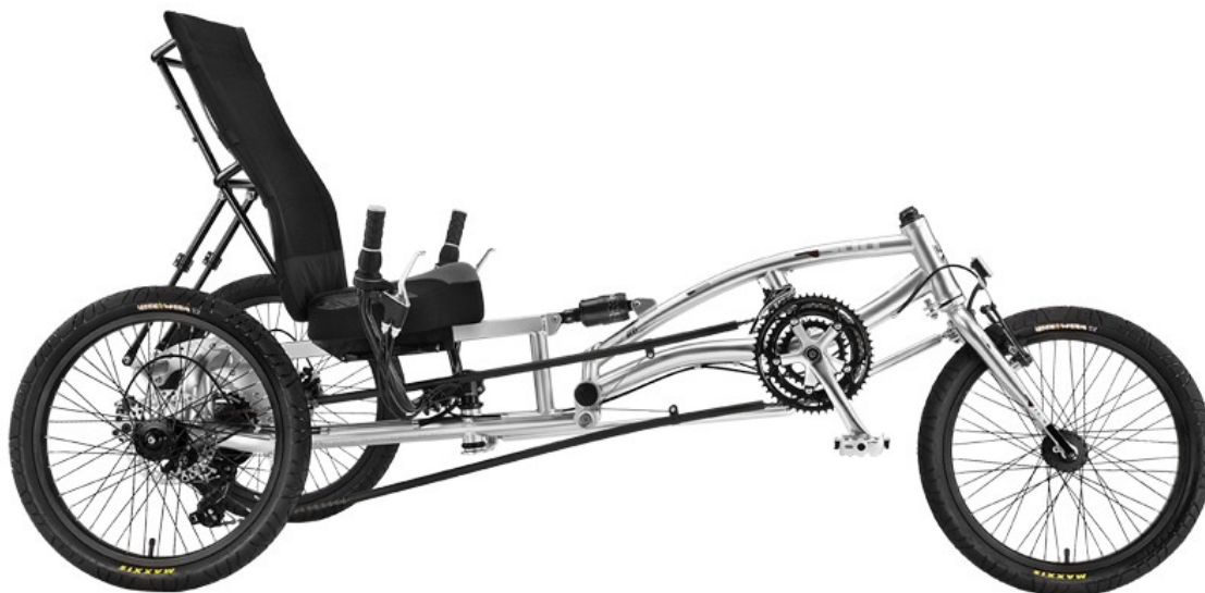
Εικόνα 66. Τρίτροχο ποδήλατο Sun EZ-3 USX, με σκελετό recumbent τύπου delta, μακριού μεταξονίου και διεύθυνση κάτω του καθίσματος.
