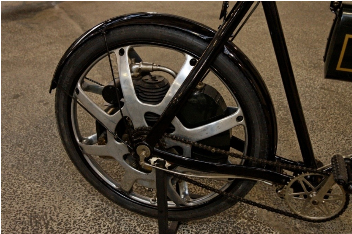
Εικόνα 162. Ποδήλατο Gent's Motor Bicycle με Μ.Ε.Κ. μικρού κυβισμού, στο κέντρο του οπίσθιου τροχού του.
