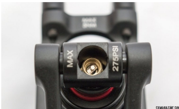
Εικόνα 121. Η αυξομείωση της πίεσης του αέρα γίνεται μέσω βαλβίδας Schrader, με μέγιστο τα 275 psi.
