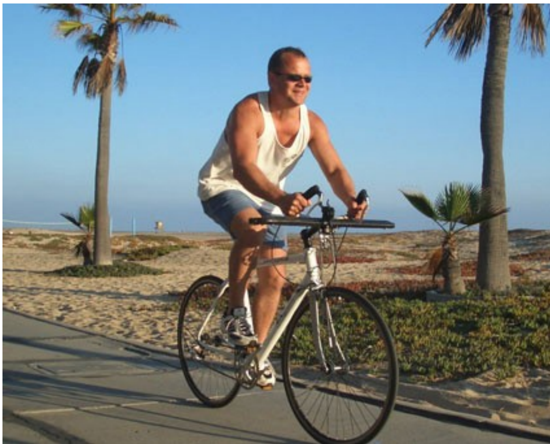
Εικόνα 155. Το ποδήλατο Exycle, που λαμβάνει κινητήρια ισχύς στον πίσω τροχό από τα πόδια του αναβάτη και στον εμπρόσθιο τροχό από τα χέρια.
