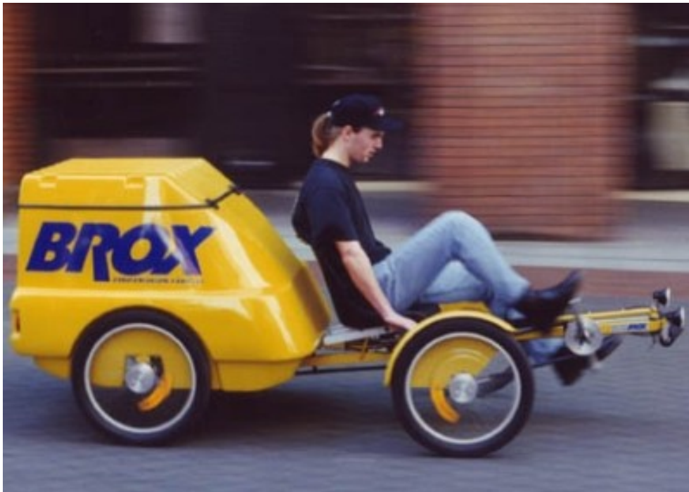
Εικόνα 85. Τετράτροχο ποδήλατο με σκελετό τύπου recumbent, μεταφοράς φορτίων πίσω από τον αναβάτη.
