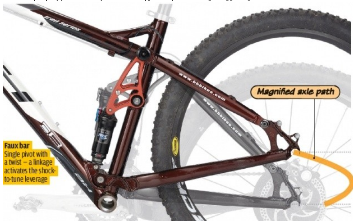
Εικόνα 135. Οπίσθια ανάρτηση μονού πείρου με ζύγωθρο.
