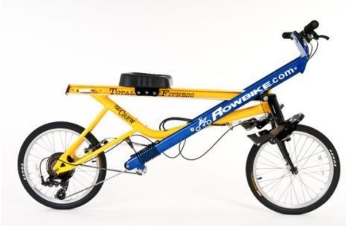
Εικόνα 153. Ποδήλατο Rowbike που εκμεταλλεύεται την κωπηλατική έλξη του αναβάτη για την κίνησή του.
