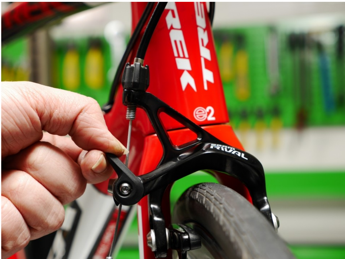
Εικόνα 209. Φρένα caliper μονού άξονα περιστροφής, πλάγιας έλξης, RIVAL της εταιρίας SRAM.
