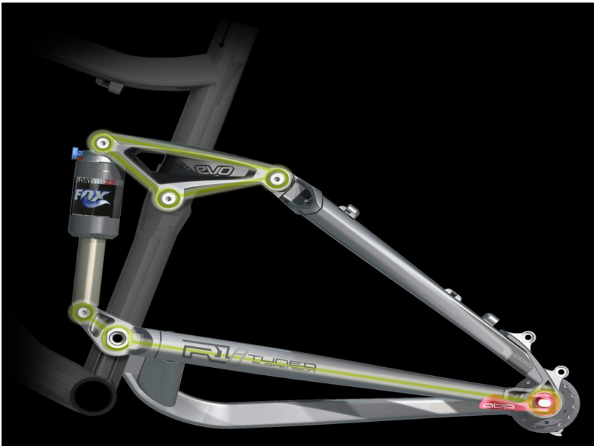
Εικόνα 141. Οπίσθια ανάρτηση τεσσάρων ράβδων Full Floater Active Braking Pivot.
