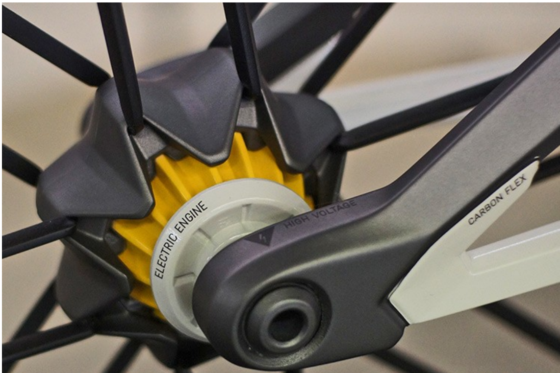
Εικόνα 148. Ο σύνδεσμος CARBON FLEX, του ποδηλάτου Orbiter. Διακρίνεται και ο ηλεκτρικός κινητήρας για την κίνηση του ποδηλάτου.
