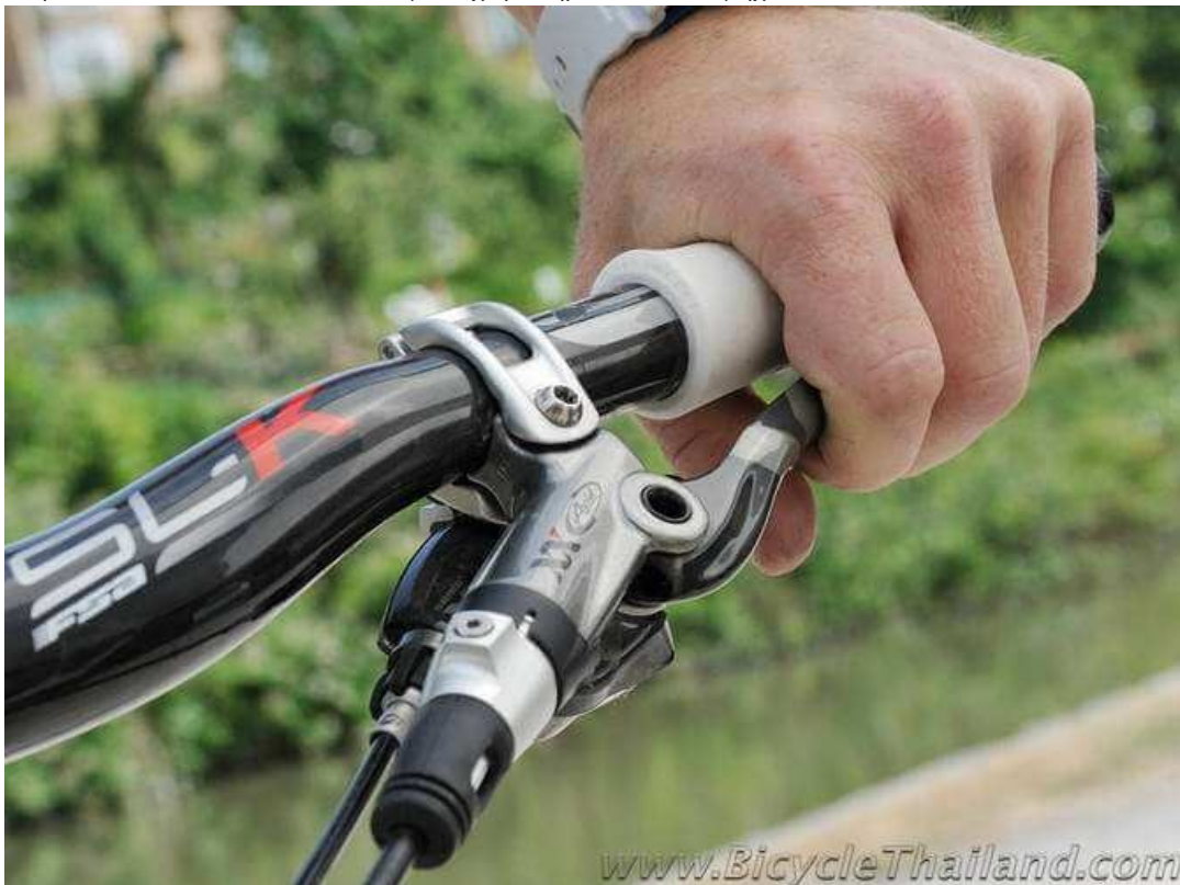
Εικόνα 220. Χειριστήριο υδραυλικού συστήματος πέδησης. Διακρίνεται ο ειδικός σχεδιασμός λόγω της φιλοξενίας υδραυλικού εμβόλου.
