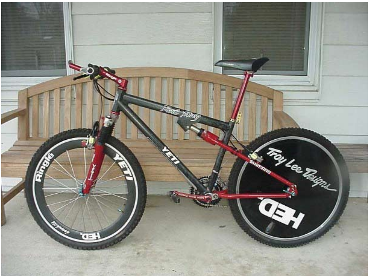
Εικόνα 13. Το ποδήλατο YETI, με σκελετό κατασκευασμένο από θερμοπλαστικά.
