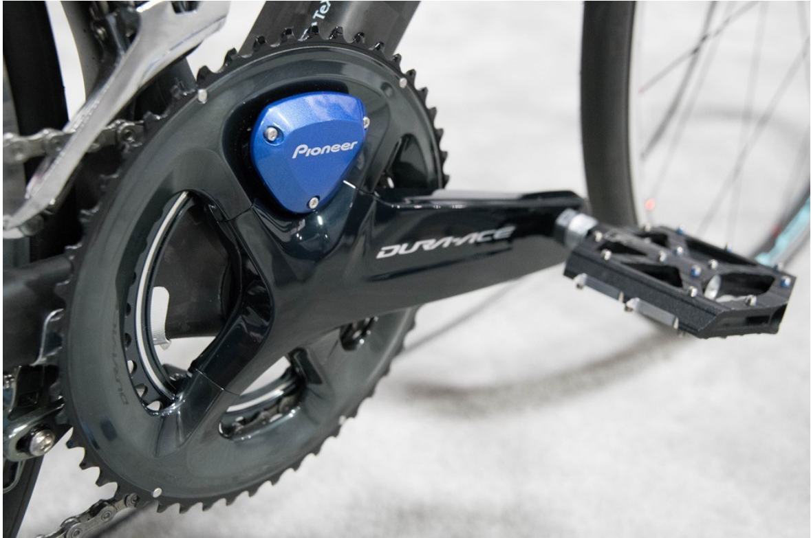
Εικόνα 240. Βατόμετρο δισκοβραχίονα της Pioneer.
