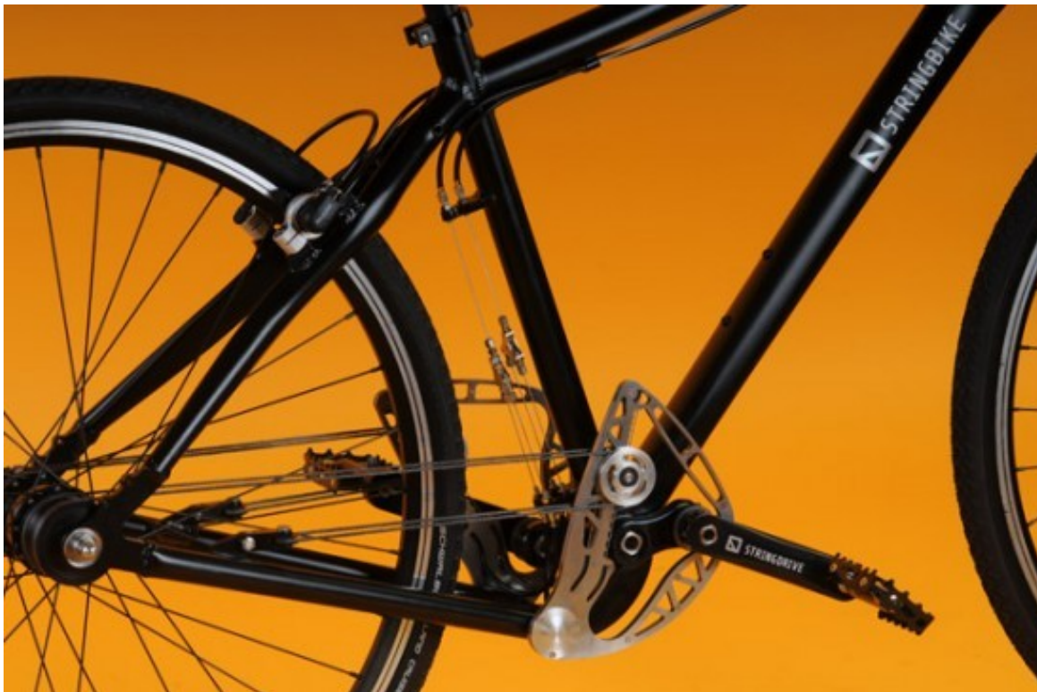
Εικόνα 168. Το ποδήλατο Stringbike, κίνησης μέσω καλωδίων.
