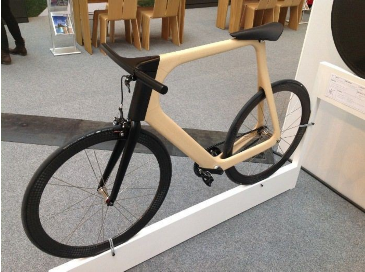
Εικόνα 53. Το ποδήλατο Anrak του στούντιο Keim, με ξύλινο monocoque σκελετό, δίχως κάθετο σωλήνα.
