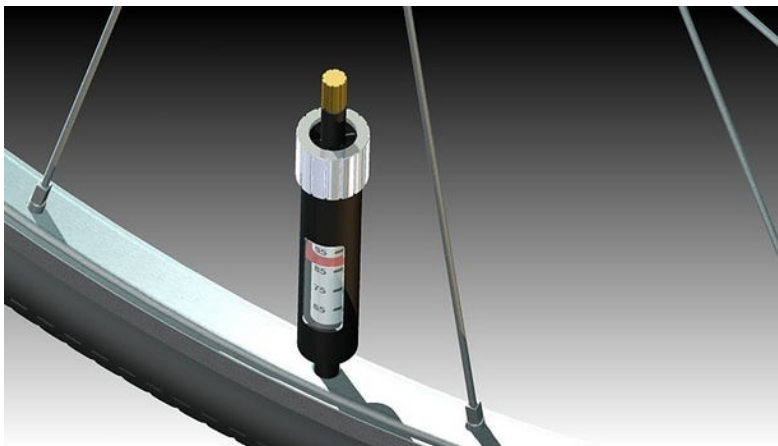
Εικόνα 208. Η ειδική εξωτερική βαλβίδα μονής κατεύθυνσης, του ελαστικού PumpTire.
