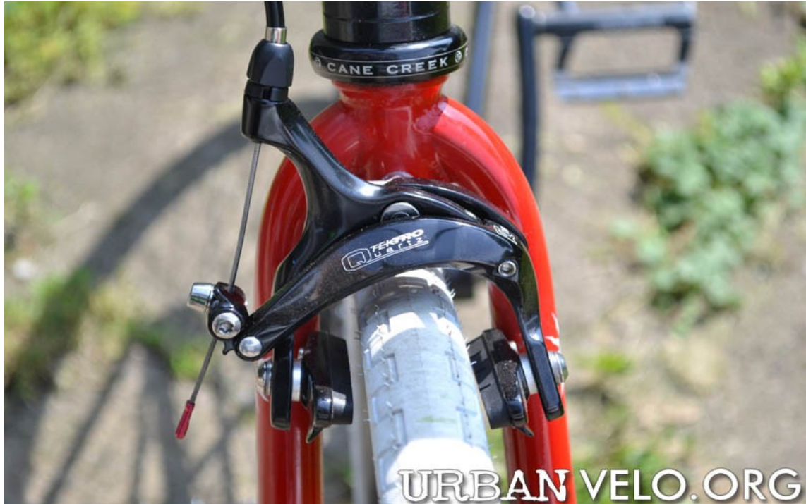
Εικόνα 210. Φρένα caliper διπλού άξονα περιστροφής, πλάγιας έλξης, QUARTZ της εταιρίας TEKTRO.
