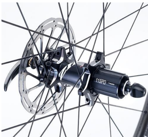
Εικόνα 191. Κέντρο τροχού με υποδοχή για 11 οδοντωτούς δίσκους, καθώς και υποδοχή για έδραση πλάκας δισκοφρένου (διακρίνεται), μάρκας ZIPP. Επίσης διακρίνεται ο μηχανισμός ένωσης με το πιρούνι (μπλοκάζ), ταχείας απελευθέρωσης (quick release).
