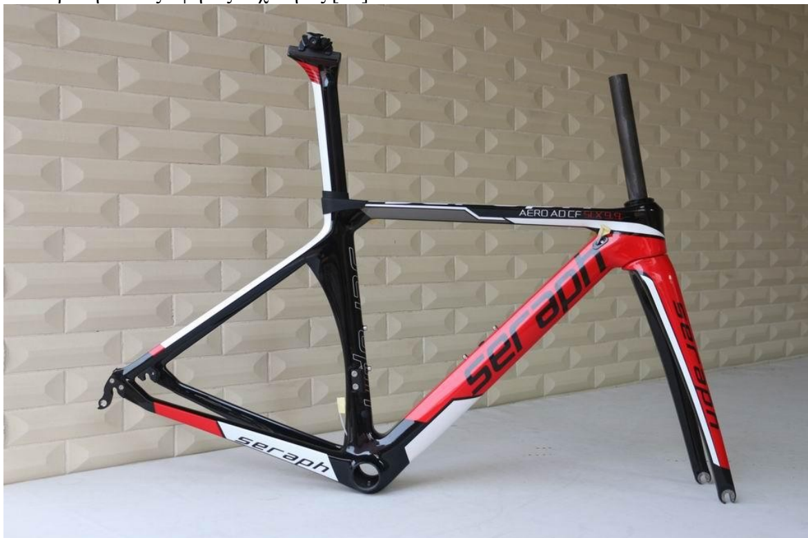
Εικόνα 89. Frameset δρόμου αγώνων ταχύτητας μάρκας Seraph. Χαρακτηριστικός είναι ο αεροδυναμικός σχεδιασμός όλου του συνόλου και ιδιαίτερα του πιρουνιού, που δημιουργεί άρτιο σύνολο χωρίς κενά με τον υπόλοιπο σκελετό.
