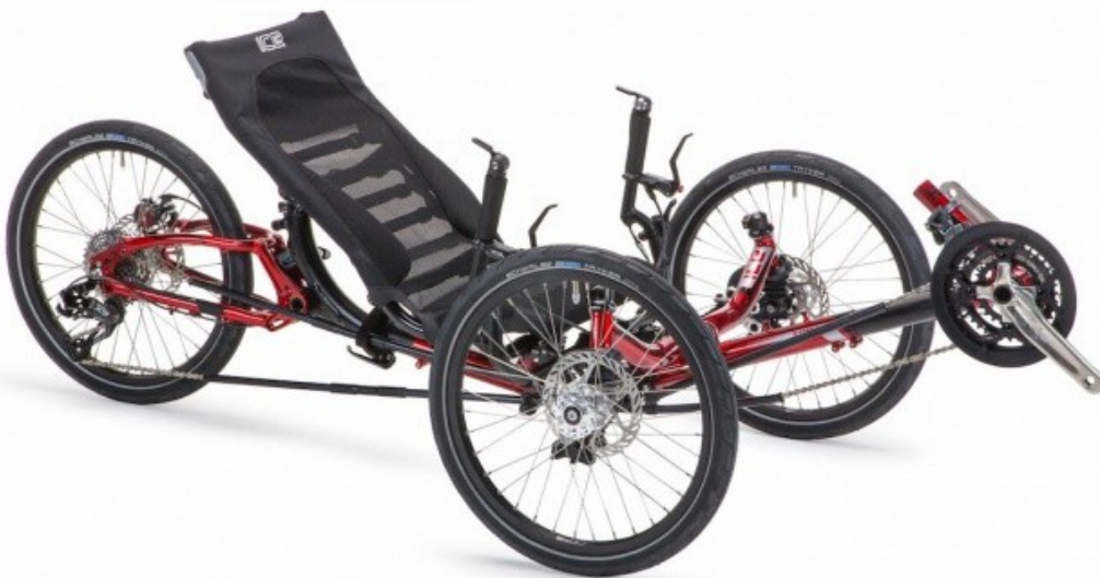
Εικόνα 108. Τρίτροχο ποδήλατο recumbent , διεύθυνσης κάτω του καθίσματος. Στην εικόνα φαίνεται το τιμόνι με κλίση προς τα επάνω.
