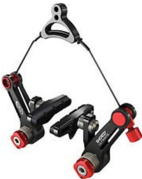
Εικόνα 212. Σύστημα φρένου τύπου cantilever κεντρικής έλξης.
