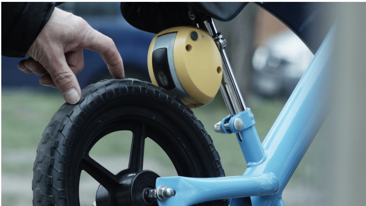
Εικόνα 227. Το πρωτότυπο ασύρματα ελεγχόμενο σύστημα προληπτικής πέδησης, της εταιρίας MINIBRAKE.
