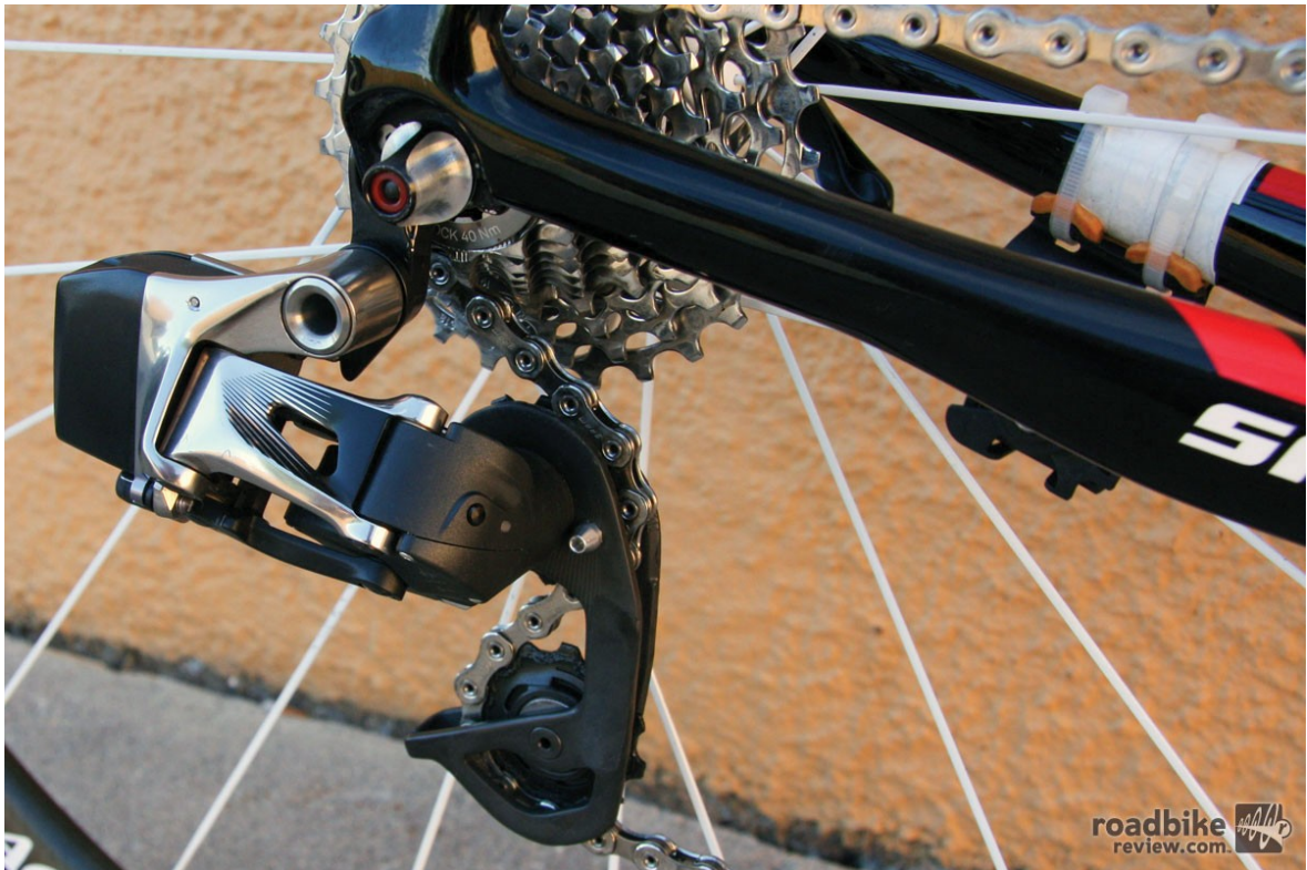
Εικόνα 180. Ασύρματος οπίσθιος εκτροχιαστής της εταιρίας SRAM.
