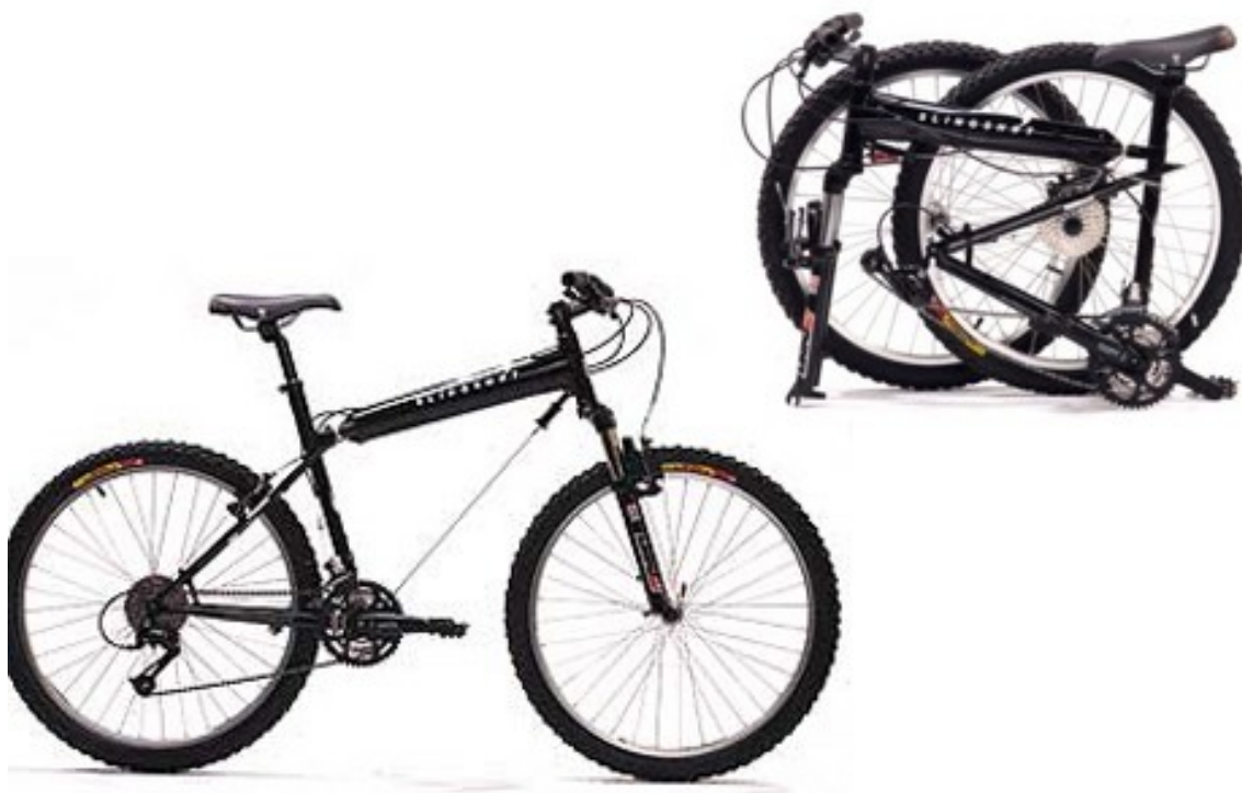
Εικόνα 54. Ποδήλατο εκτός δρόμου της εταιρείας Slingshot, σειράς fold-tech. Διακρίνονται τα καλώδια που αντικαθιστούν τον κάτω σωλήνα.
