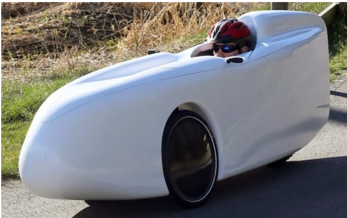
Εικόνα 68. Τρίτροχο ποδήλατο velomobile με σκελετό recumbent τύπου tadpole και full fairing.
