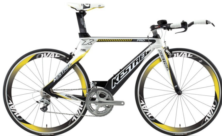
Εικόνα 50. Ποδήλατο αγώνων δρόμου Kestrel Airfoil δίχως κάθετο σωλήνα, κατασκευασμένο από πολυμερή ενισχυμένα με ανθρακονήματα.
