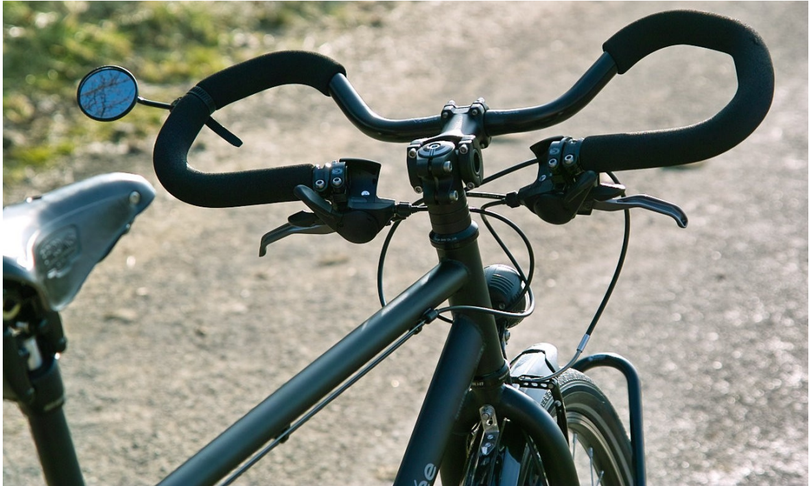
Εικόνα 100. Τιμόνι trekking. Διακρίνεται επίσης ο λαιμός τιμονιού, ο οποίος είναι με ρυθμιζόμενη κλίση.
