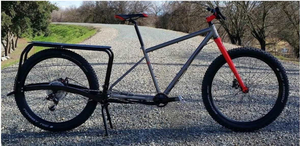
Εικόνα 82 Το υποπλαίσιο μεταφοράς φορτίων LEAP της Xtracycle, συζευγμένο με ένα ποδήλατο "δότη".
