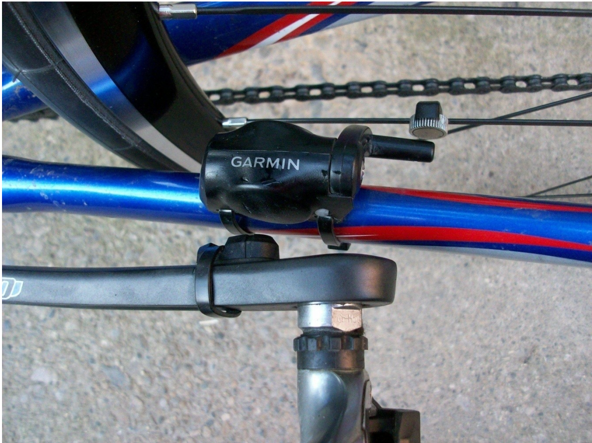
Εικόνα 239. Αισθητήρας μέτρησης τόσο ταχύτητας ποδηλάτου από μαγνήτη σε ακτίνα, όσο και ταχύτητας περιστροφής δισκοβραχίονα, από μαγνήτη στο βραχίονα του πετάλ, της GARMIN.
