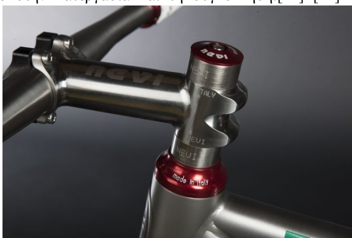
Εικόνα 8. Λεπτομέρεια ποδηλάτου με σκελετό από τιτάνιο, όπου φαίνονται και το τιμόνι με τον λαιμό, επίσης από τιτάνιο, μάρκας NEVI.
