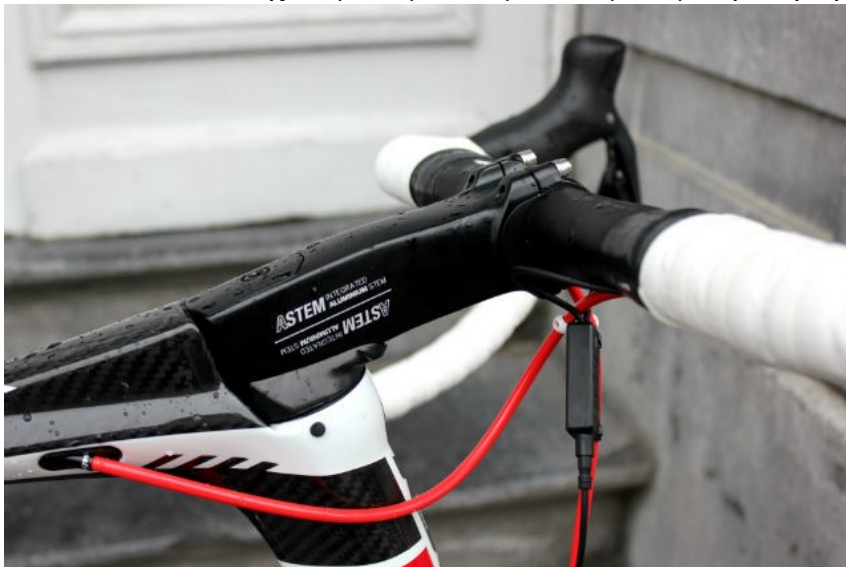
Εικόνα 97. Λαιμός ποδηλάτου τύπου integrated, άρτια ενσωματωμένος στον σκελετό.
