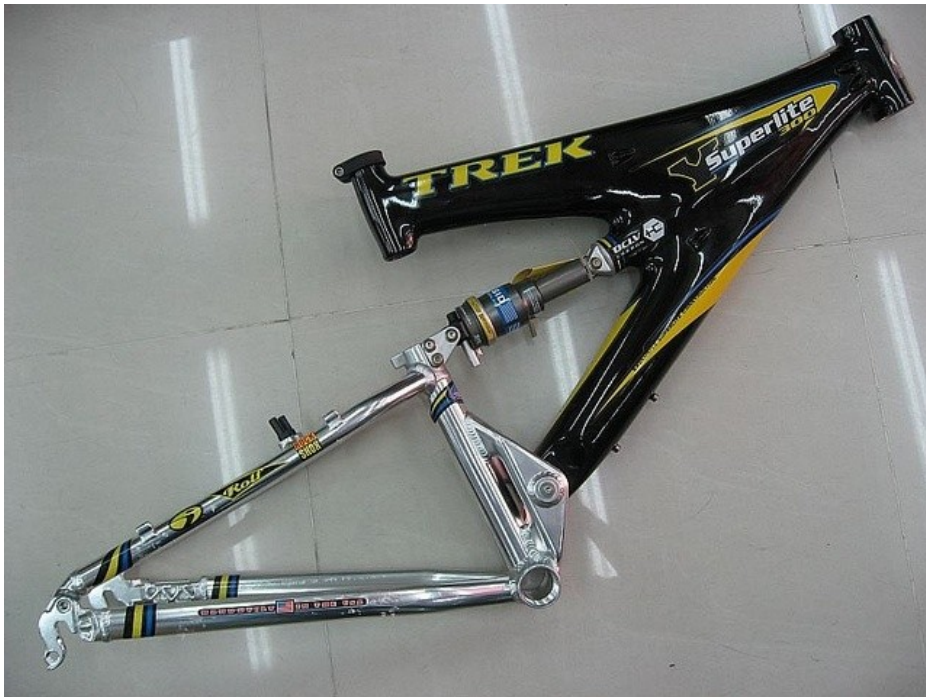
Εικόνα 142. Οπίσθια ανάρτηση με σύστημα Floating Drivetrain, Ενιαίου Οπίσθιου Τριγώνου, σε σκελετό Trek.
