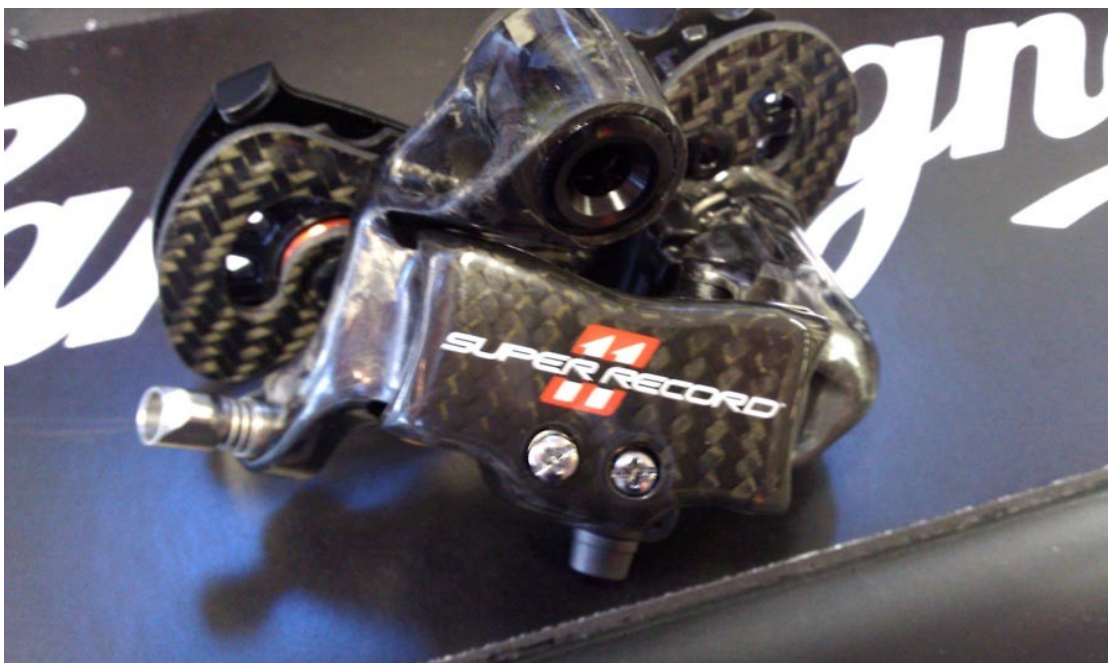
Εικόνα 12. Οπίσθιος εκτροχιαστής μοντέλου SUPER RECORD 11, μάρκας CAMPAGNOLO, κατασκευασμένο από πολυμερή ενισχυμένα με ανθρακονήματα.
