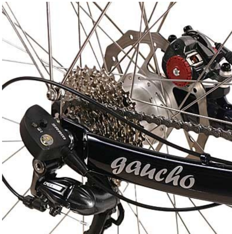
Εικόνα 185. Σύστημα SRAM Dual Drive, εσωτερικών ταχυτήτων, συζευγμένο με πολλαπλούς οδοντωτούς δίσκους και εκτροχιαστή. Διακρίνεται τόσο το καλώδιο έλεγχου του εκτροχιαστή, όσο και του εσωτερικού συστήματος αλλαγής σχέσης μετάδοσης.
