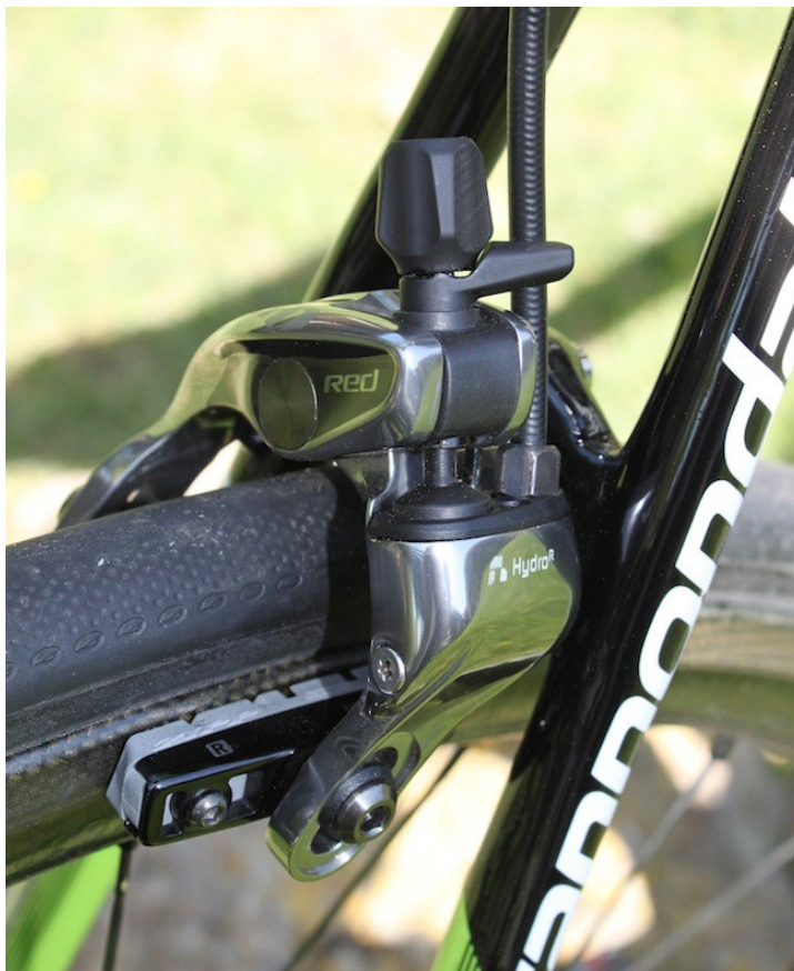
Εικόνα 215. Υδραυλικό σύστημα πέδησης στεφάνης, σύνδεσης μονού σημείου, σειράς RED της εταιρίας SRAM. Διακρίνεται το υδραυλικό έμβολο, που επενεργεί στους βραχιόνες πέδησης.
