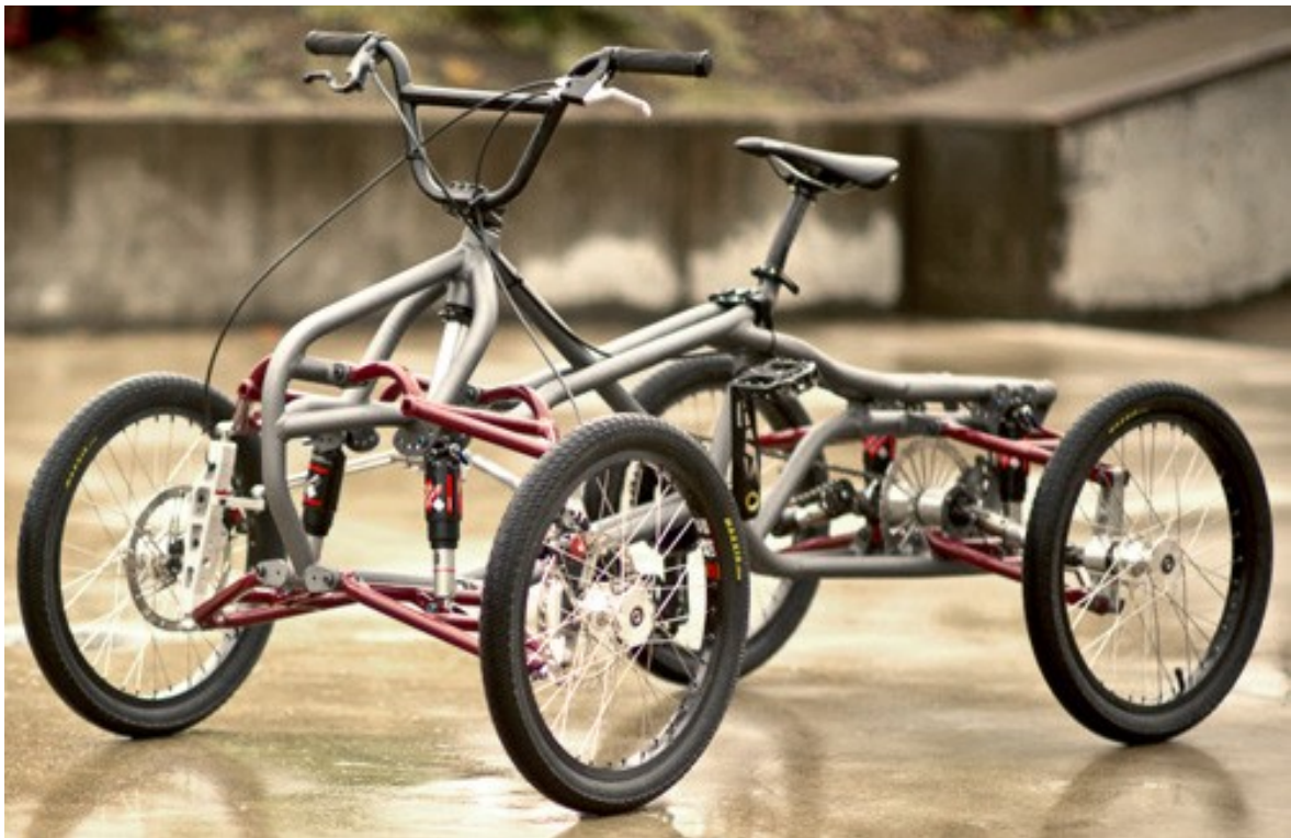
Εικόνα 149. Το τετράτροχο ποδήλατο Athos της Contes Engineering, με μηχανισμό ανεξάρτητων αναρτήσεων διπλών ψαλιδιών.
