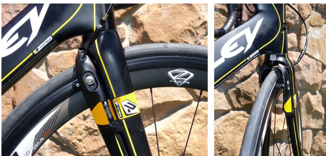
Εικόνα 89. Frameset δρόμου αγώνων ταχύτητας μάρκας Seraph. Χαρακτηριστικός είναι ο αεροδυναμικός σχεδιασμός όλου του συνόλου και ιδιαίτερα του πιρουνιού, που δημιουργεί άρτιο σύνολο χωρίς κενά με τον υπόλοιπο σκελετό.
