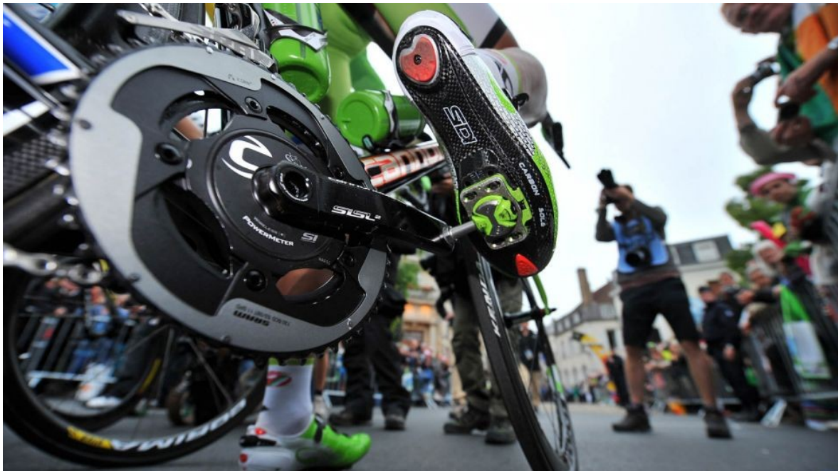
Εικόνα 174. Κομπωτά πετάλια σε ποδήλατο δρόμου. Διακρίνονται οι υποδοχές - σχαράκια με τις οποίες ενώνονται, που είναι τοποθετημένες στα υποδήματα του αναβάτη.
