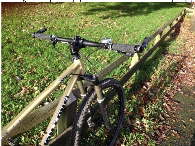
Εικόνα 99. Ίσιο τιμόνι με bar ends στις άκρες του.
