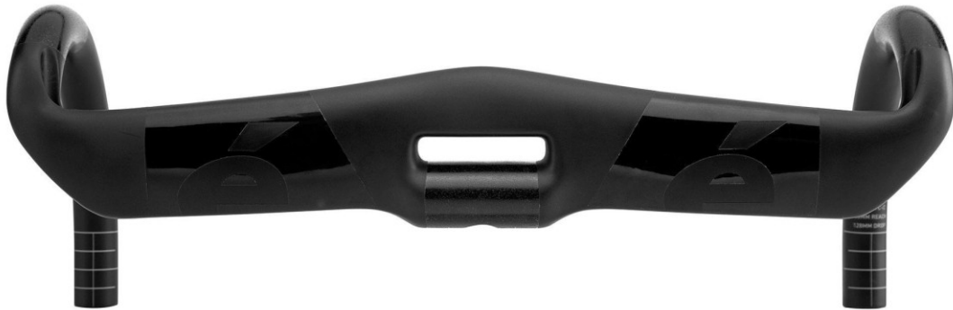
Εικόνα 102. Τιμόνι ποδηλάτου δρόμου - αγώνων ταχύτητας, μάρκας Cervelo. Είναι κατασκευασμένο από πολυμερή ενισχυμένα με ανθρακονήματα και είναι χαρακτηριστικός ο αεροδυναμικός σχεδιασμός του, σαν πτερύγιο.
