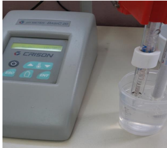
Εικόνα 8. Συσκευή εκχύλισης πάστας κορεσμού και συσκευή μέτρησης pH & EC.
