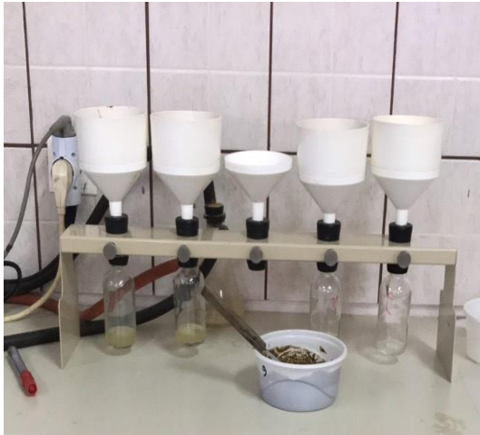
Εικόνα 8. Συσκευή εκχύλισης πάστας κορεσμού και συσκευή μέτρησης pH & EC.
