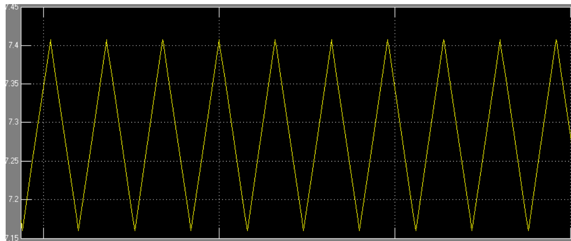
Σχήμα 28: Κυματομορφή ρεύματος εξόδου, f=62.5 kHz
