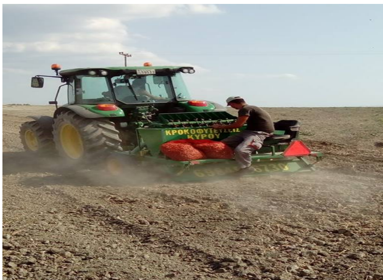
Εικόνα 1.2. Φύτευση κρόκου με σύγχρονη φυτευτική μηχανή.
