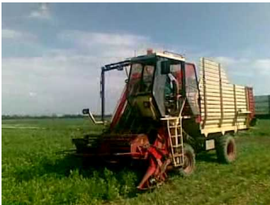
Εικ 2. Θεριστική-κοπτική μηχανή με μαχαίρια.
