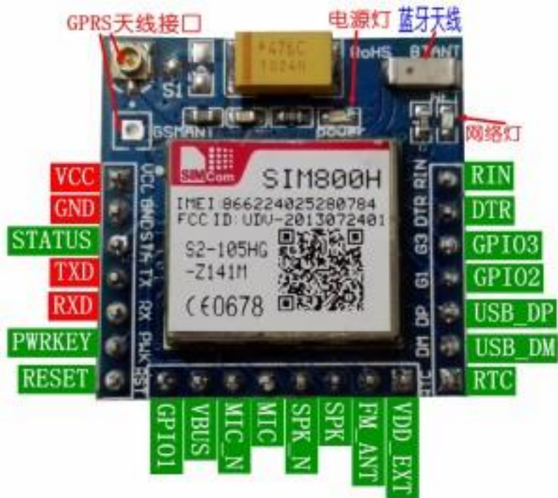
Εικόνα 1-13 Διάγραμμα ακροδεκτών του SIM800
