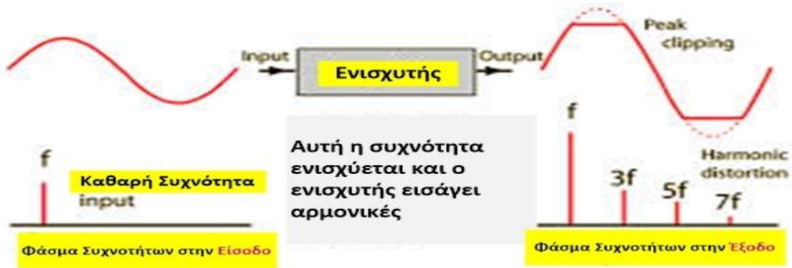
Εικόνα 4.1: Απεικόνιση της εξόδου του ενισχυτή και του παραμορφωμένου σήματος, σε σχέση με την είσοδο του.
