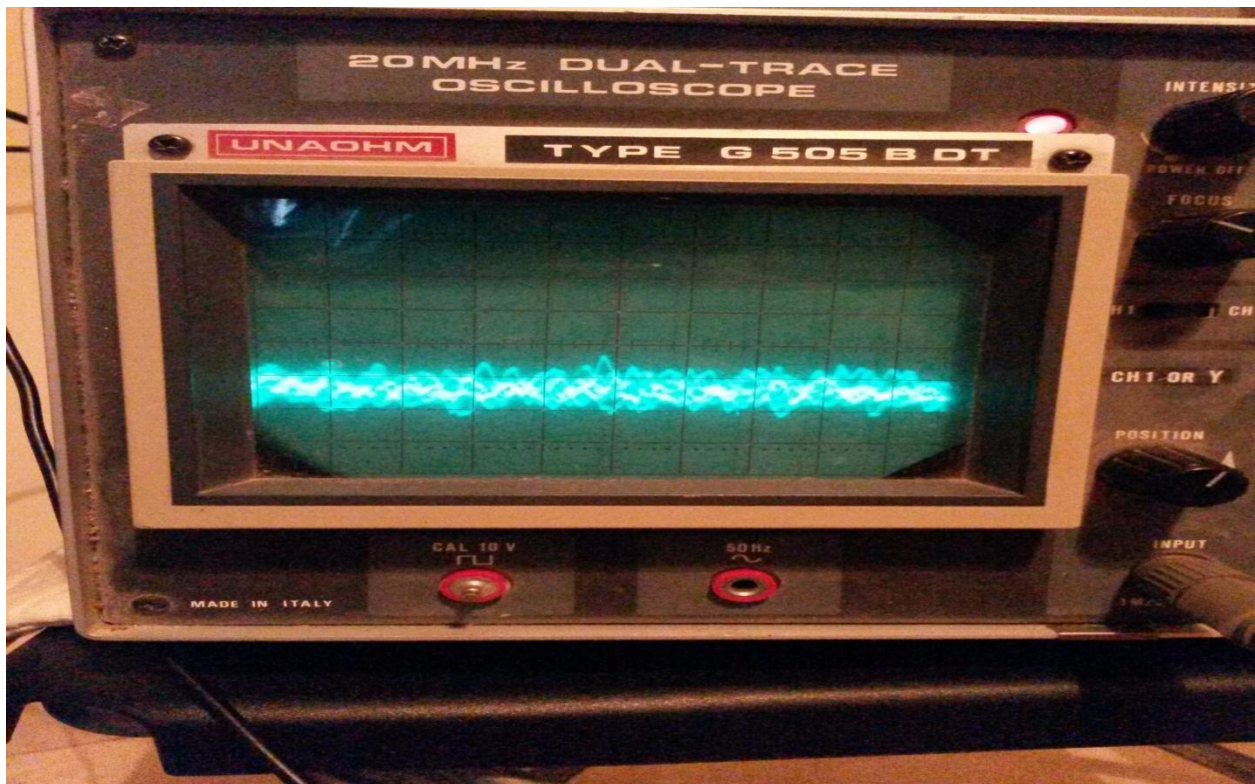
Εικόνα 5.6: Ο θόρυβος του ενισχυτή, όπως φαίνεται από μέτρηση στον παλμογράφο.
