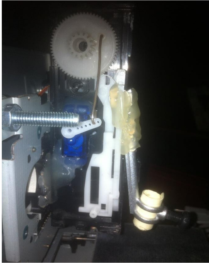
Εικ. 2.7 Το εξάρτημα επαφής στερεωμένο πάνω στον άξονα Χ
