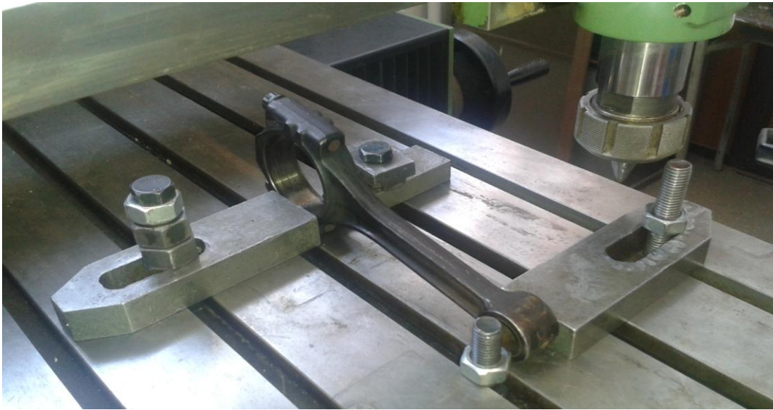
Εικόνα 5.6.1: Αρχικό δοκίμιο διωστήρα σε πλάγια άψη
