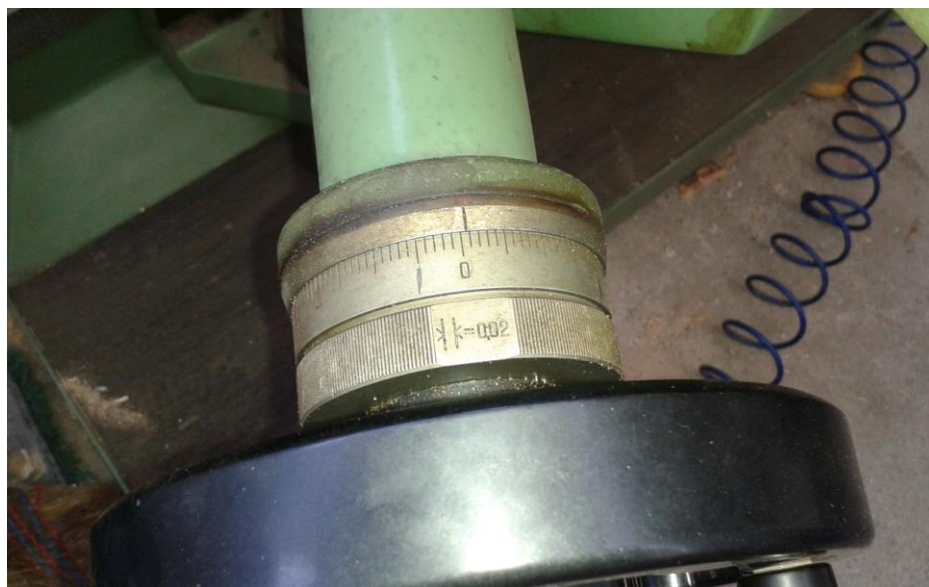
Εικόνα 4.2.3: Μοχλός που αυξομειώνει κάθετα την τράπεζα
