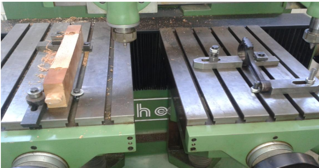
Εικόνα 5.6.2: Προετοιμασία αντιγραφής του διωστήρα σε πλάγια άψη
