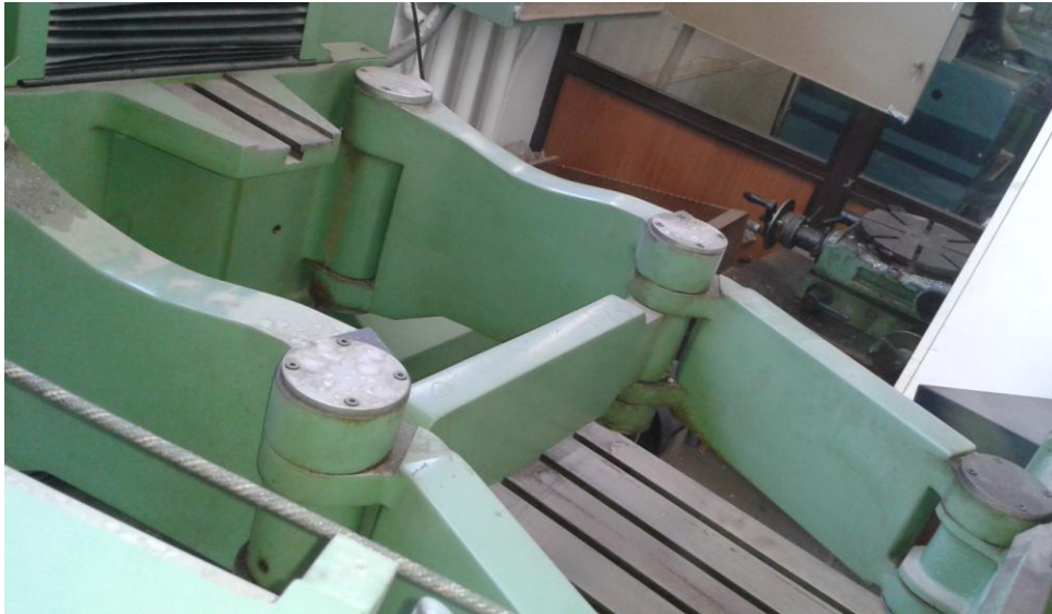
Εικόνα 4.2.12:Μοχλοβραχίονες ταυτόχρονης κίνησης κονδυλίου και ακίδας
