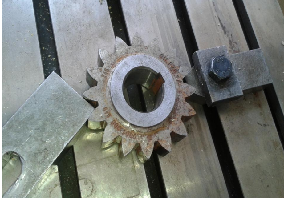
Εικόνα 5.4.1: Αρχικό δοκίμιο γραναζιού
