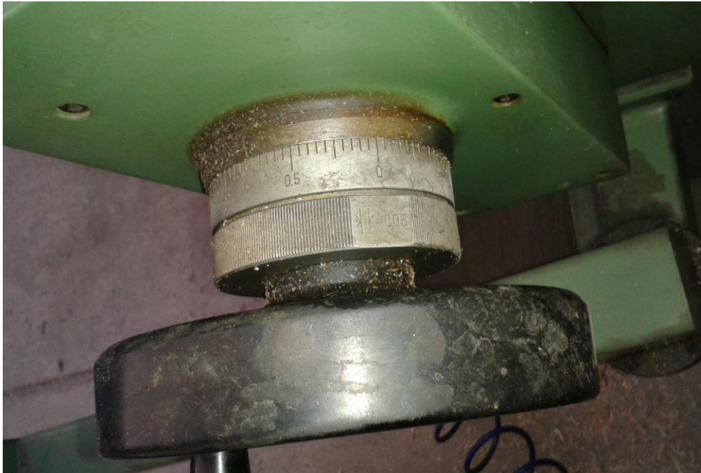
Εικόνα 4.2.4: Μοχλός που ωθεί την τράπεζα από αριστερά προς τα δεξιά και το ανάποδο
