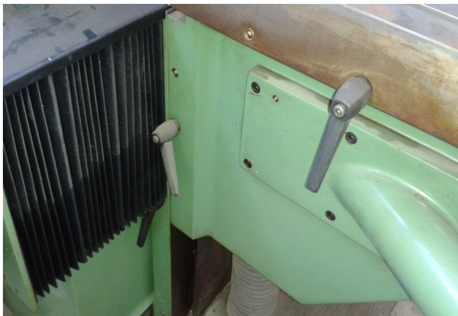
Εικόνα 4.2.2: Απεικόνιση μοχλών για τη θωράκιση της τράπεζας
