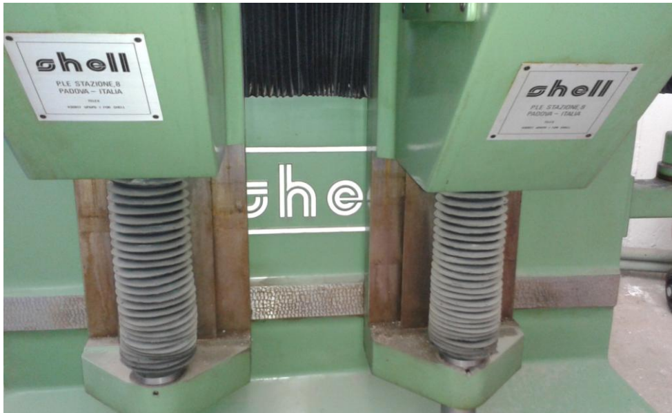
Εικόνα 4.2.9: Κάτοψη παντογράφου αποτελούμενη εσωτερικά από ατέρμονα κοχλία στην καθεμία τράπεζα
