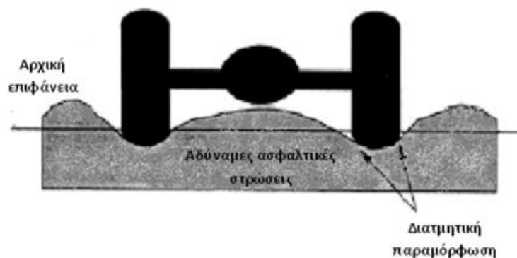
Εικόνα 2.4 Τροχοαυλάκωση λόγω αδύναμων ασφαλτικών στρώσεων (Garba, 2002)
