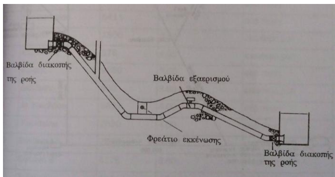
Σχ. 6.4. Υπό πίεση αγωγός μεταφοράς νερού.
