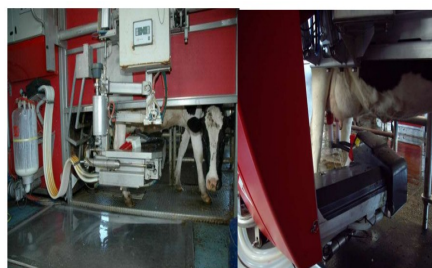
Εικόνα 4. Αυτόματη αμελκτική μηχανή (Robot milking).
