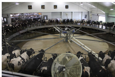
Εικόνα 7. Κυκλικό αμελκτήριο (Τύπος Rotary).
