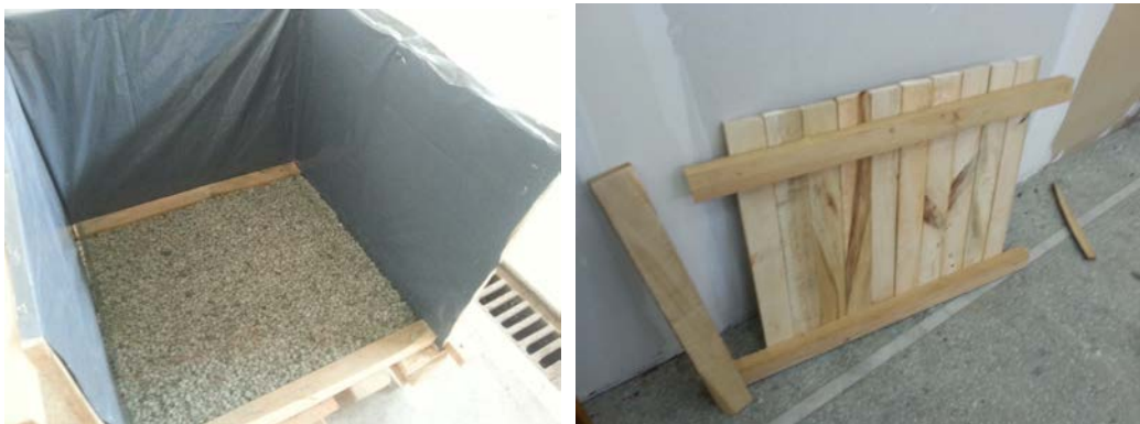
Εικόνα 5. Αποσπώμενη πλευρά του μοντέλου άμμου
