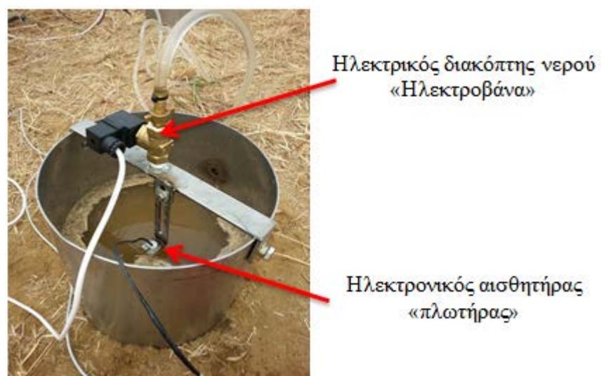
Εικόνα 16. Διηθητόμετρο σε λειτουργία
