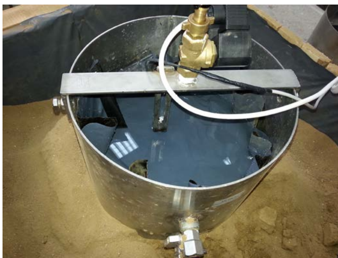
Εικόνα 2. Τοποθέτηση πλαστικής μεμβράνης μέσα στο διηθητόμετρο
