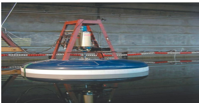
Εικόνα 22 : Ο Μετατροπέας Σημειακής Απορρόφησης Κυματικής Ενέργειας (Ζαφειρίου 2012)
