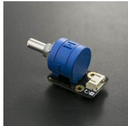
Το πολυστροφικό ποτενσιόμετρο που χρησιμοποιήθηκε σαν αισθητήρας θέσης εξόδου
