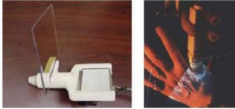
Εικόνα 9. Φορητές συσκευές απεικόνισης optical see-through hand-held (Krevelen & Poelman, 2010)
