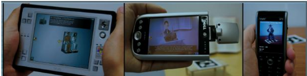
Εικόνα 10. Φορητές συσκευές απεικόνισης video see-through hand-held (Schmalstieg, et al., 2007)
