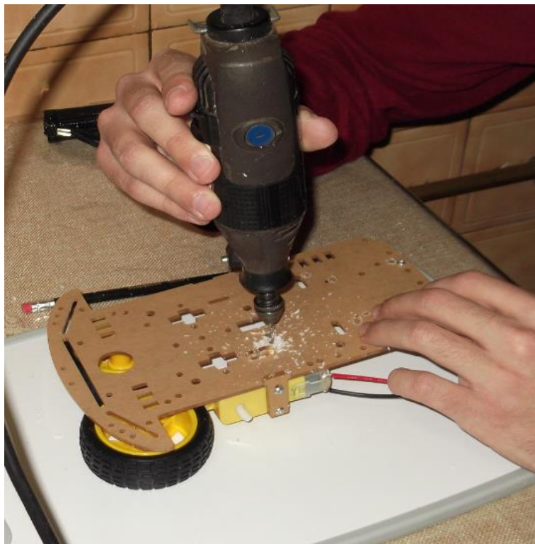
Εικόνα 3.3.3 Άνοιγμα οπών στο ρομποτικό σασί με την βοήθεια Dremel.
