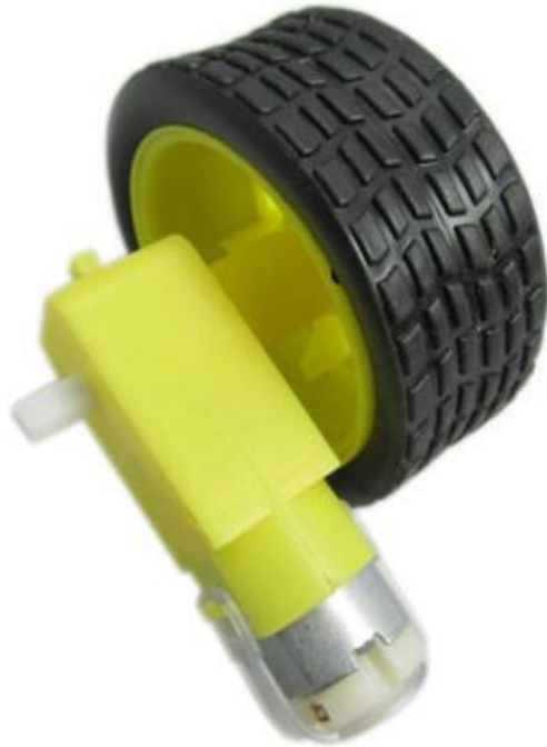
Εικόνα 3.3.2 Κινητήρας μαζί με τον τροχό του ρομποτικού οχήματος.
