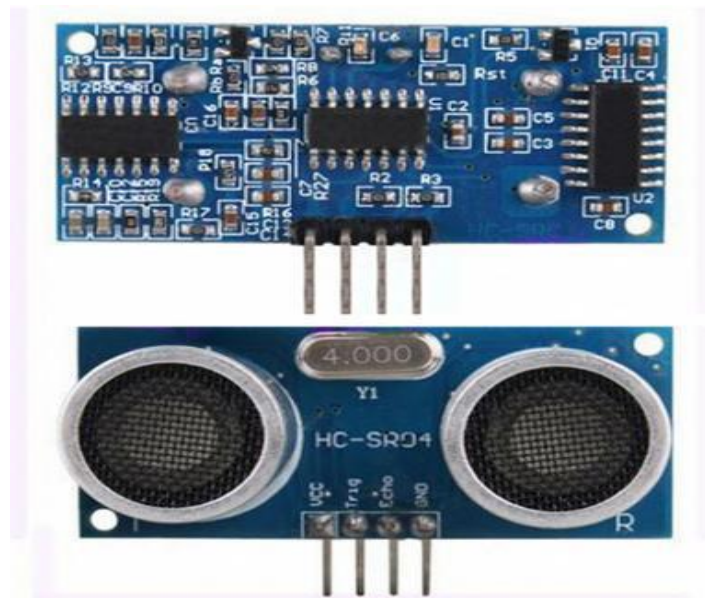
Εικόνα 2.3.4 Αισθητήρας υπερήχων HC-SR04 με διαστάσεις (45*20*15mm).
