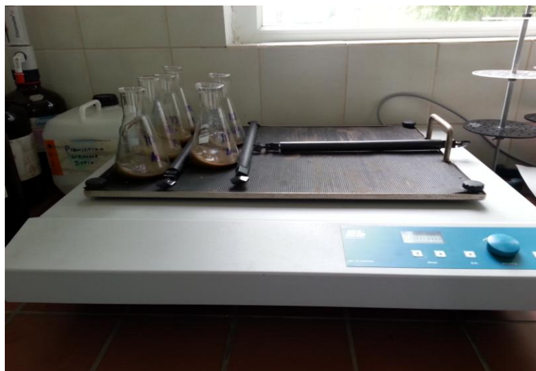
Φωτογραφία 2.13. Συσκευή για την ανακίνηση των δειγμάτων (Edmund Buhler GmbH SM-30 CONTROL)
