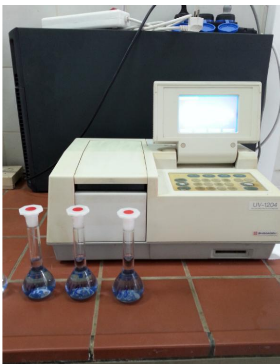
Φωτογραφία 2.12. Μέτρηση του αφομοιώσιμου φωσφόρου (P) στο φασματοφωτόμετρο (SHIMADZU UV-1204 UV-VIS Spectrophotometer)
