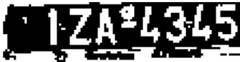
Εικόνα 58: Φωτογραφία πινακίδας μετά την εφαρμογή προσαρμοσμένου κατωφλιού (adaptive thresholding)
