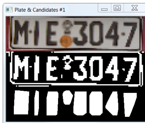
Εικόνα 37: Κατάτμηση χαρακτήρων τους οποίους θα στείλουμε στον ταξινομητή μας (classifier) για αναγνώριση
