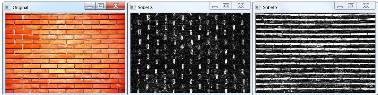
Εικόνα 27: Αποτελέσματα εφαρμογής πυρήνων Sobel. Αρχική εικόνα (αριστερά), Πυρήνας Gx (μέση), Πυρήνας Gy (δεξιά)
