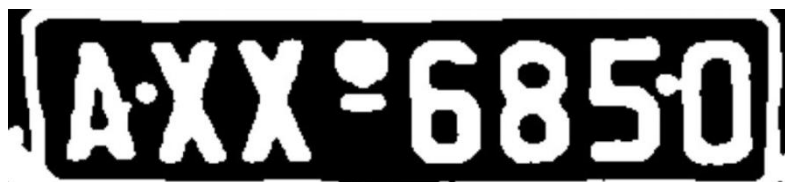
Εικόνα 59: Φωτογραφία πινακίδας μετά την εφαρμογή αυτόματου κατωφλιού (Otsu thresholding)
