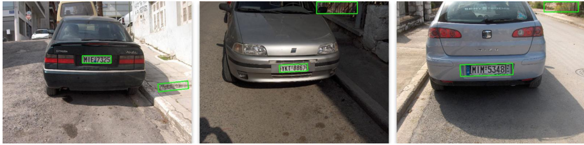
Εικόνα 56: Παράδειγμα εντοπισμού πινακίδας κυκλοφορίας και θορύβου
