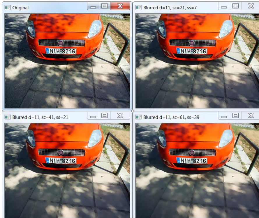
Εικόνα 20: Διμερές φιλτράρισμα με τιμές (d=11, \sigma_{color}=21, \sigma_{spasce}=7) , (d=11, \sigma_{color}=41, \sigma_{spasce}=21) , (d=11, \sigma_{color}=61, \sigma_{spasce}=39)
