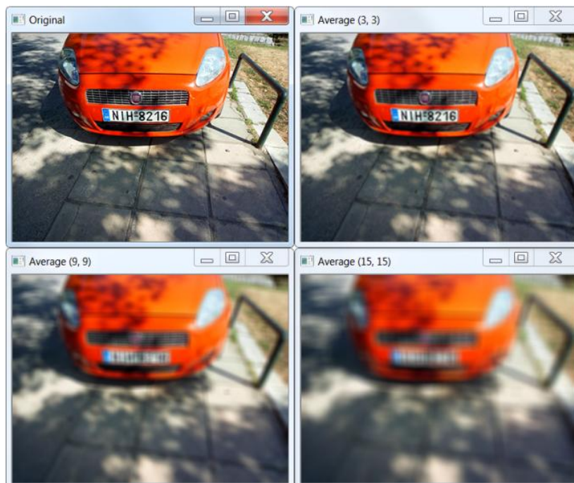
Εικόνα 17: Θόλωμα μέσου όρου με πυρήνες 3x3, 9x9 και 15x15
