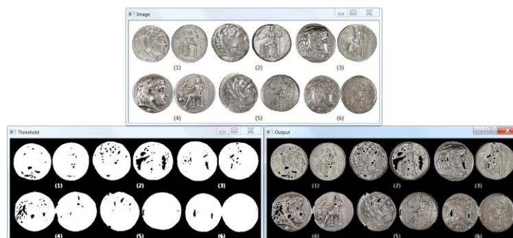
Εικόνα 25: Εφαρμογή αυτόματου κατωφλιού μέσω της μεθόδου Otsu. Η τιμή που υπολογίστηκε είναι T=199
