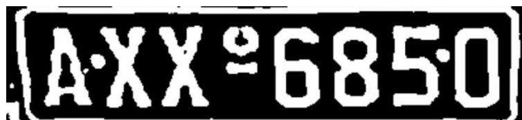
Εικόνα 60: Φωτογραφία πινακίδας μετά την εφαρμογή προσαρμοσμένου κατωφλιού (adaptive thresholding)
