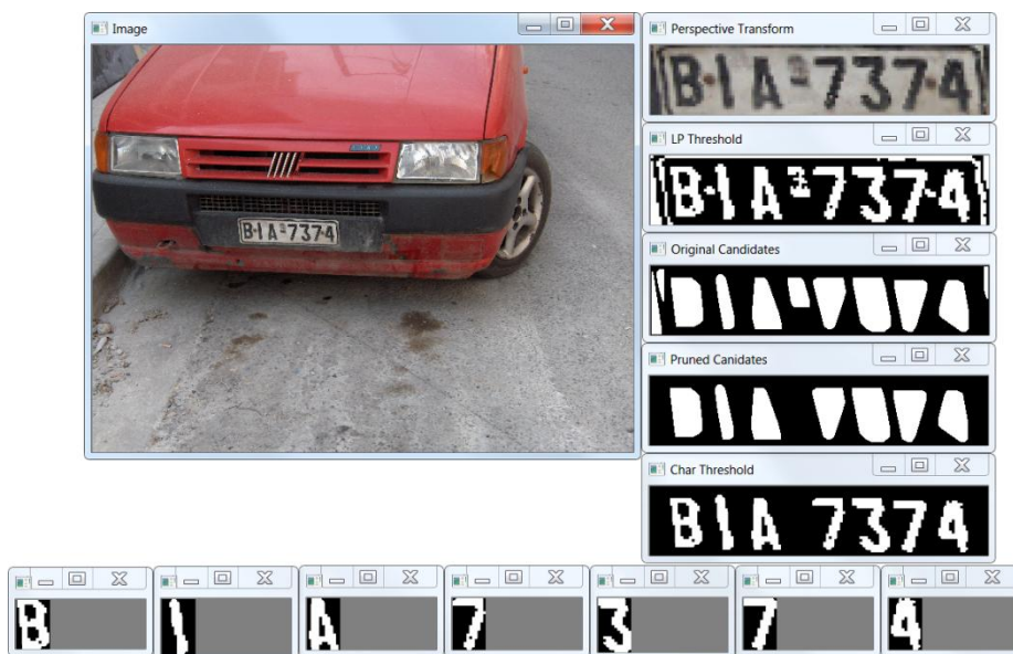
Εικόνα 70: Επιτυχής εξαγωγή χαρακτήρων μετά την αφαίρεση θορύβου και την εφαρμογή της ευρετικής συνάρτησης
