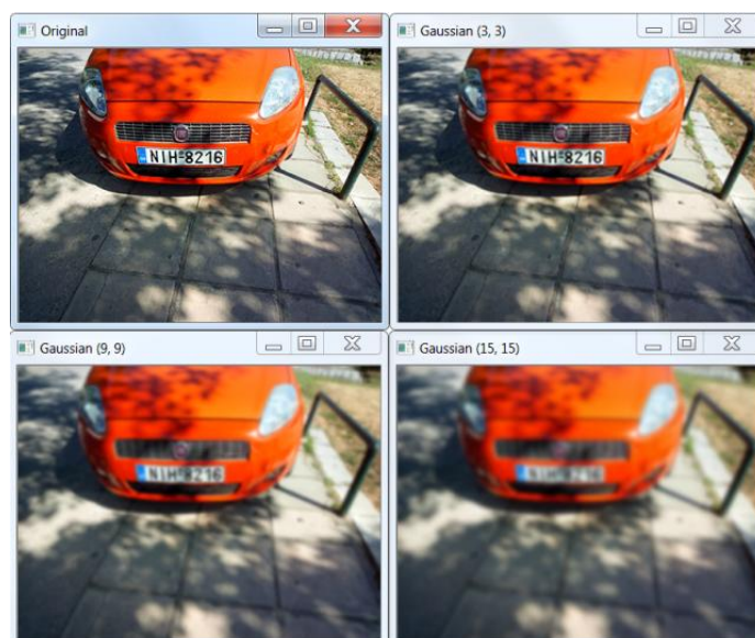
Εικόνα 18: Γκαουσιανό θόλωμα με πυρήνες 3x3, 9x9 και 15x15
