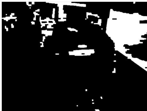
Εικόνα 51: Φωτογραφία για εντοπισμό της πινακίδας, μετά την εφαρμογή διαδοχικών διαβρώσεων (erosions) και διαστολών (dilations)
