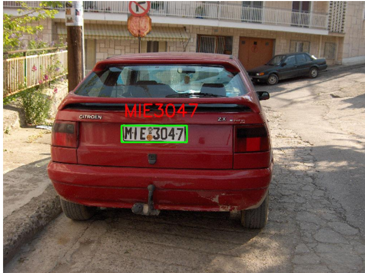
Εικόνα 39: Τελικό αποτέλεσμα του συστήματος ΑΑΠΚ όπου η πινακίδα αναγνωρίστηκε με επιτυχία
