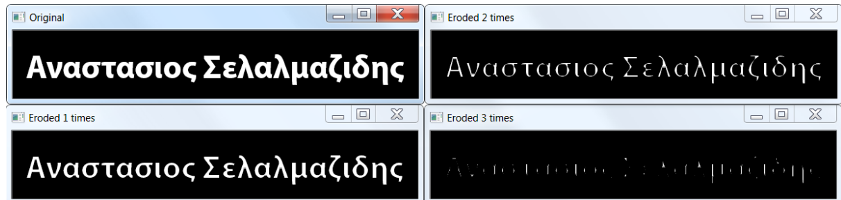
Εικόνα 9: Μορφολογική πράξη διάβρωσης μετά από 1,2 και 3 επαναλήψεις με δομικό στοιχείο 3 \times 3 , 8 γειτονικών σημείων
