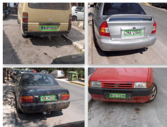
Εικόνα 55: Επιτυχές παράδειγμα εντοπισμού πινακίδας κυκλοφορίας
