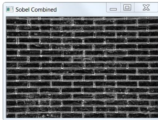
Εικόνα 28: Συνδυασμός αποτελεσμάτων του πυρήνα Sobel
