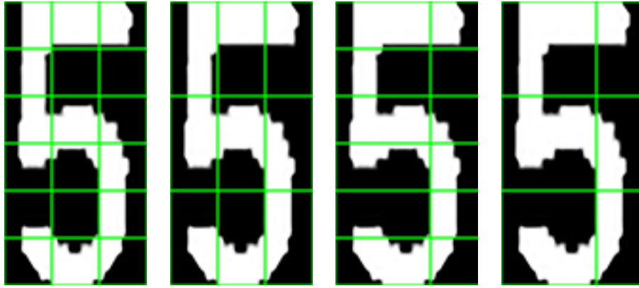
Εικόνα 74: Εφαρμογή αλγορίθμου Block binary Pixel Sum (BBPS) σε χαρακτήρα πινακίδας μεγέθους 30x15 και περιοχές 5x5, 5x10, 10x5 και 10x10 πίξελ
